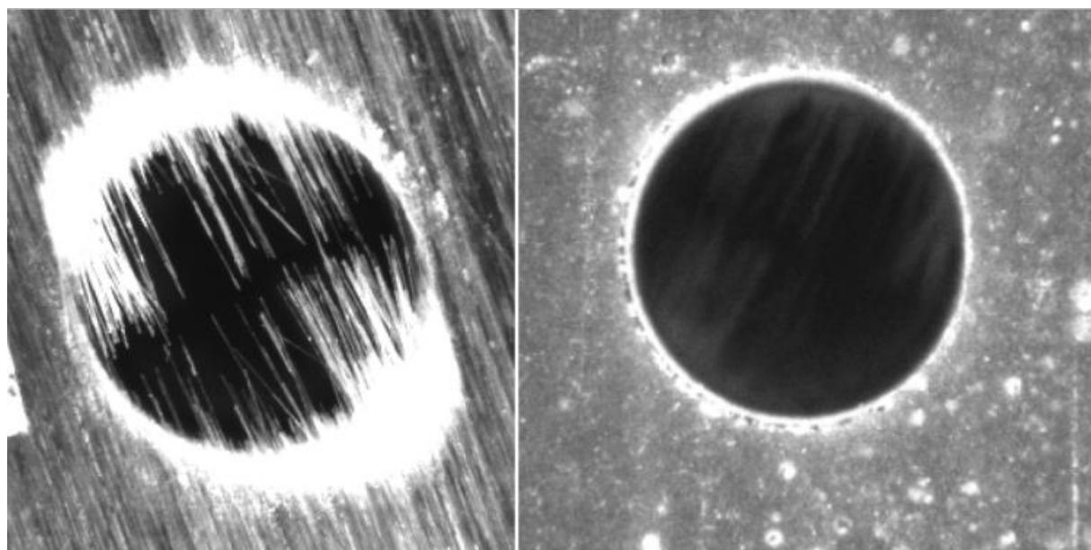
Slika 15. Izlazna (lijevo) i ulazna (desno) strana provrta
