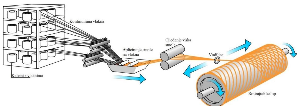
Slika 10. Shematski prikaz postupka namatanja vlakana [12]
