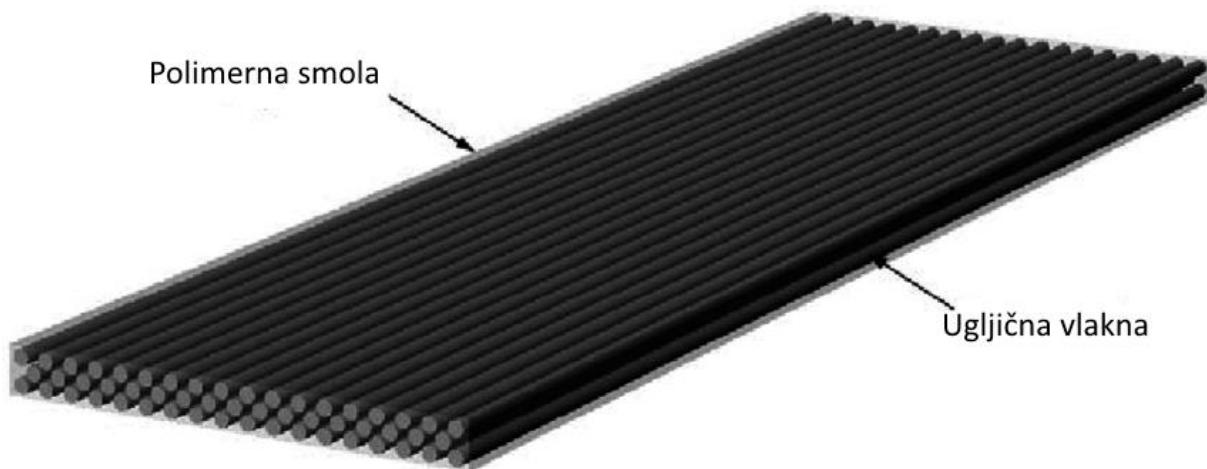
Slika 2. Primjer unutrašnje strukture polimernog kompozita s ugljični vlaknima [7]
