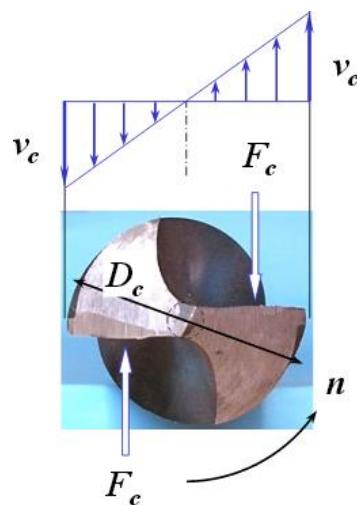
Slika 6. Prikaz raspodjele brzine rezanja po promjeru svrdla [10]
