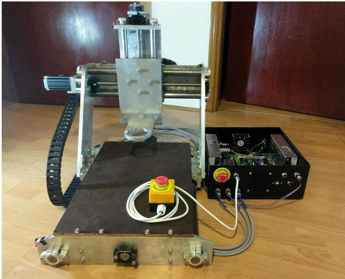
**Slika 82. CNC glodalica s upravljačkom kutijom(2)**
