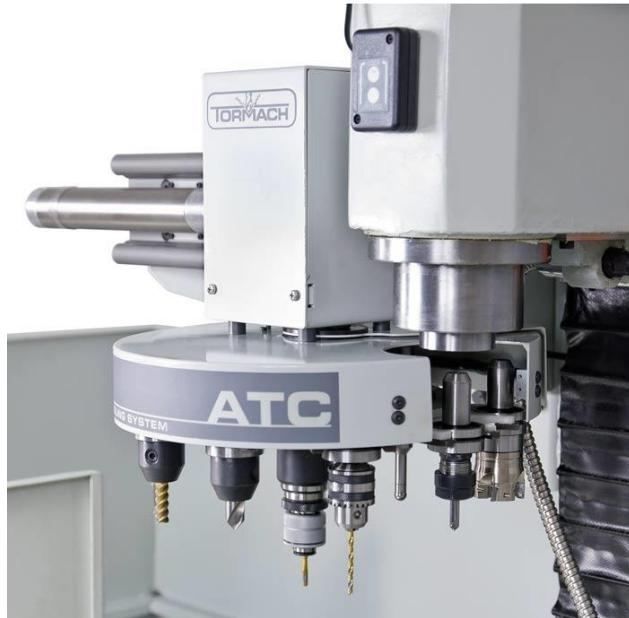
**Slika 14. Sistem automatske promjene alata**
