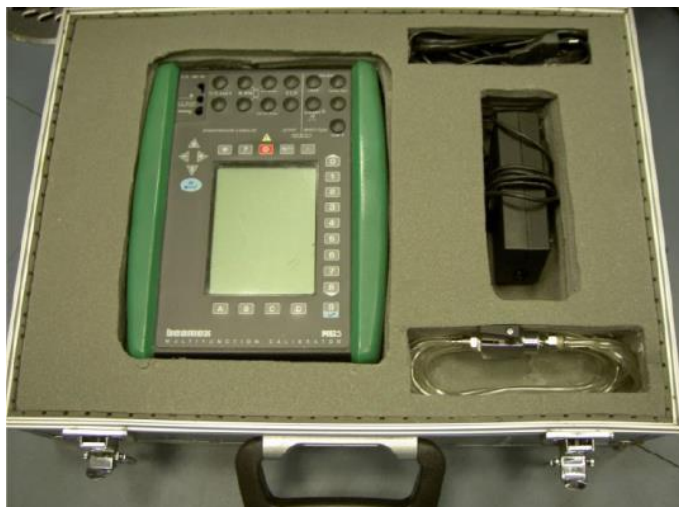
Slika 16. Prijenosno mjerilo EURAMET 1170
