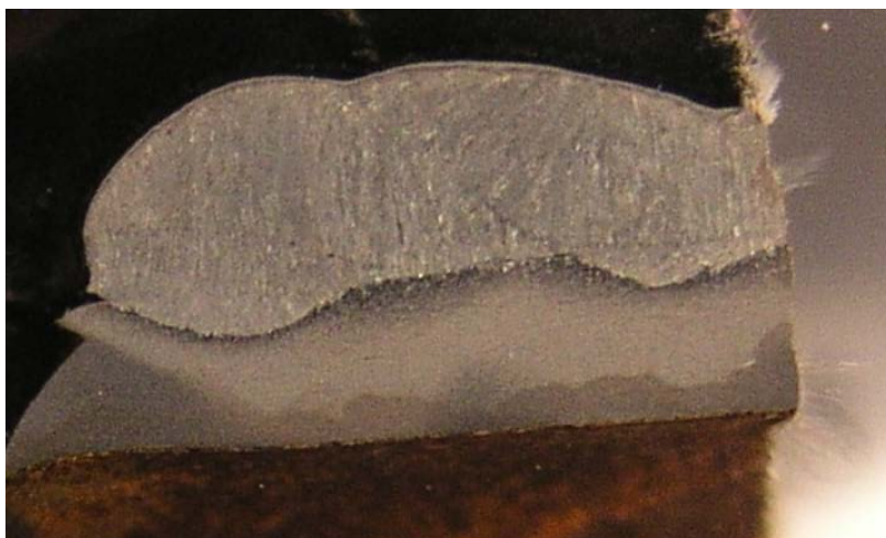
Slika 29. Presjek zavora i ZUT-a
