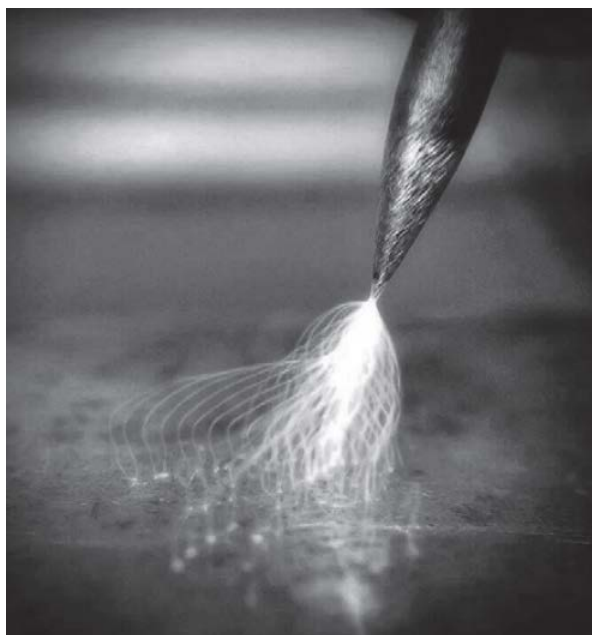
Slika 13. Uspostava električnog luka visokofrekventnim generatorom [14]
