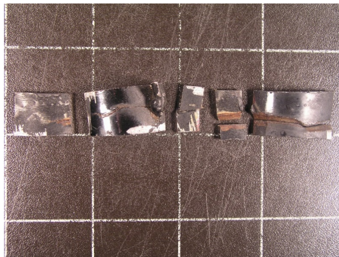
Slika 26. Izrezani uzorci za metalografsku analizu
