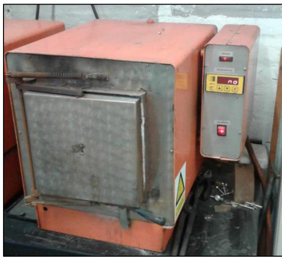
**Slika 4.5 Električna peć za toplinsku obradu ohlađivanjem u granulatu**
