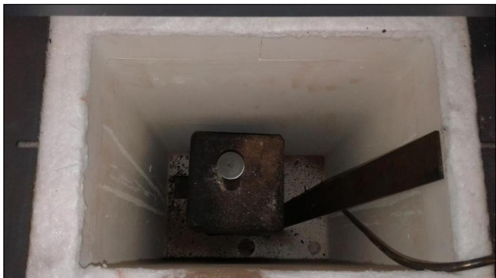
Slika 4.8 Ispitni uzorak na povиenom podiju unutar peći za toplinsku obradu
