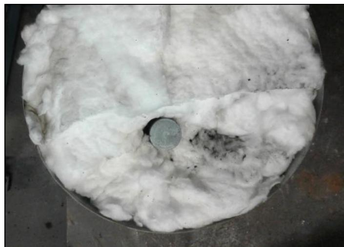
**Slika 4.9 Ispitni uzorak ohlađen u izolaciji od aluminijsko silikatne izolacijske vune**
