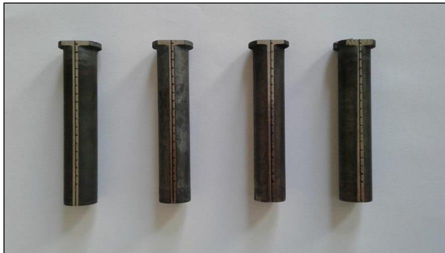
**Slika 4.12 Označene epruvete**
