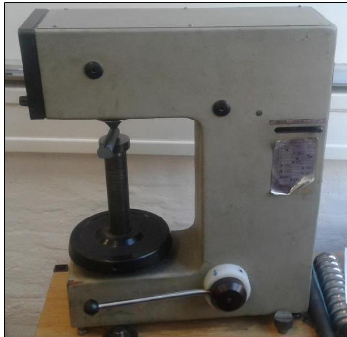
**Slika 4.10 Tvrdomjer za ispitivanje po metodi Rockwell C**
