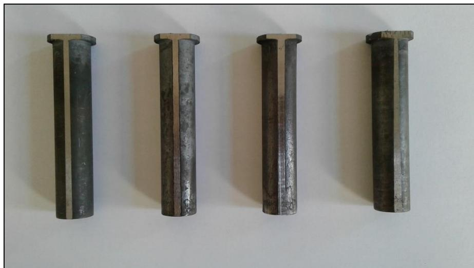
**Slika 4.11 Izbrušene epruvete**
