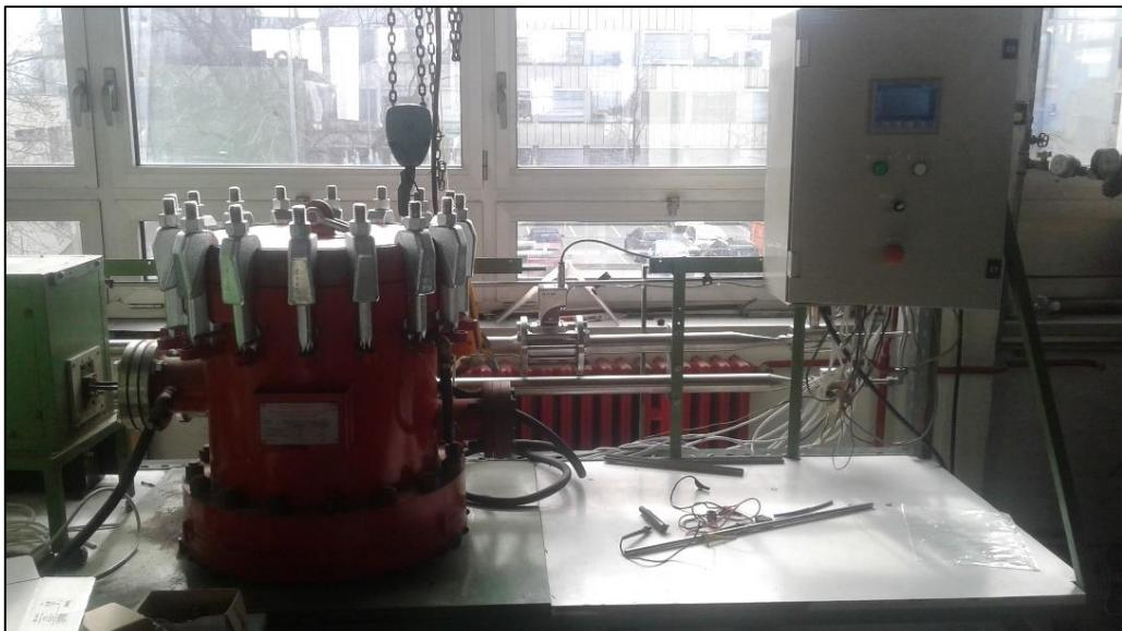
**Slika 5.4 Aparatura za pokus čeonog gašenja nastrujavanjem stlačenog plina**
