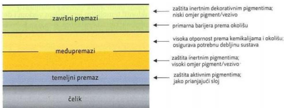
**Slika 9. Sustav premaza debljine najčešće od 360 do 600 µm [5]**
