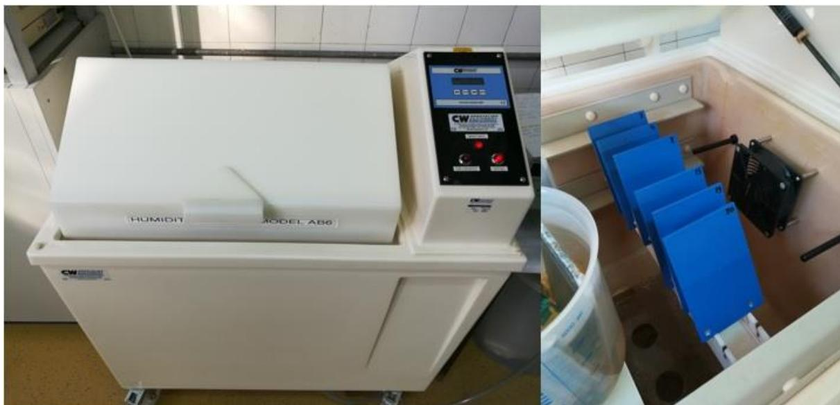
**Slika 22. Uzorci u vlažnoj komori tipa Humidity cabinet model AB6**
