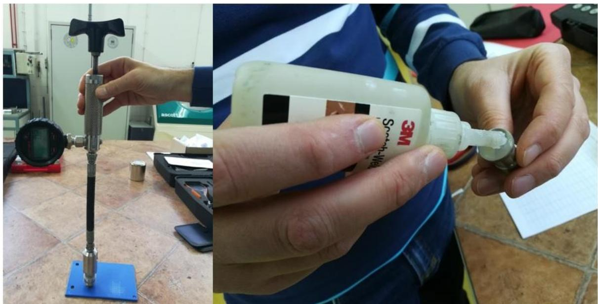
Slika 20. Ispitivanje vlačne čvrstoće premaza Pull off testom
