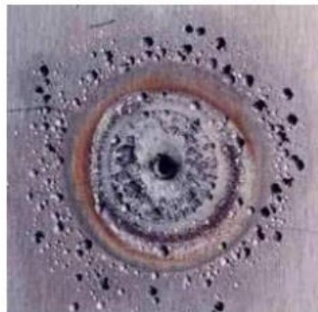
Slika 4. Primjer rupičaste korozije [7]
