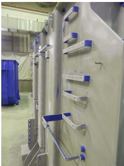
Slika 12. Nanešeni premaz na teško dostupna mjesta prije prskanja
