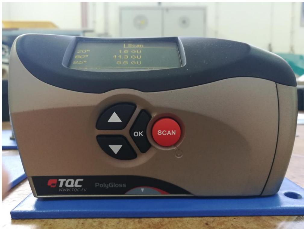
Slika 28. Mjerjenje sjaja površine premaza
