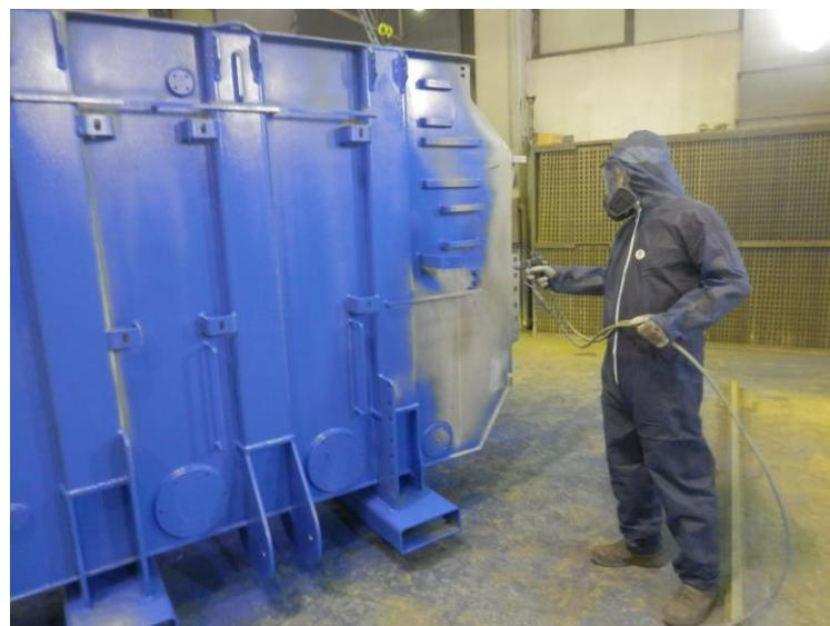
Slika 13. Nanošenje završnog premaza zračnim prskanjem
