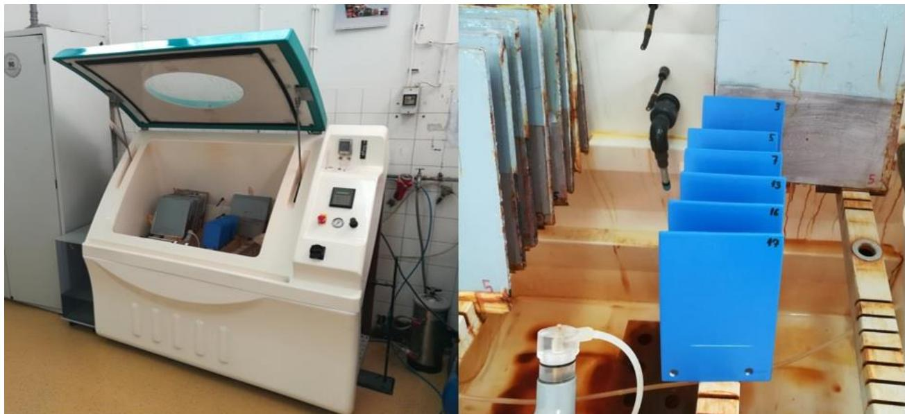
Slika 25. Ispitivanje u slanoj komori
