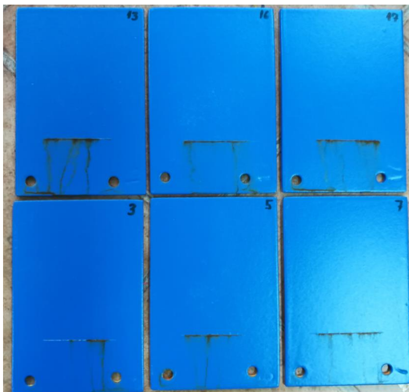
Slika 27. Uzorci nakon 720 h u slanoj komori
