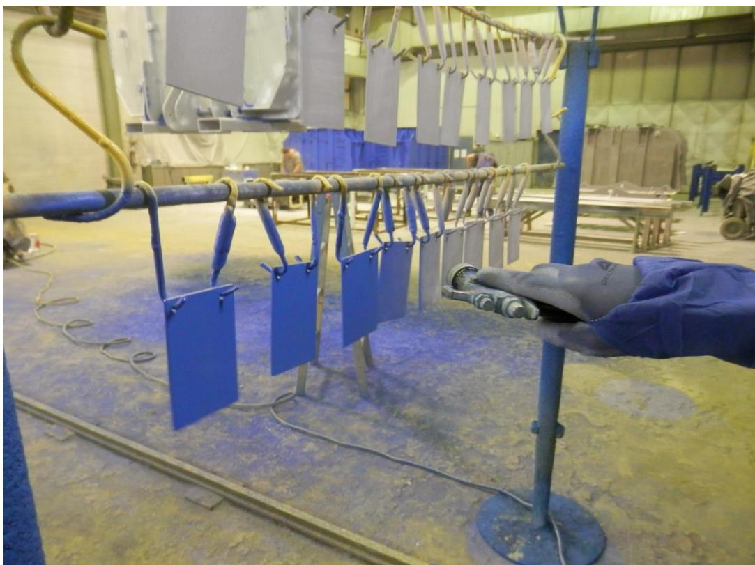
Slika 15. Nanošenje završnog premaza na uzorke, Midi d.o.o.
