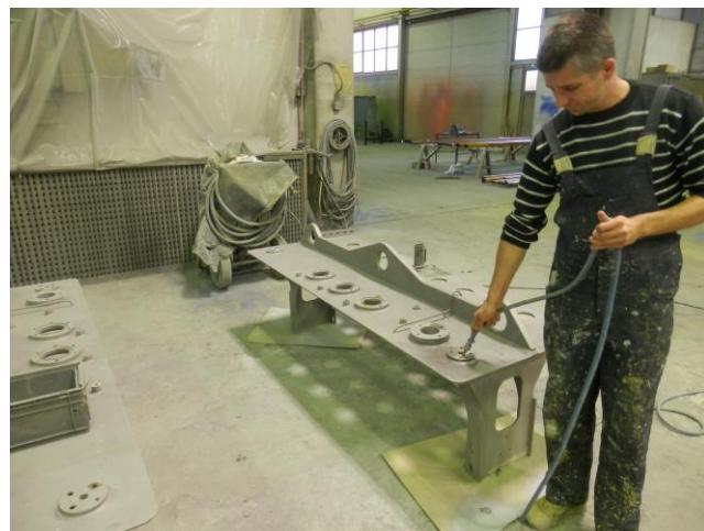
Slika 11. Čišćenje površina kućišta stlačenim zrakom
