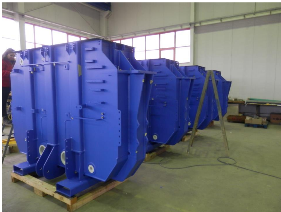
Slika 14. Kućišta energetskih transformatora nakon nanošenja premaza
