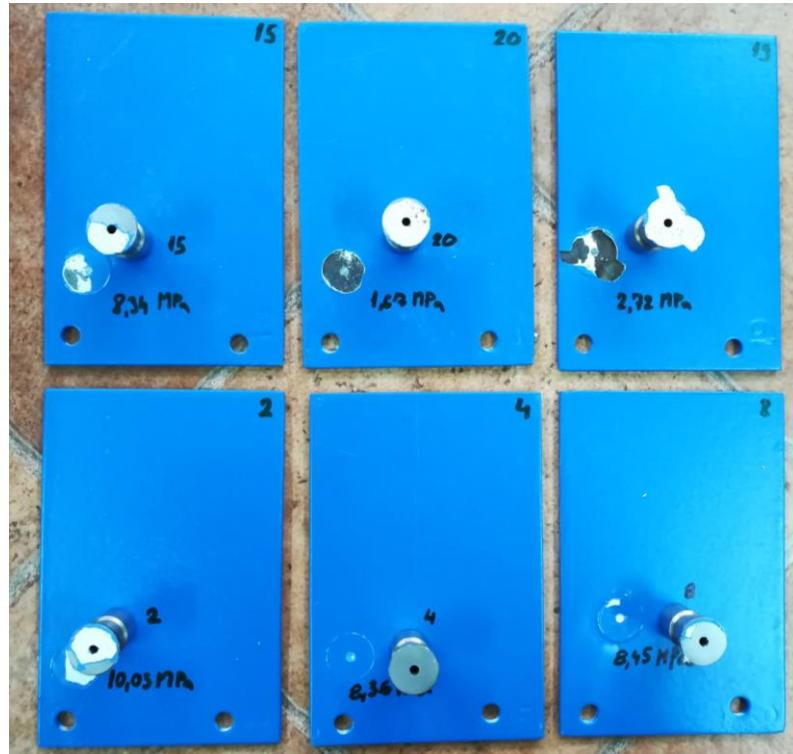
**Slika 21. Rezultati mjerjenja nakon vađenja uzoraka iz slane komore**
