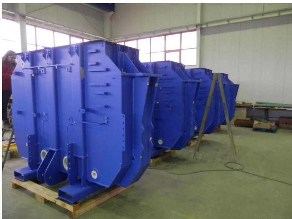
Slika 14. Kućišta energetskih transformatora nakon nanošenja premaza
