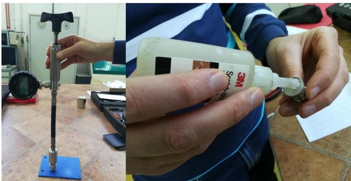
Slika 20. Ispitivanje vlačne čvrstoće premaza Pull off testom
