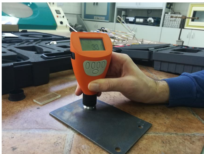
Slika 17. Postupak mjerenja hrapavosti na uzorku 11
