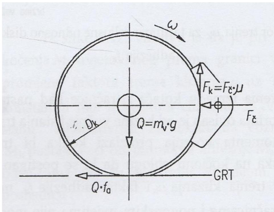
Slika 15. Sile na kotaču s čeljusnom kočnicom
