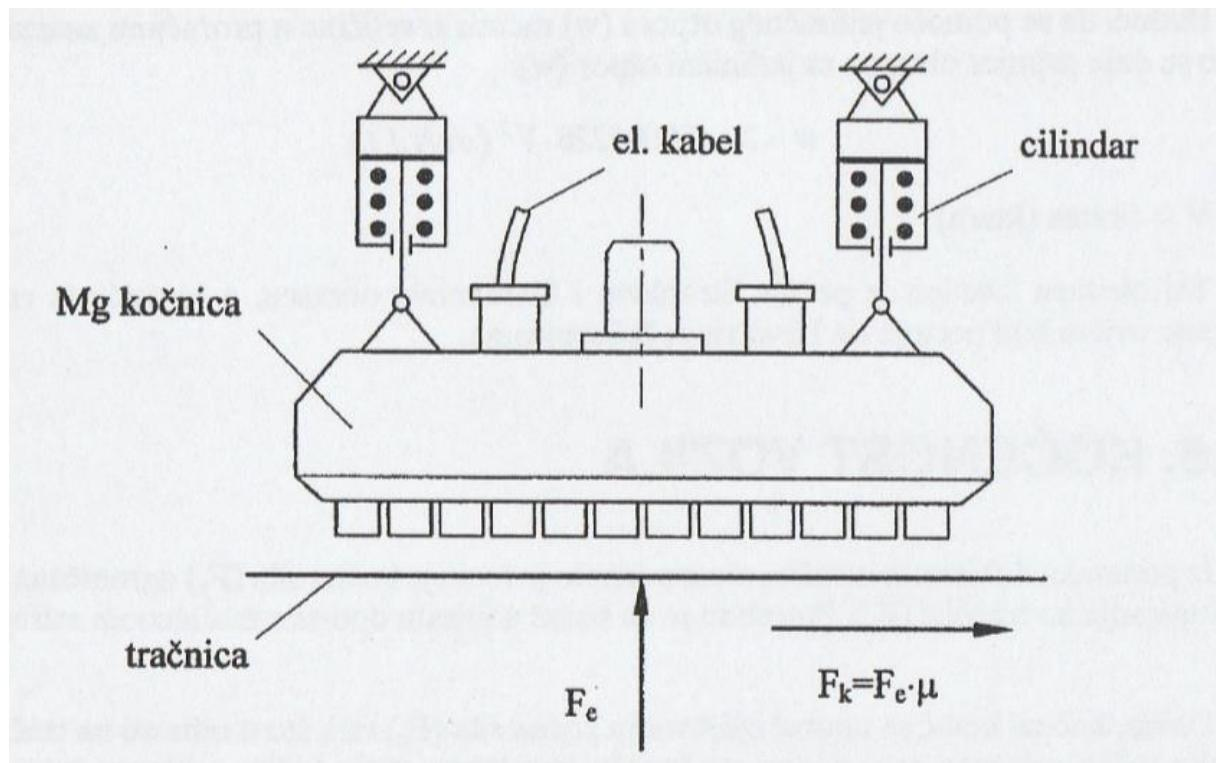
Slika 3. Sile na elektromagnetnoj kočnici
