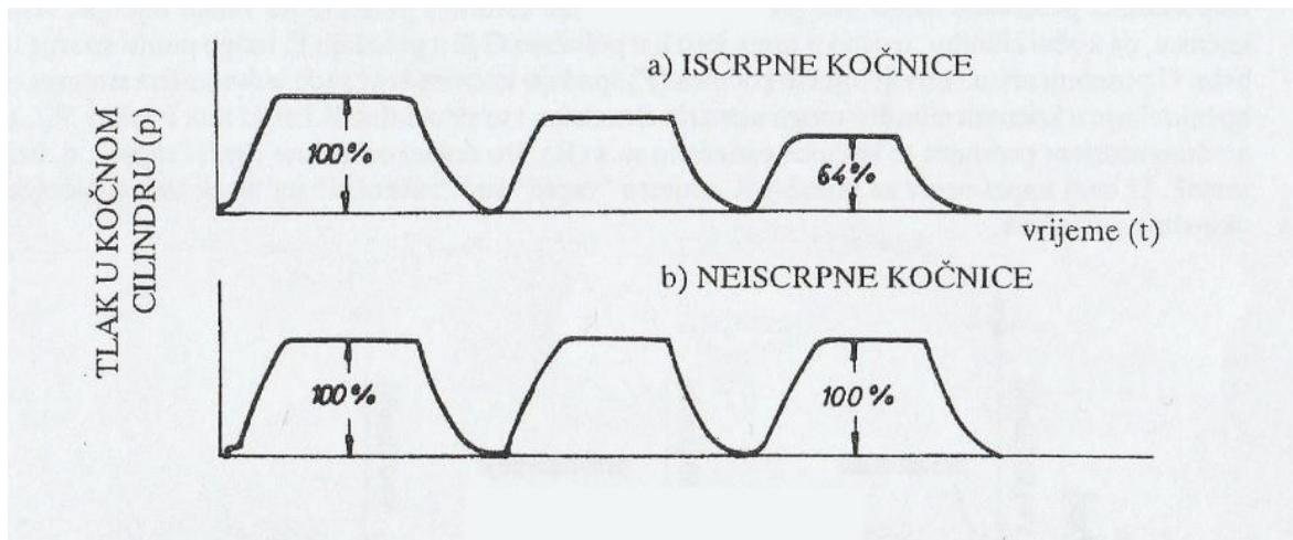
Slika 11. Radni dijagrami iscrpnih i neiscrpnih kočnica
