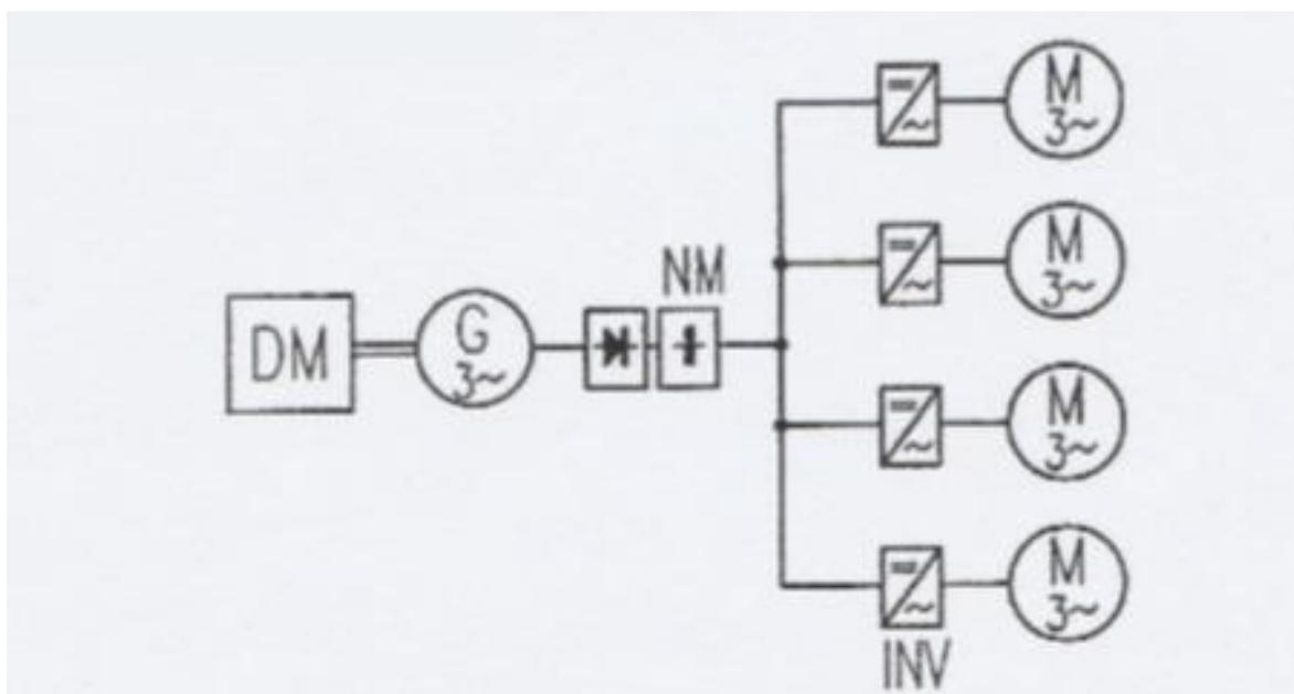
**Slika 8. Shema rada električnog prijenosnika izmjenično - izmjenične struje**
