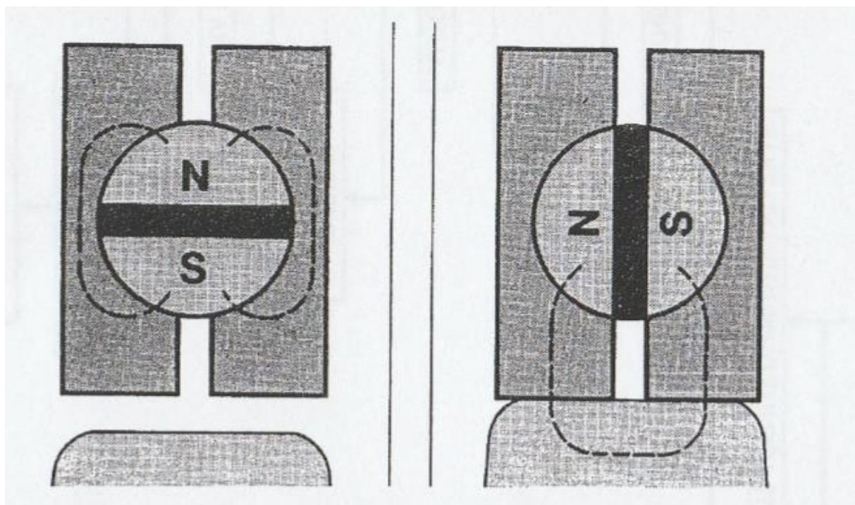
Slika 7. Shema rada kočnice sa stalnim magnetima
