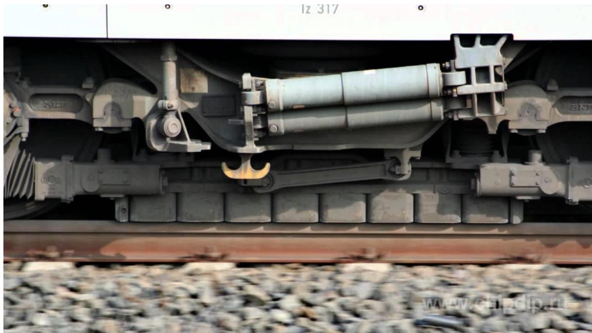
Slika 5. Elektromagnetna tračnička kočnica s niskim ovjesom
