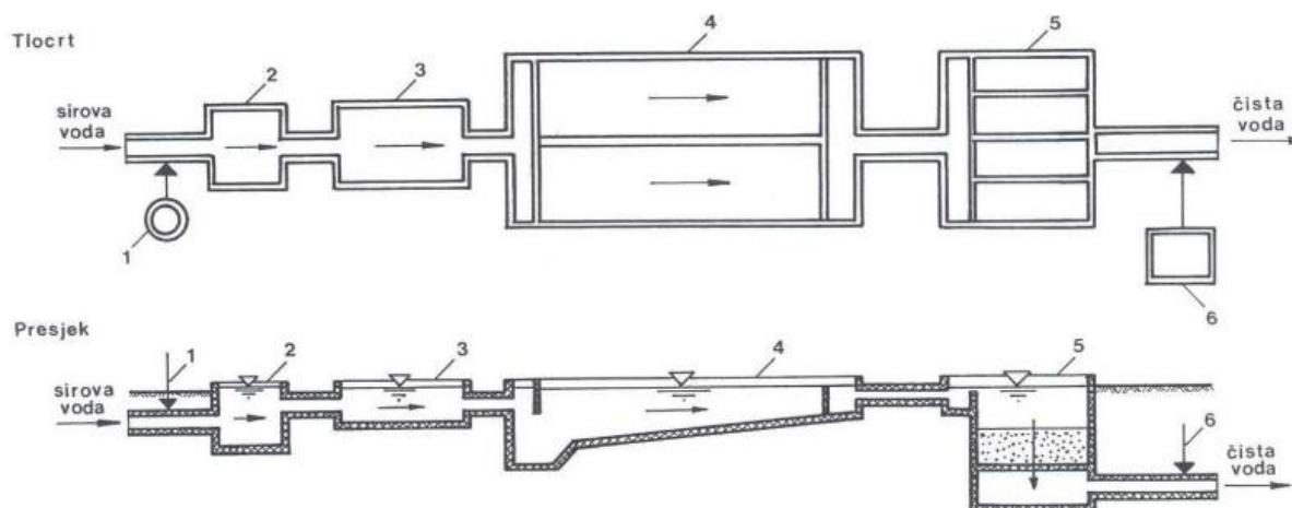
Slika 3.6 Shema postrojenja za kondicioniranje vode [10]
