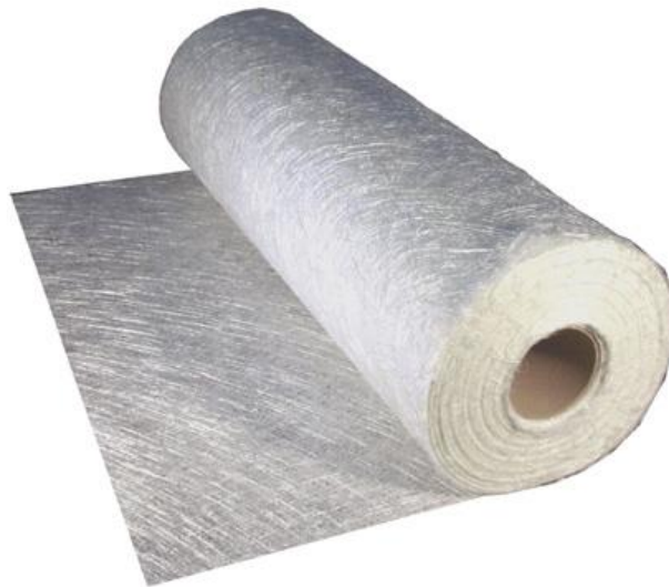
Slika 5. Staklena vlakna namotana na valjak [6]
