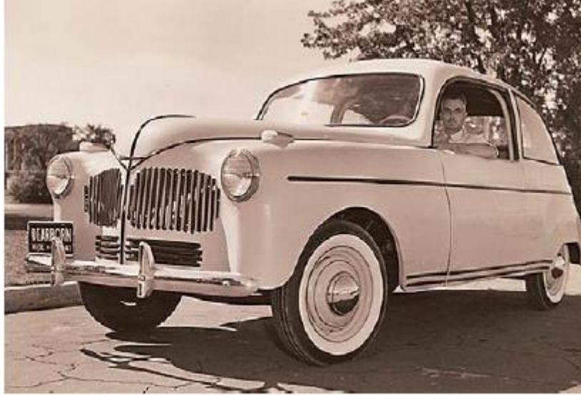
Slika 8. Fordov automobil od duromernog kompozita s konopljom [11]
