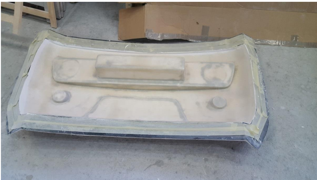
Slika 53. Kalup za izradu dijela karoserije vozila
