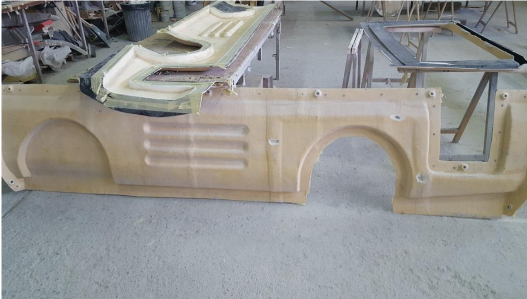
Slika 50. Kalup za izradu dijela karoserije vozila
