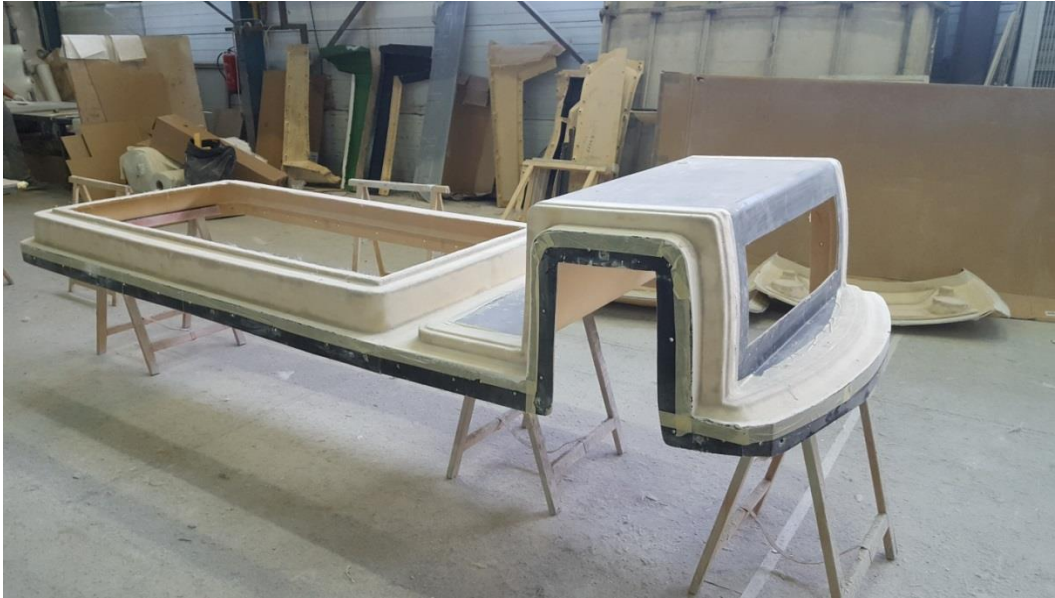
Slika 48. Kalup za izradu dijela karoserije vozila
