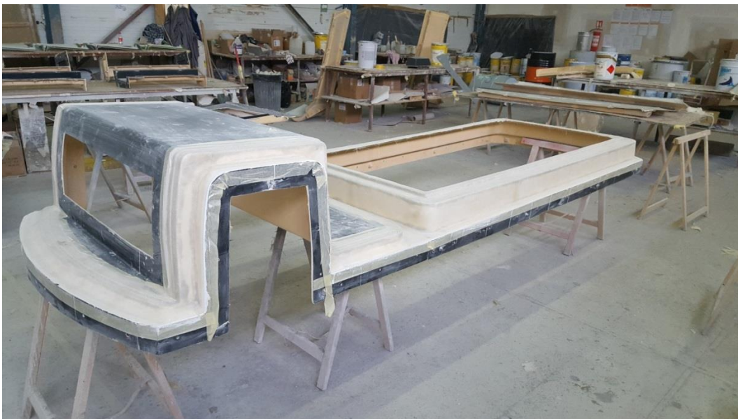
Slika 49. Kalup za izradu dijela karoserije vozila
