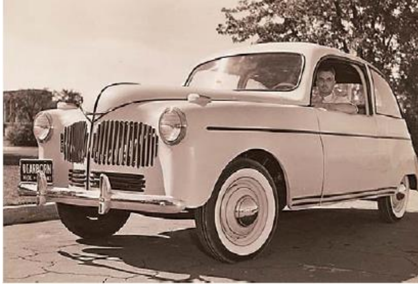
Slika 8. Fordov automobil od duromernog kompozita s konopljom [11]
