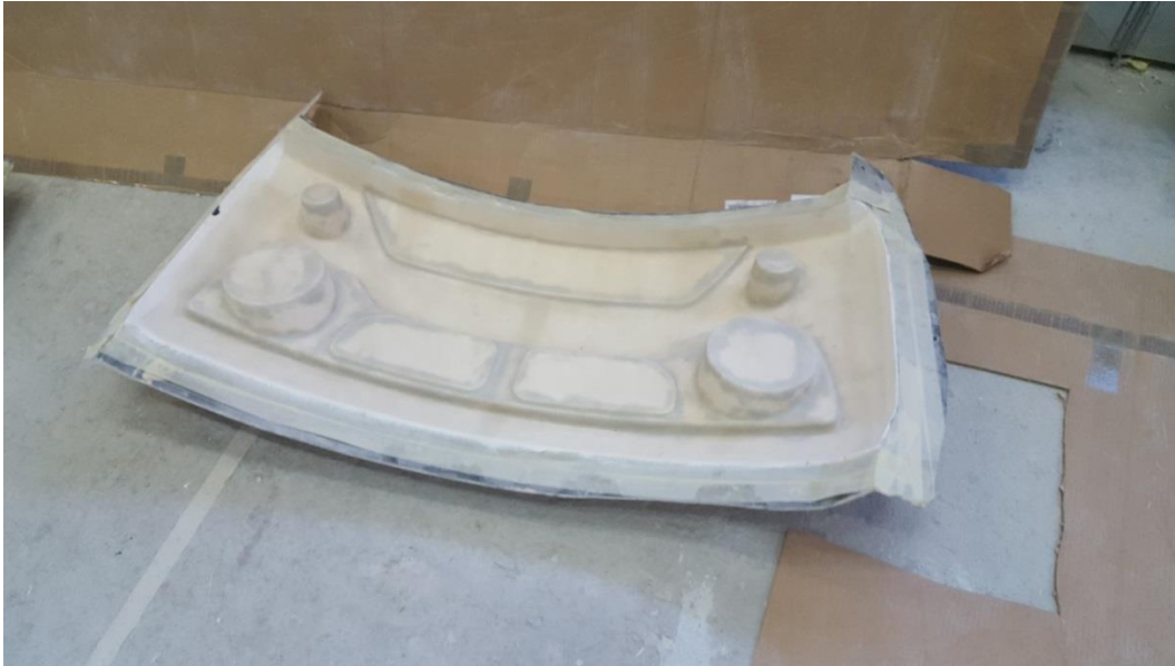
Slika 52. Kalup za izradu dijela karoserije vozila
