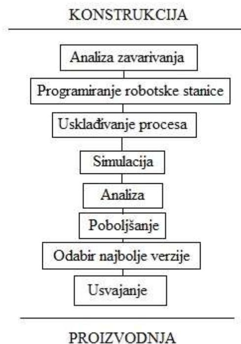
Slika 4.5 Blok dijagram programiranja robota *off-line* metodom [17]
