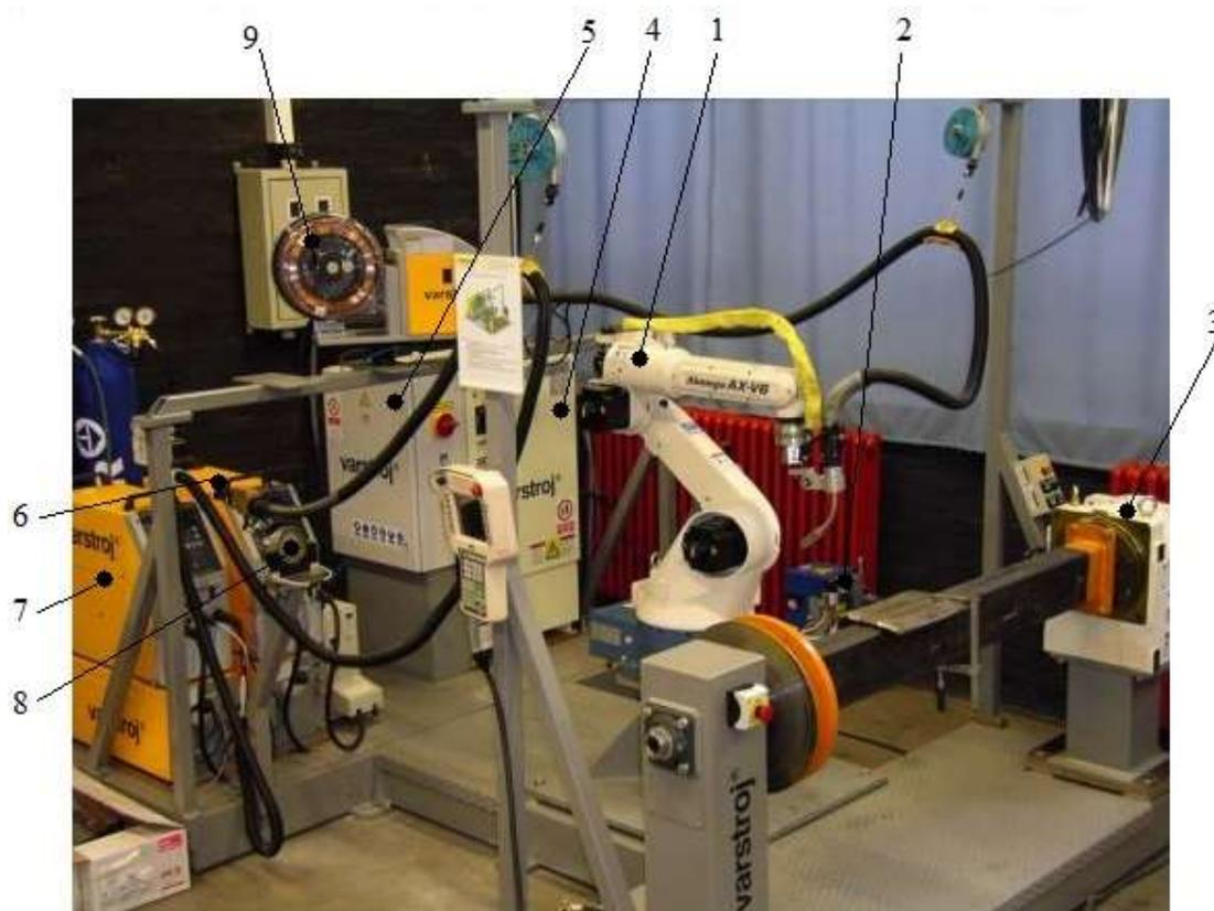
Slika 5.1 Robotska stanica za u laboratoriju za zavarivanje [20]
