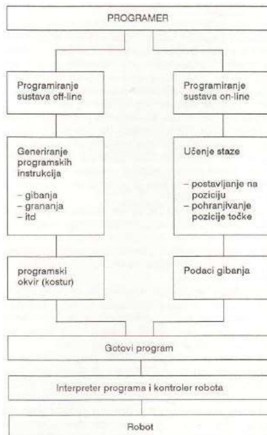
Slika 4.6 Blok dijagram programiranja robota hibridnom metodom [17]
