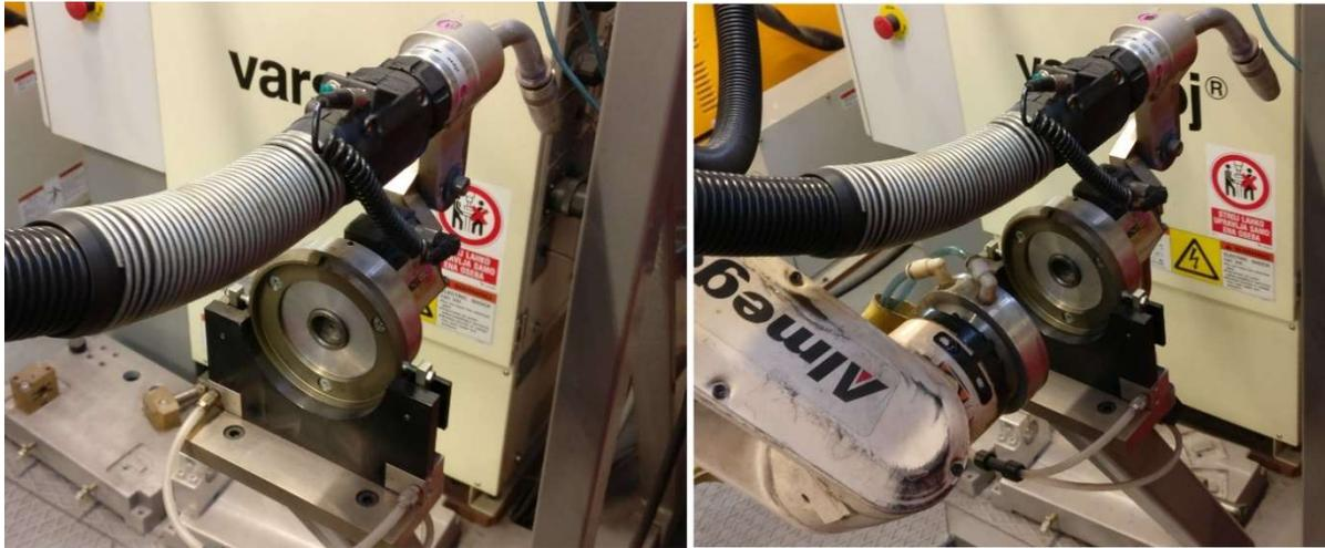
Slika 6.11 Prilaz nosaču MIG/MAG pištolja za zavarivanje
