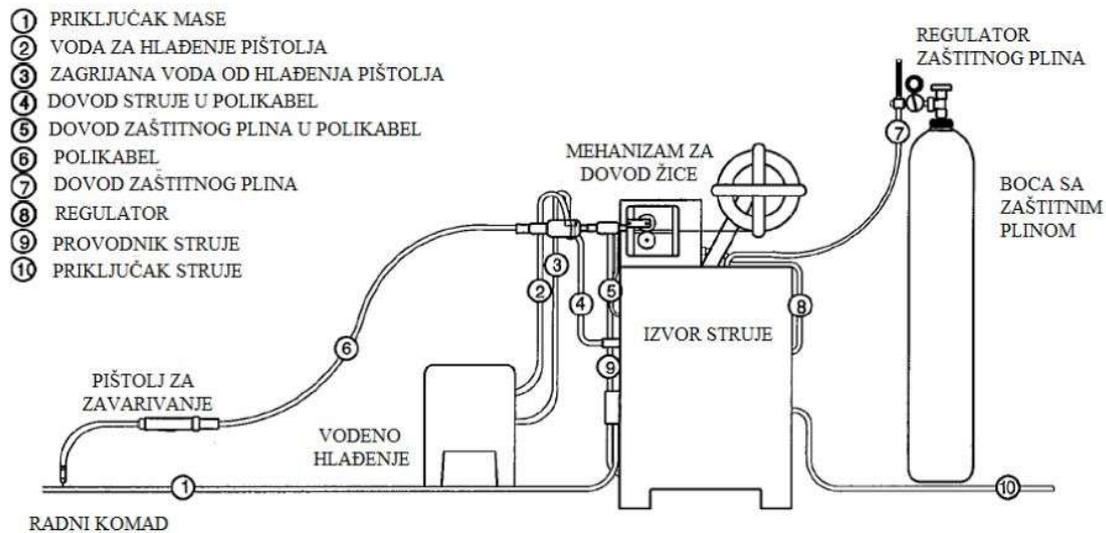
Slika 3.2 Skica sustava za MAG postupak zavarivanja [5]
