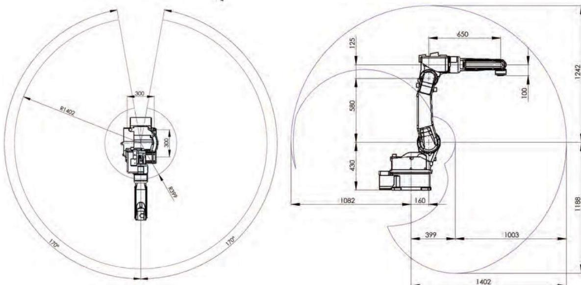
Slika 5.3 Radni prostor robota OTC ALMEGA AX-V6 [21]
