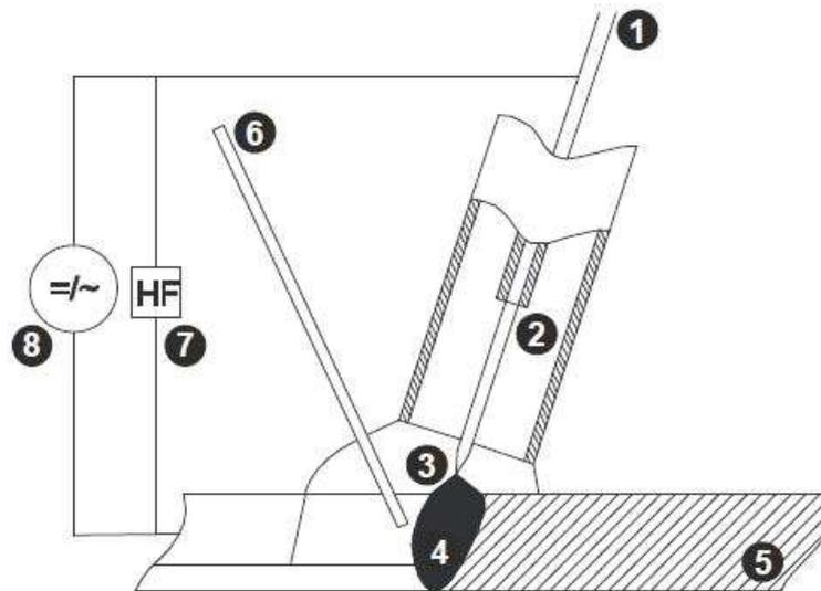
**Slika 3.7 Shematski prikaz procesa TIG zavarivanja: 1–netaljiva elektroda, 2–sapnica pištolja, 3–električni luk, 4–rastaljeni materijal, 5–osnovni materijal, 6–dodatni materijal, 7–visokofrekventni generator, 8–izvor struje. [10]**
