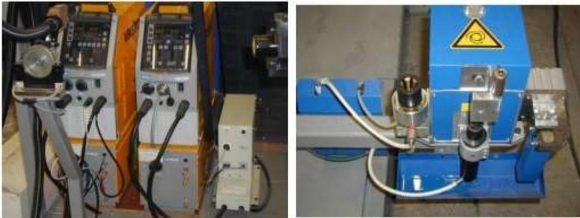
Slika 5.4 Izvori struje za zavarivanje sa ARC senzorom i sustav za čišćenje sapnice i rezanje žice. [20]
