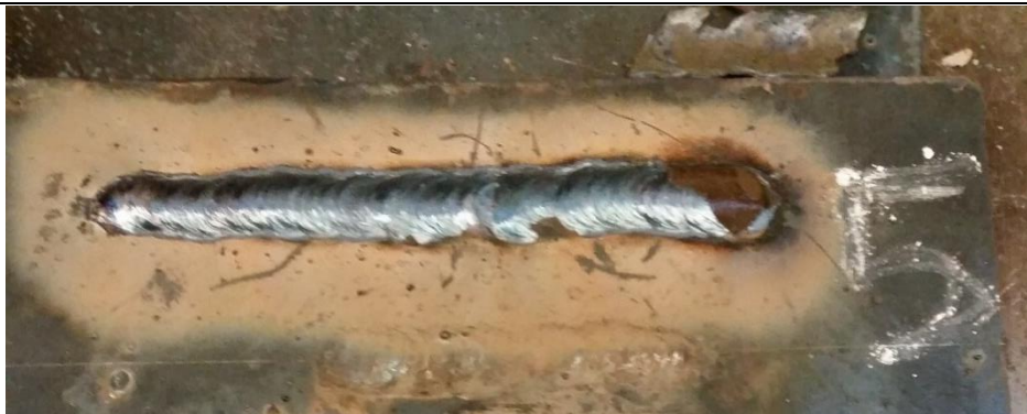
Slika 47. Zavar ispitnog uzorka 5 i ispitne ploče
