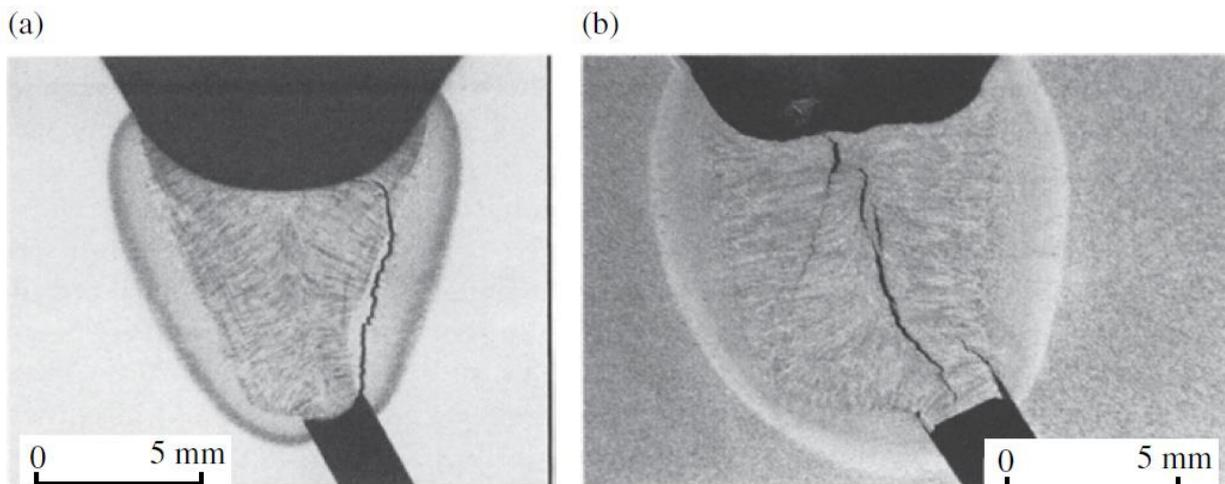
**Slika 31. Presjeci ispitnih uzorka Tekken testa. (a) Metal zavara veće čvrstoće od osnovnog metala (b) Metal zavara manje čvrstoće od osnovnog metala [11]**
