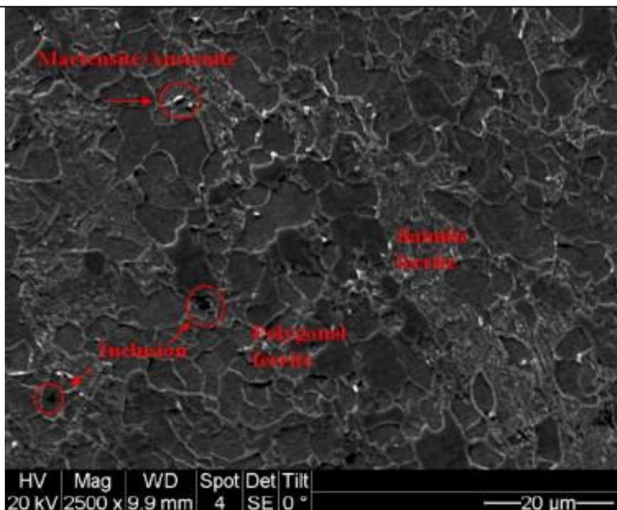
**Slika 6. Mikrostruktura čelika X80 pri povećanju od 2500X [10]**
