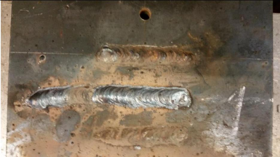
**Slika 39. Zavar ispitnog uzorka 1 i ispitne ploče**
