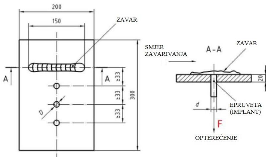
**Slika 35. Shematski prikaz osnovne ploče za Implant test [14]**
