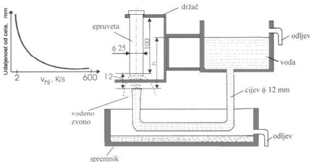
Slika 26. Shematski prikaz ispitivanja prokaljivosti metodom Jominy [20]
