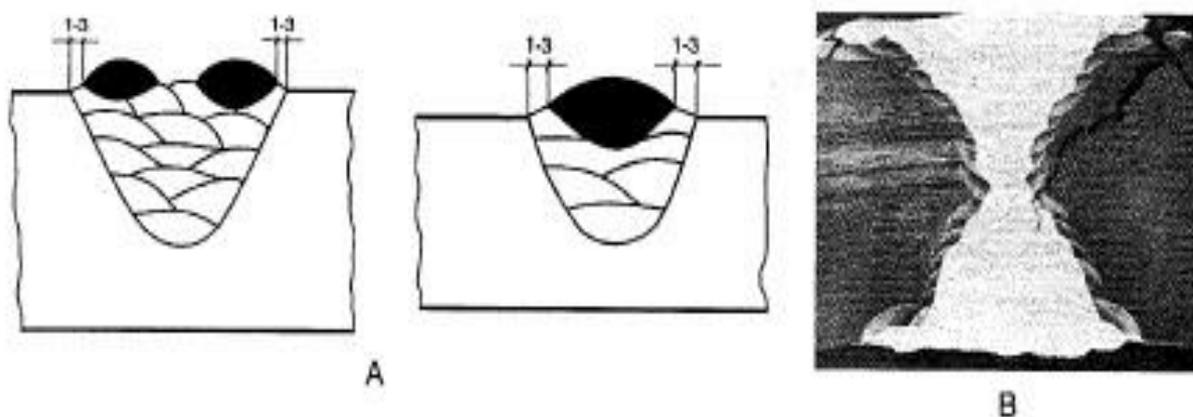
**Slika 25. Prikaz izvođenja završnih slojeva zavarenog spoja**
