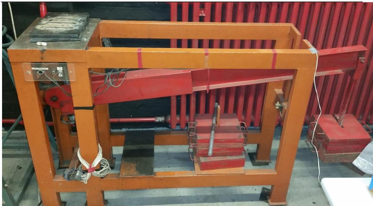
**Slika 38. Prikaz Implant testa tijekom opterećenja epruvete**
