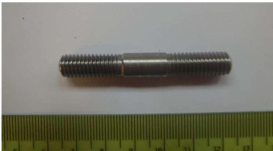
Slika 37. Implant uzorak s obostranim navojem
