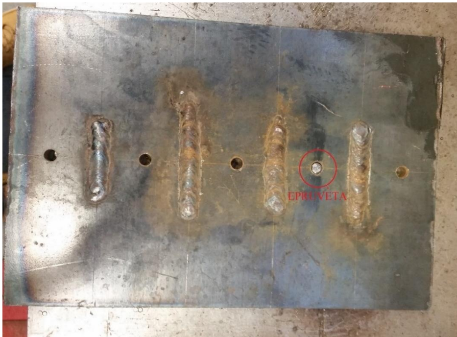
Slika 36. Pripremljena osnovna ploča s pozicioniranom epruvetom
