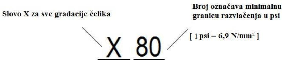
Slika 1. Označavanje čelika za cjevovode prema API 5L [4]
