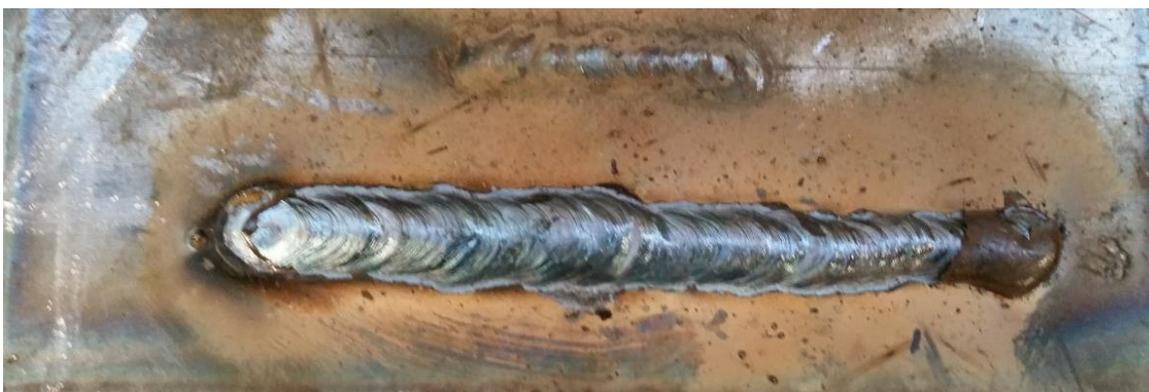
**Slika 45. Zavar ispitnog uzorka broj 4 i ispitne ploče**
