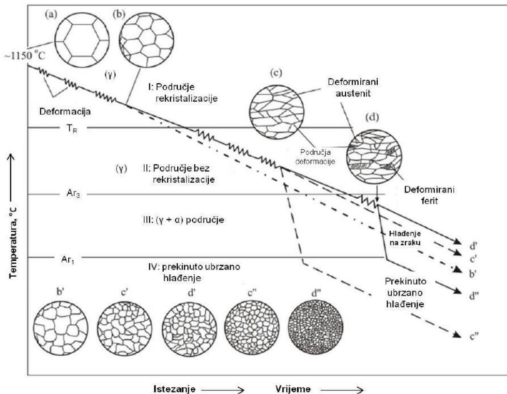
Slika 5. Promjena mikrostrukture tijekom TMCP postupka [9]
