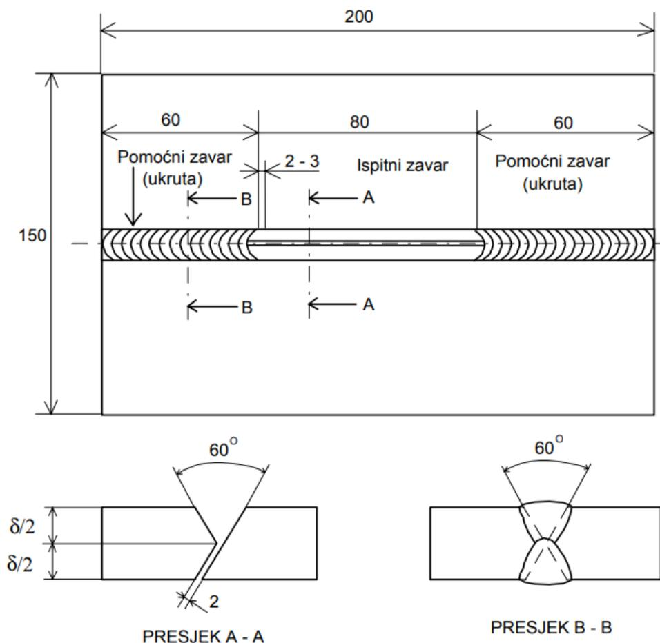
**Slika 30. Shematski prikaz Tekken metode [21]**
