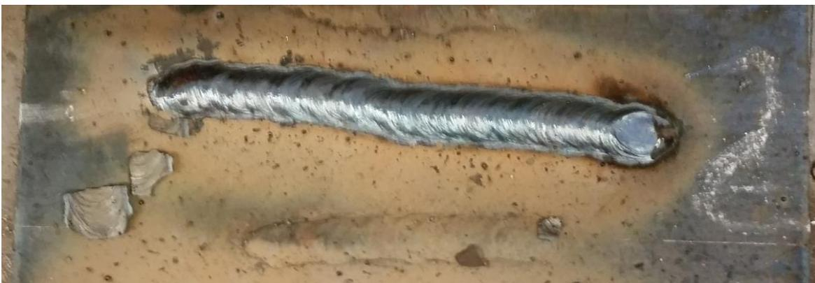
**Slika 41. Zavar ispitnog uzorka 2 i ispitne ploče**
