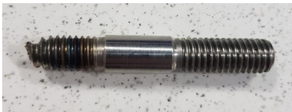
Slika 48. Ispitni uzorak broj 5 nakon loma
