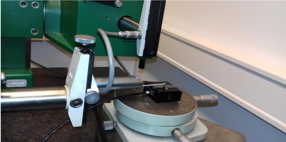
Slika 45. Izgled mjernog uređaja pri umjeravanju vertikalne komponente
