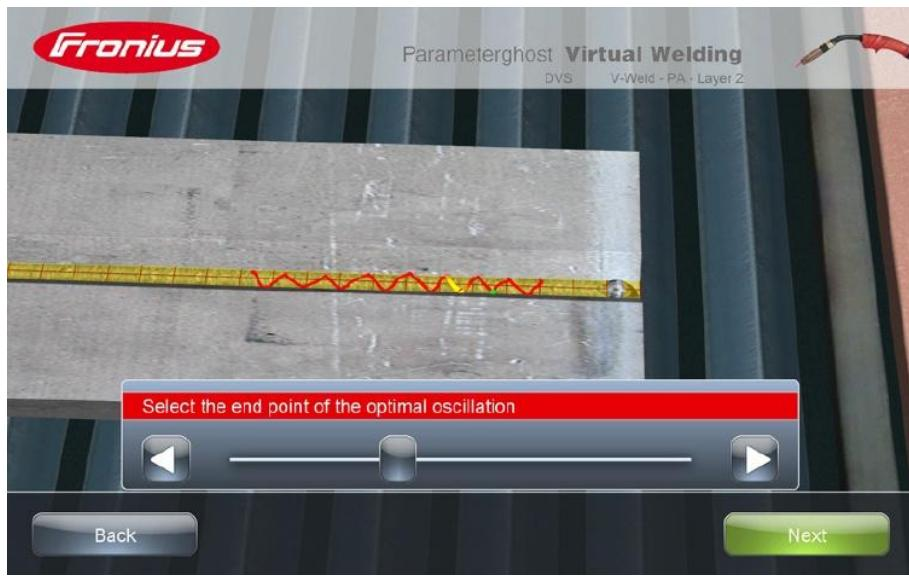
Slika 64. Odabir krajnje točke idealnog osciliranja [6]
