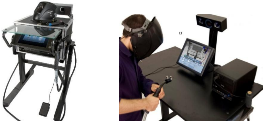
Slika 22. Primjer portalne (lijevo) i stolne (desno) izvedbe [9]
