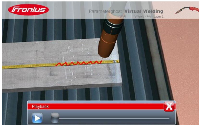
Slika 63. Odabir početne točke idealnog osciliranja [6]
