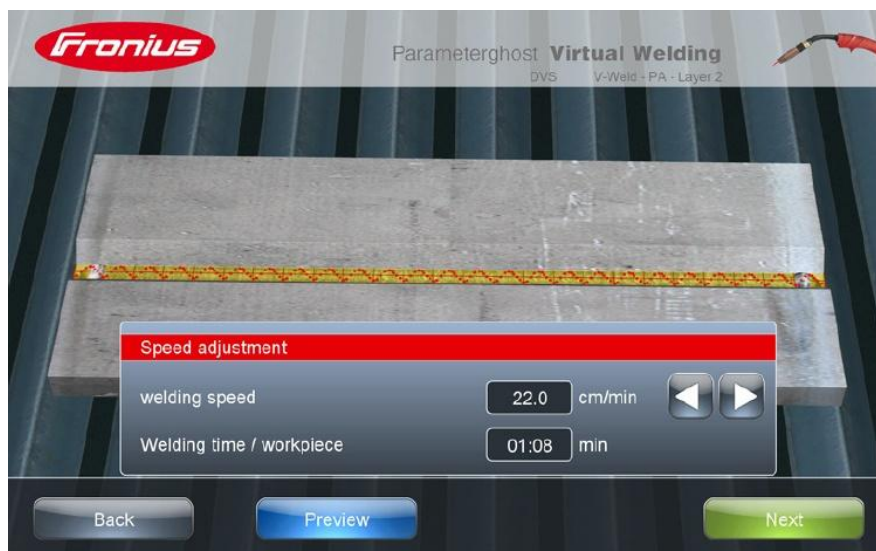
Slika 61. Odabir brzine zavarivanja [6]
