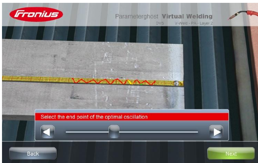
Slika 64. Odabir krajnje točke idealnog osciliranja [6]
