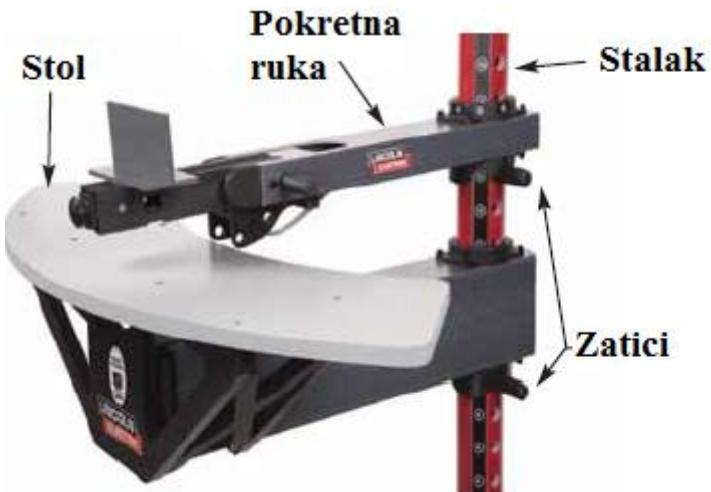
Slika 15. Dijelovi stalka [7]
