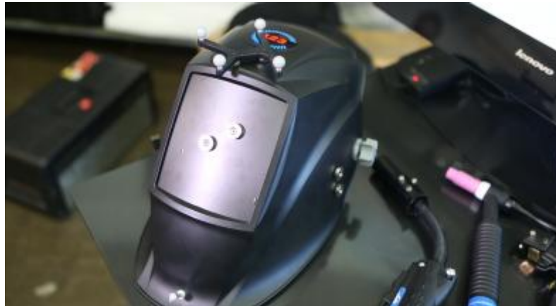
Slika 24. Maska za zavarivanje simulatora Arc+ [10]
