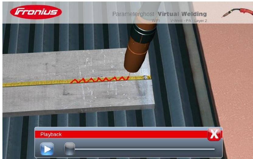
Slika 63. Odabir početne točke idealnog osciliranja [6]
