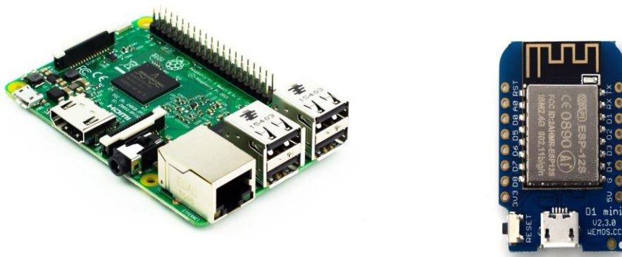
Slika 1. Raspberry Pi 3 (lijevo) [1] - Wemos D1 mini (desno) [2]
