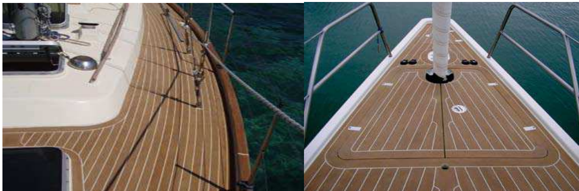
Slika 59. Primjena „Deltex“ kompozita na plovilu
