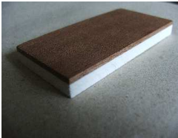
Slika 36. Uzorak kompozita mahagonij-PVC
