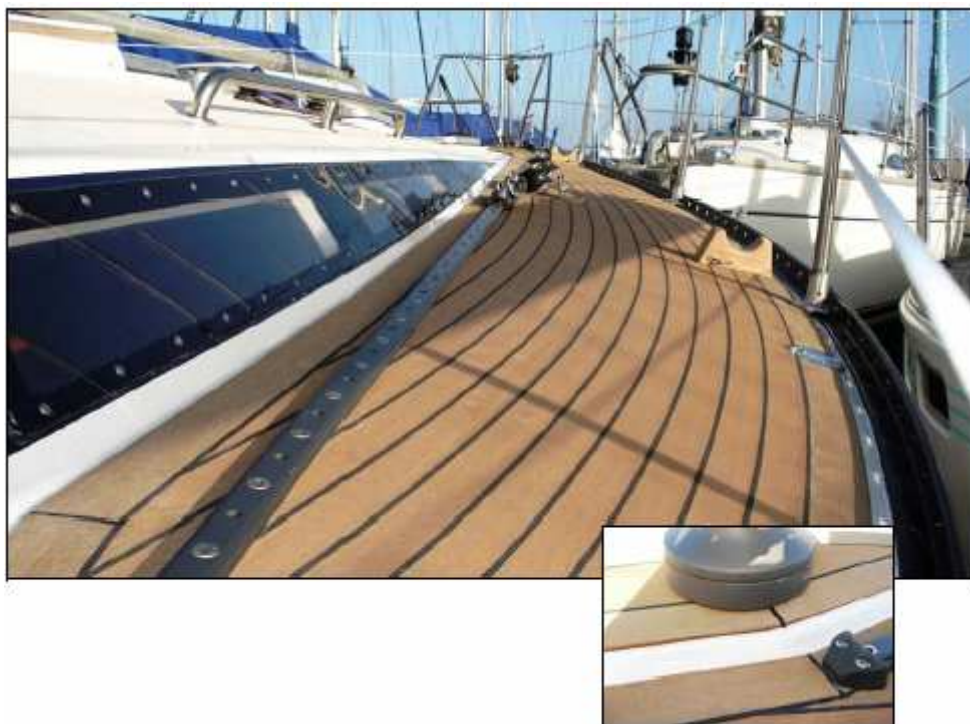
Slika 60. Primjena „Deltex“ materijala
