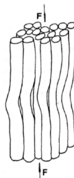
Slika 25. Tlačno opterećenje vlakana
