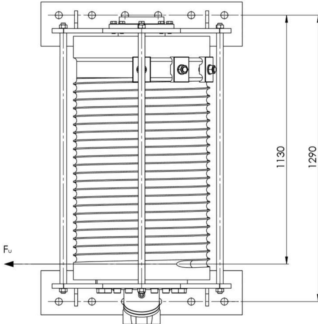
Slika 29. Shema opterećenja uslijed pomaka
