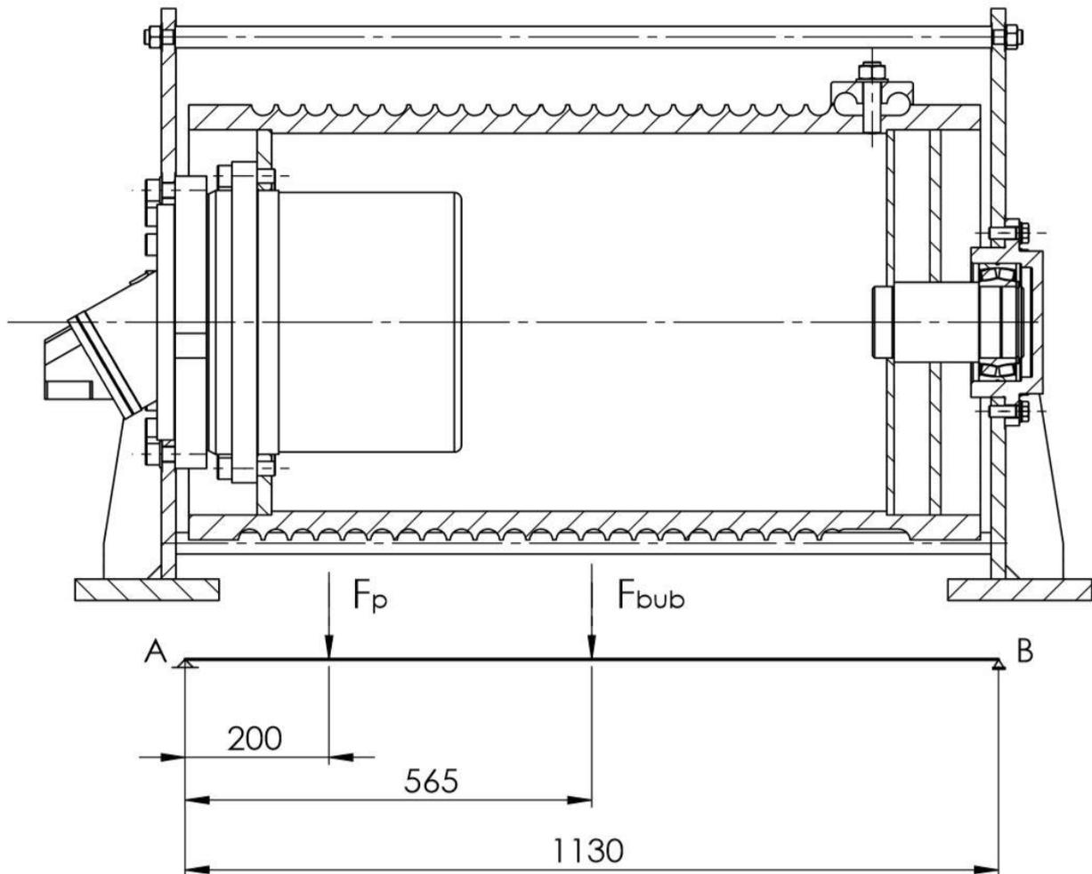
Slika 25. Opterećenje u vertikalnoj ravnini
