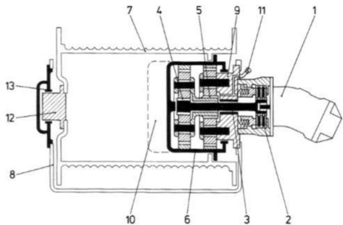
Slika 6. Hidrauličko vitlo s prirubnim planetarnim reduktorom
