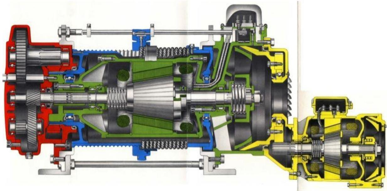
**Slika 3. Kompaktna izvedba električnog vitla**
