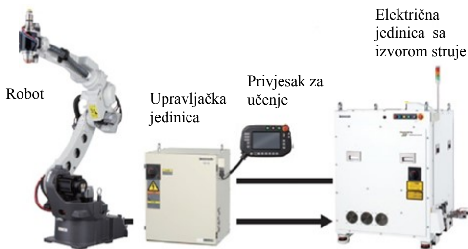
Slika 6. Osnovni sustav robotiziranog zavarivanja [3]
