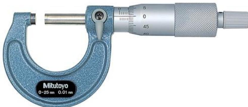
**Slika 14. Mikrometar**
