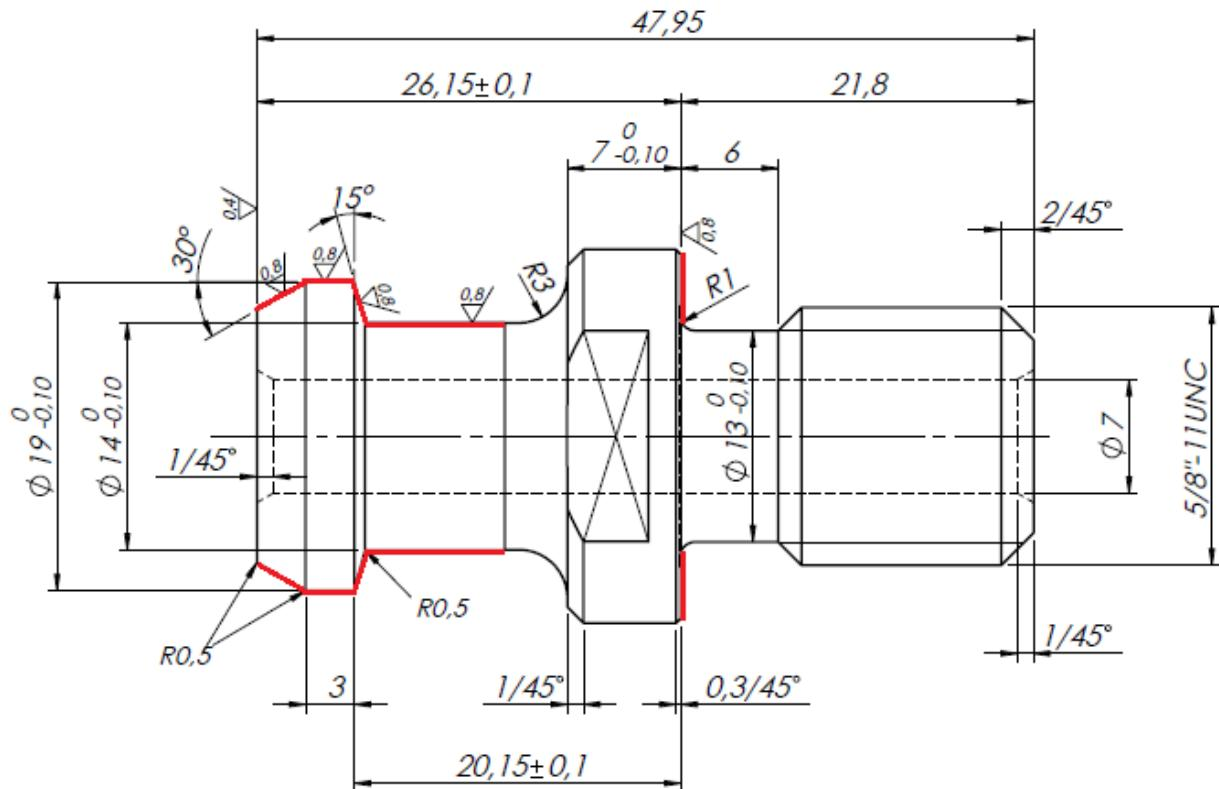
Slika 12. Obradene površine
