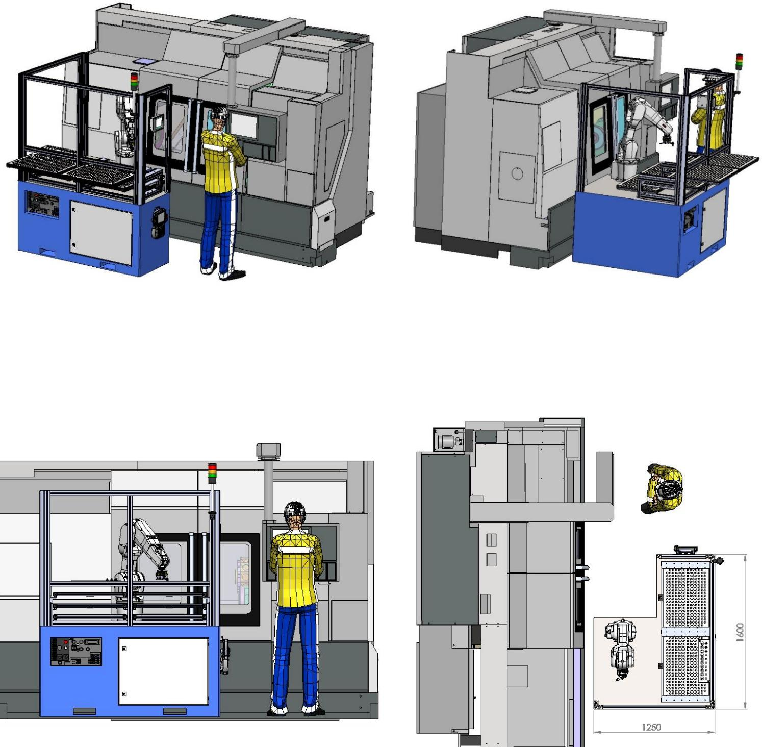
Slika 27. Koncept robotske celije
