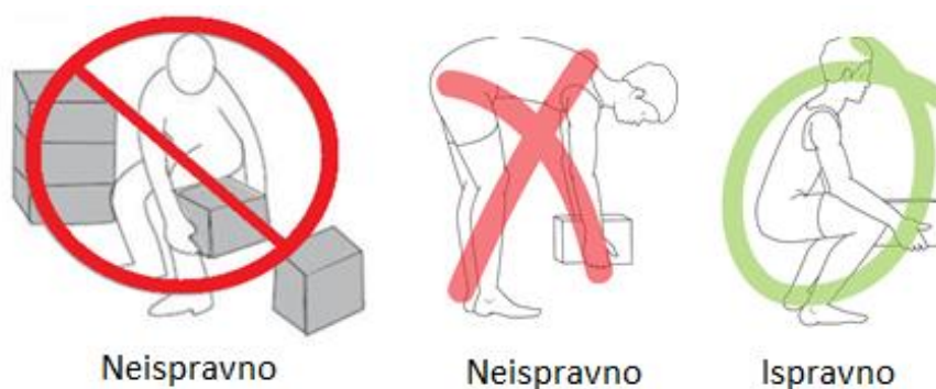
Slika 27. (Ne)ispravni načini podizanja tereta s poda; prerađeno prema [22]
