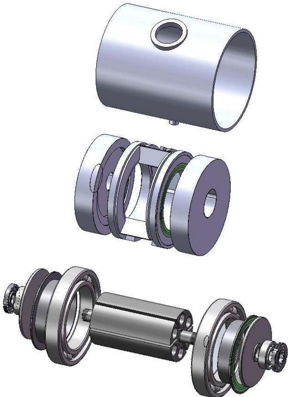
**Slika 35.** Trodimenzionalni prikaz sastavnih dijelova lamelnog kompresora
