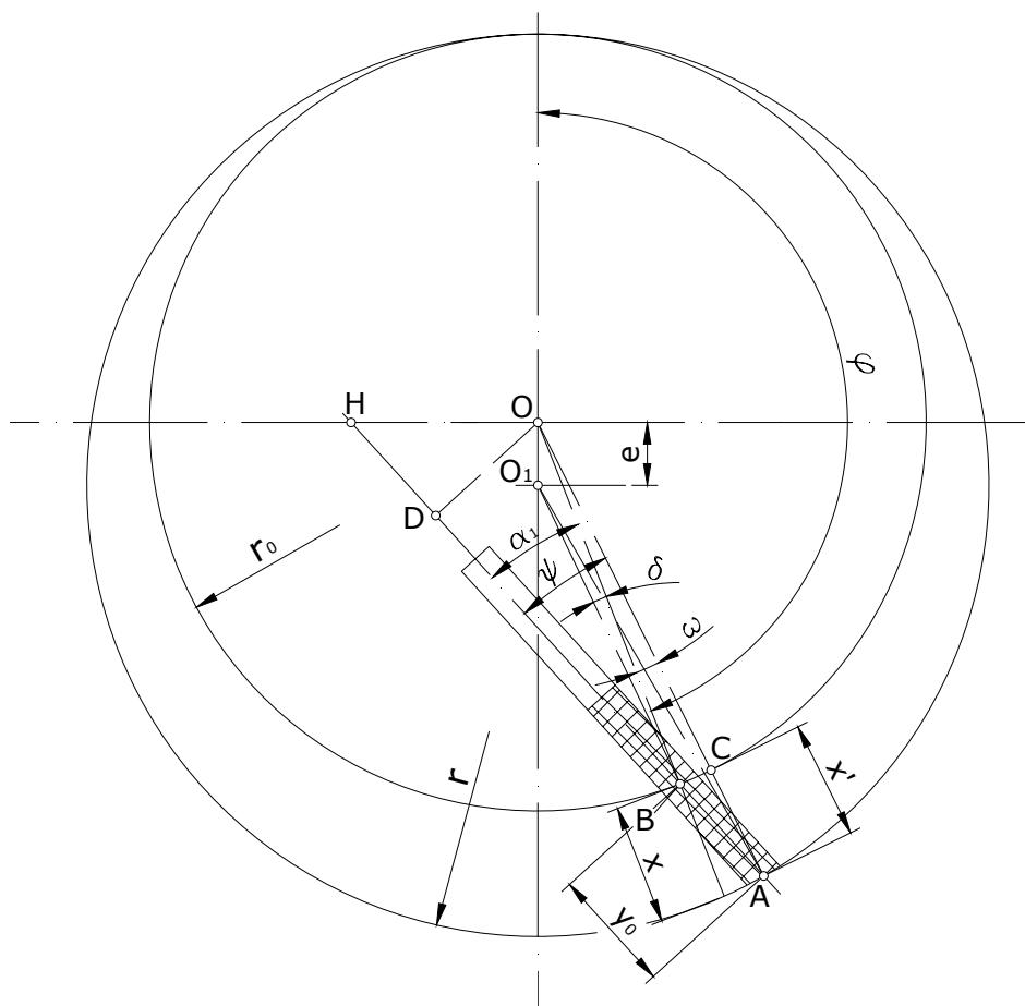
Slika 25. Geometrijski parametri tangencijalnog rasporeda lamele
