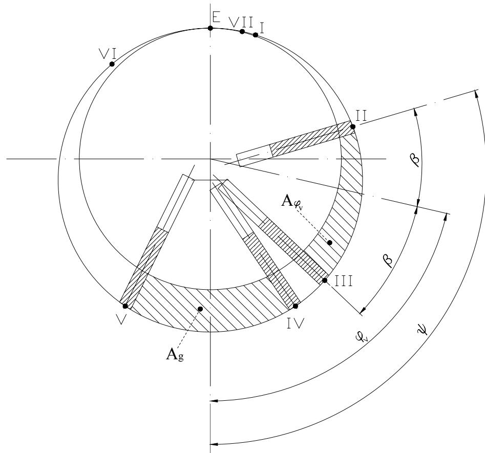
**Slika 27.** Razmještaj kuteva koji označuju položaje radne komore na početku i na kraju kompresije. Na slici se također može uočiti prikaz površina poprečnih presjeka radne komore u ta dva krajnja položaja  $A_g$  i  $A_{\varphi_v}$ .
