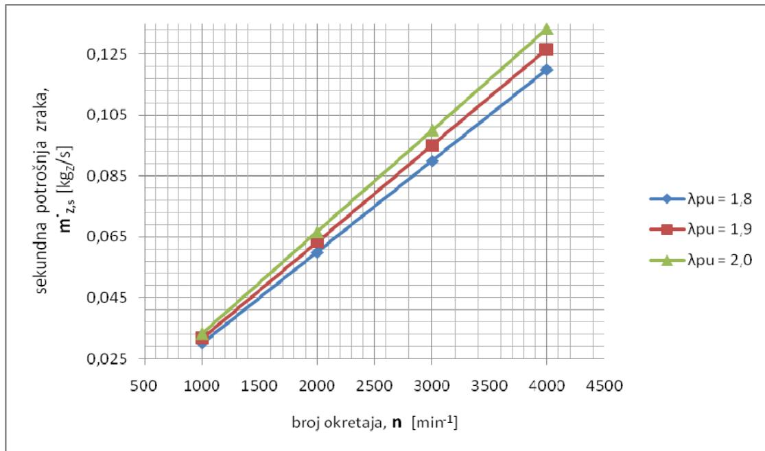
Slika 16. Grafički prikaz promjene specifične efektivne potrošnje zraka [ $\text{kg}/\text{s}$ ] s promjenom brzine vrtnje koljenastaog vratila. Stupanj punjenja je parametarska vrijednost.
