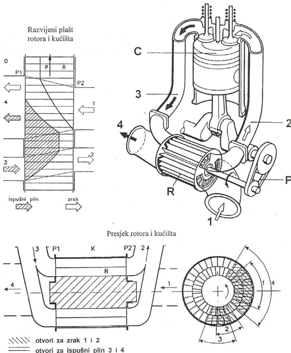
**Slika 4. Comprex:** komprimiranje zraka (2) vrše ispušni plinovi (3) u čelijama rotora (R) a koljenasto vratilo samo okreće rotor, putem prijenosnika (P). Razvodni kanali na kućištu rotora i duljine cijevi trebaju biti međusobno usklađene
