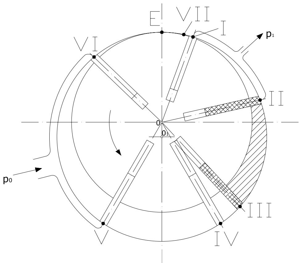
**Slika 21.** Shema kompresora s radijalnim rasporedom lamela na kojoj su pokazani razni položaji lamela tijekom radnog ciklusa
