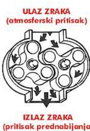
Slika 8. Shematski prikaz rada Rootsovog
