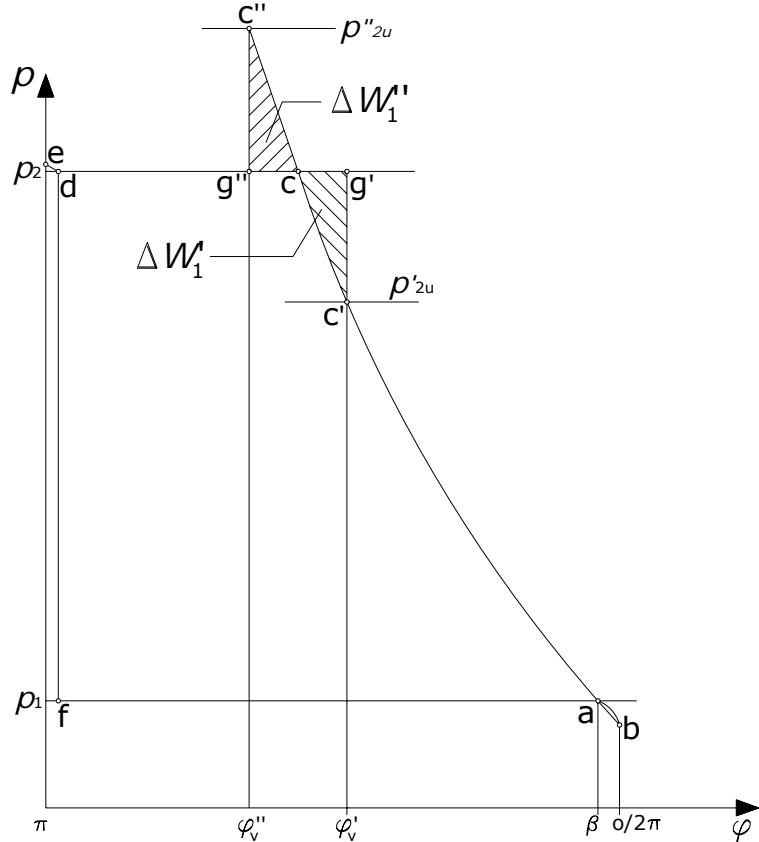
Slika 18. Prilagođavanje višelameljnog kompresora uvjetima tlačnog voda
