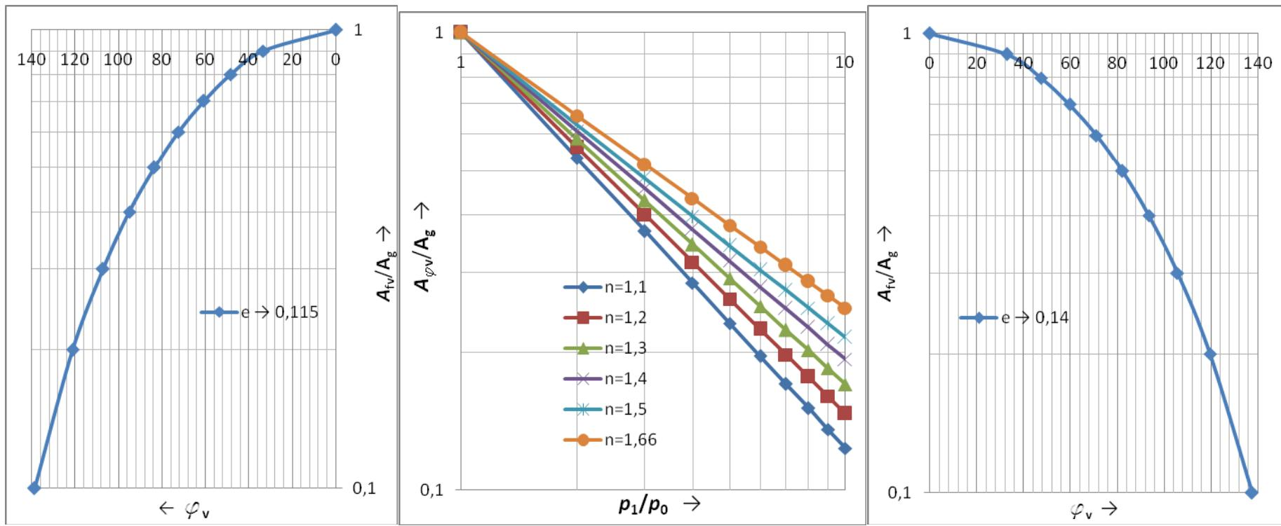
Slika 28. Središnji dijagram predstavlja ovisnost omjera površina presjeka krajnjih položaja radne komore  $A_{\varphi v}/A_g$  o omjeru ulaznog i izlaznog tlaka. Nakon određivanja omjera  $A_{\varphi v}/A_g$ , gleda se da li je ranije utvrđena vrijednost  $\varepsilon$  bliža 0,14 ili 0,115, te se na temelju toga bira jedan od dva okrajna dijagrama da bi se konačno očitao kut  $\varphi_v$ .
