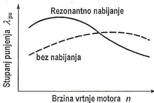
**Slika 2.** Stupanj punjenja kod rezonantnog nabijanja je povećan samo u uskom rezonantnom području brzine vrtnje motora. Izvan toga područja punjenje može biti znatno slabije nego kod nerezonantnog usisa
