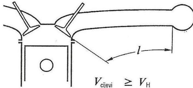
**Slika 1.** Volumen rezonantne usisne cijevi mora biti veći od radnog volumena cilindra. Vlastita frekvencija titranja  $f$  vala duljine  $\lambda$  u plinu u kome je brzina zvuka  $c$  iznosi:  $f = c/\lambda$ . Prema Fialinom rezonantnom modelu za dobro punjenje cilindra duljina cijevi mora biti  $\lambda/4$
