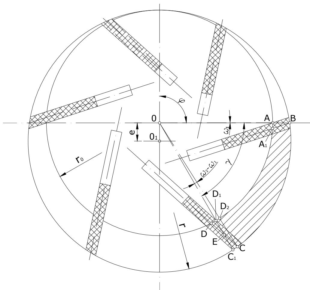
Slika 24. Određivanje površine poprečnog presjeka radne komore
