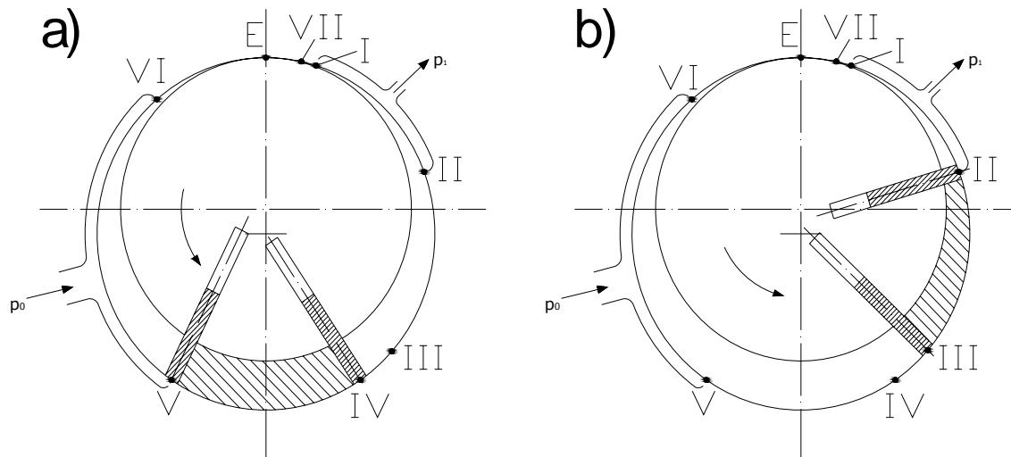
**Slika 23.** Položaj radne komore koju zatvaraju dvije susjedne lamele u prostoru između rotora i statora; a) upočetnom trenutku kada je komora tak formirana; b) krajnji položaj radne komore u trenutku pred početak izlaska komprimiranog zraka
