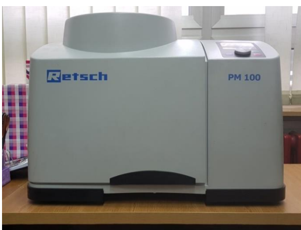
Slika 28. Planetarni kuglični mlin Retsch PM 100 izvana (lijevo gore), iznutra (lijevo dolje te detalj desno)
