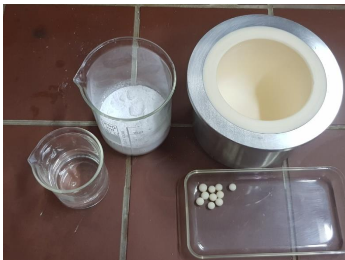
Slika 27. S lijeva na desno: otopljeni disperzant u vodi, prah, posuda, kuglice
