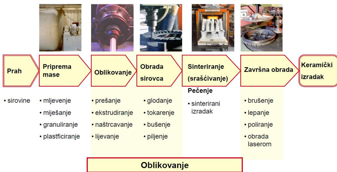
Slika 9. Bitne faze u procesu proizvodnje keramike [7]
