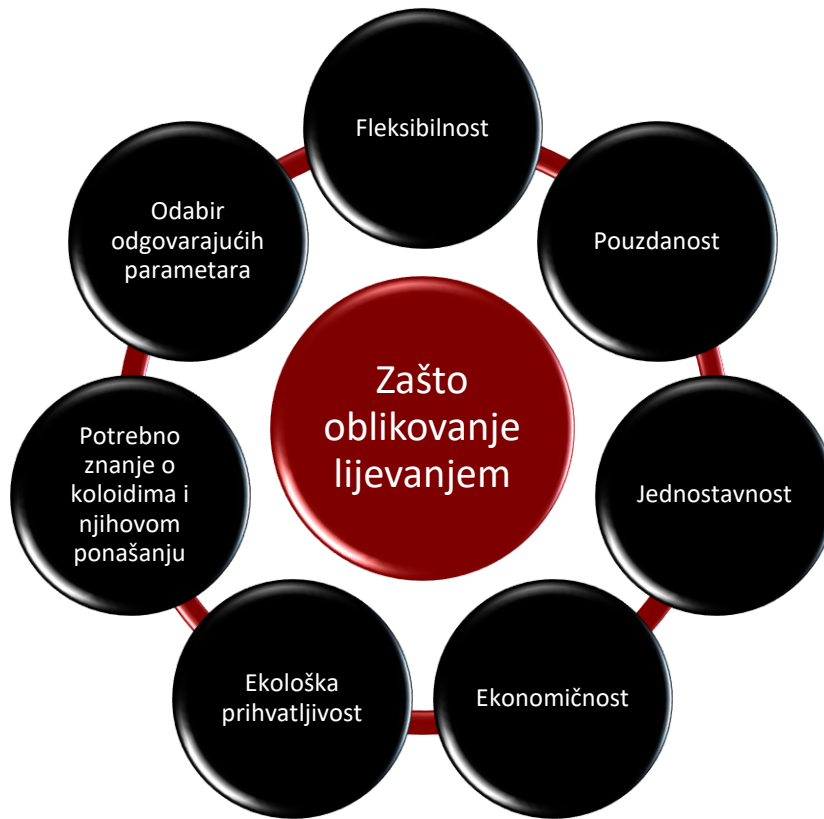
Slika 14. Razlozi primjene oblikovanja keramike lijevanjem suspenzija [prema 23]
