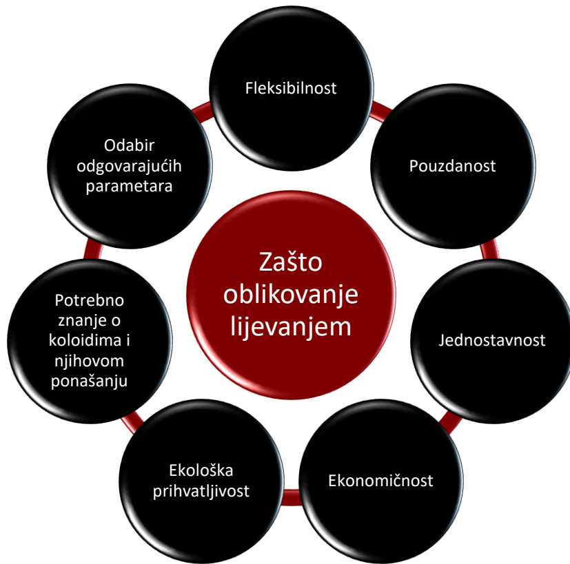
Slika 14. Razlozi primjene oblikovanja keramike lijevanjem suspenzija [prema 23]
