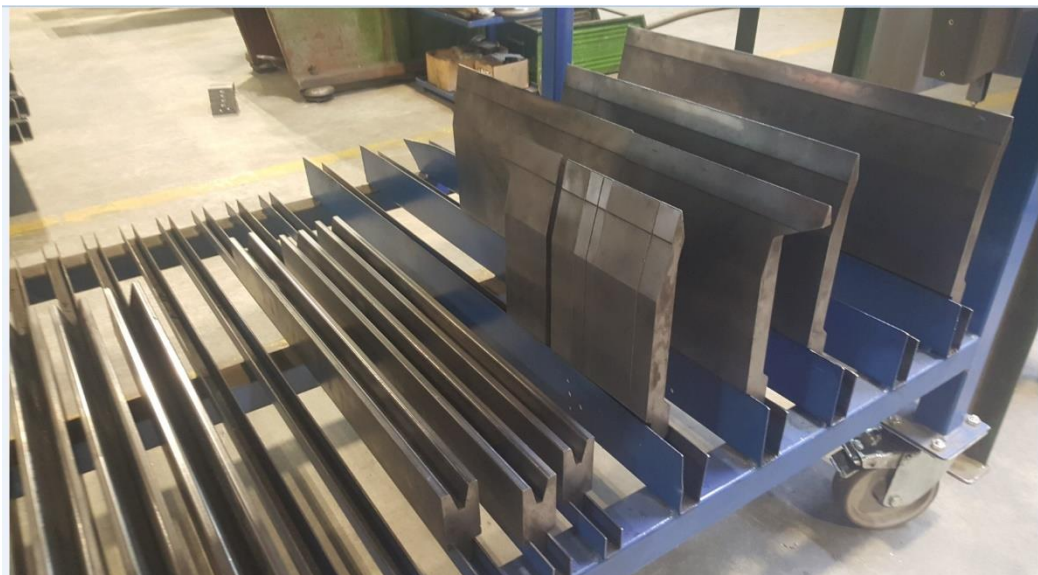
Slika 5.22 Alati - gornji alat "nož" i donji alat "prizma"
