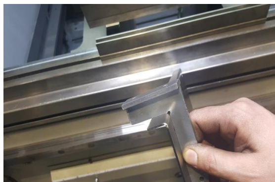
Slika 5.20 Provjera točnosti kuta
