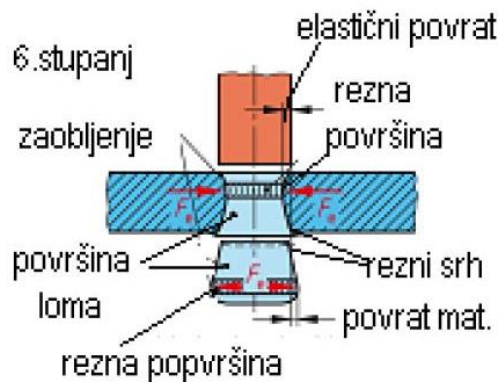
Slika 9. 6. stupanj rezanja na štancama [2]
