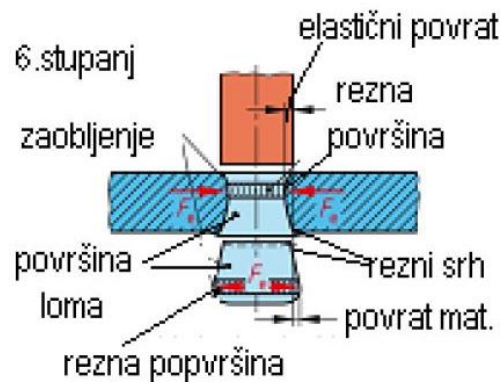
Slika 9. 6. stupanj rezanja na štancama [2]
