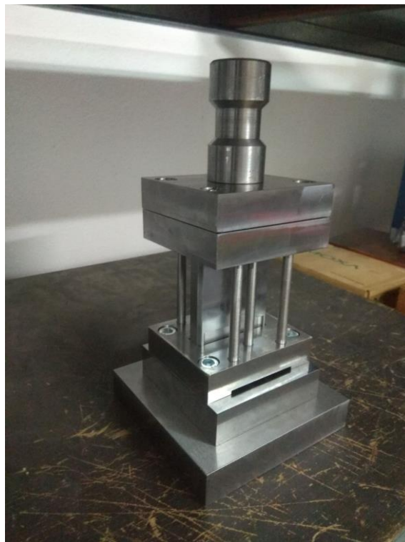
Slika 35. Alat za izradu nosača žice s upinjalom
