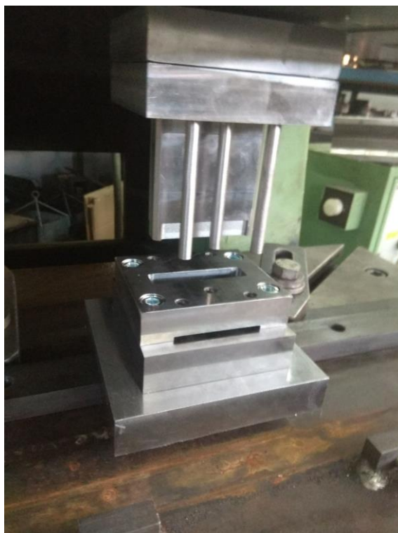
Slika 36. Alat za izradu nosača žice na ekscentar preši EPU - 100
