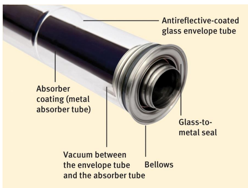
Slika 21. Prijamnik parabolično žljebastog kolektora
