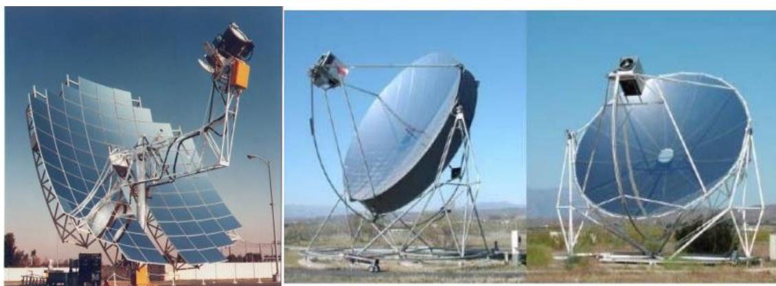
**Slika 30. Različite izvedbe paraboloidnog kolektora**
