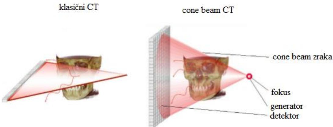
Slika 18. Princip rada CBCT-a [22]
