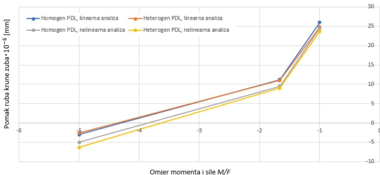
**Slika 51. Dijagrami pomak ruba krune zuba u ovisnosti o promjeni omjera momenta i sile  $M/F$ , te promjene tipa analize**
