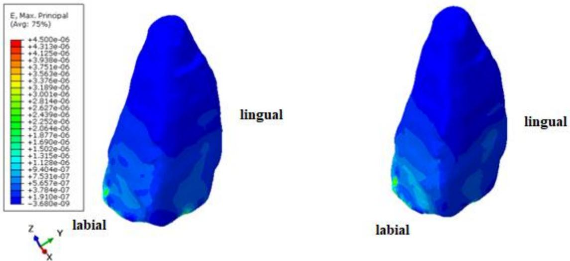
**Slika 41. Raspodjela duljinskih deformacija homogenog i heterogenog PDL-a kod linearne elastične analize,  $M/F = -5/3$**
