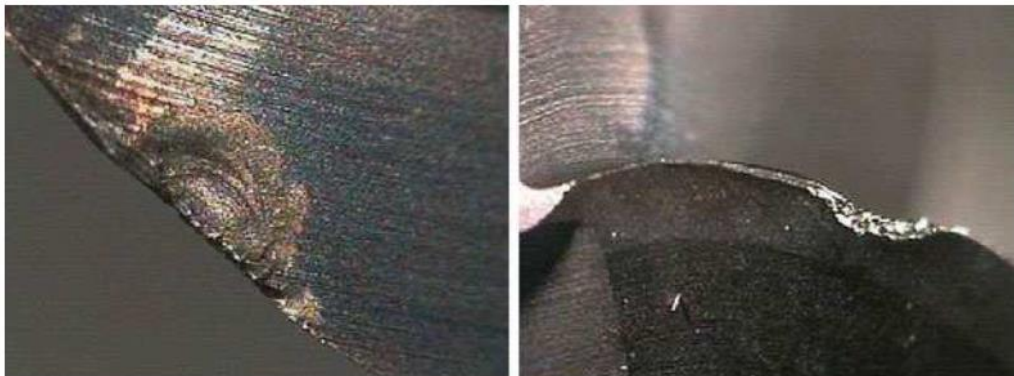
Slika 45. Trošenje glodala nakon obrade zakaljenog čelika [12]
