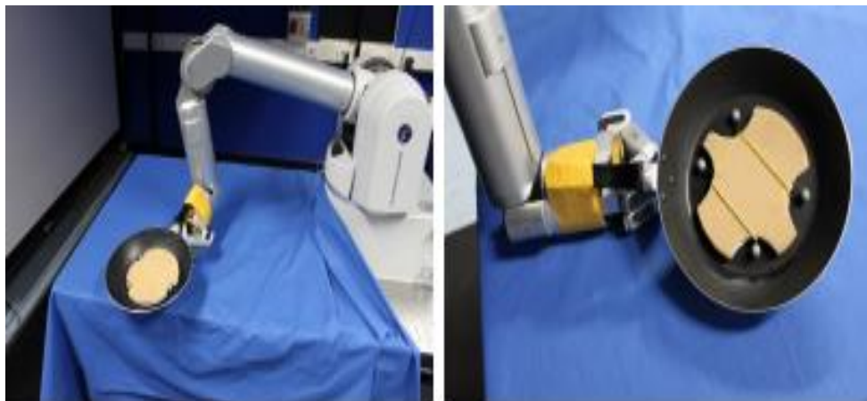
Slika 2 Prikaz momentom kontroliranog Barrett WAM robota naučenog okrenuti palačinku za 180 stupnjeva u zraku i ponovno je uhvatiti [13]
