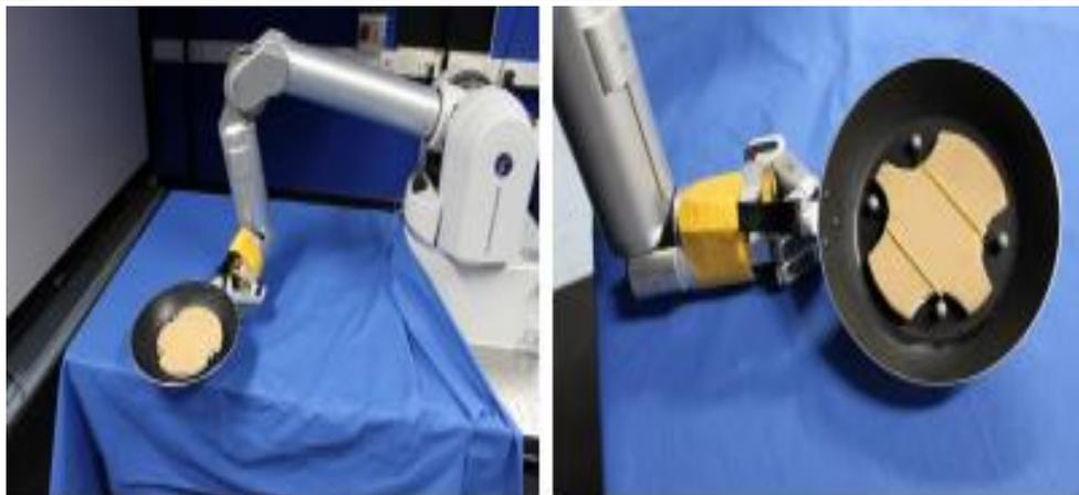
**Slika 2 Prikaz momentom kontroliranog Barrett WAM robota naučenog okrenuti palačinku za 180 stupnjeva u zraku i ponovno je uhvatiti [13]**
