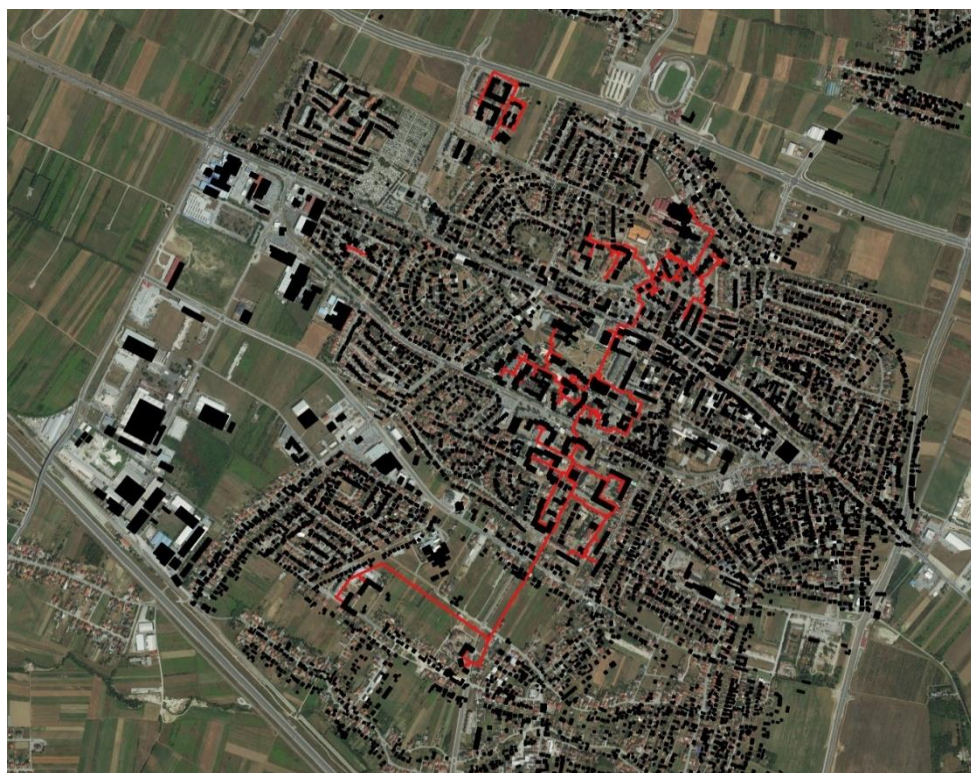
Slika 13 Postojeći vrelovod naselja Velika Gorica
