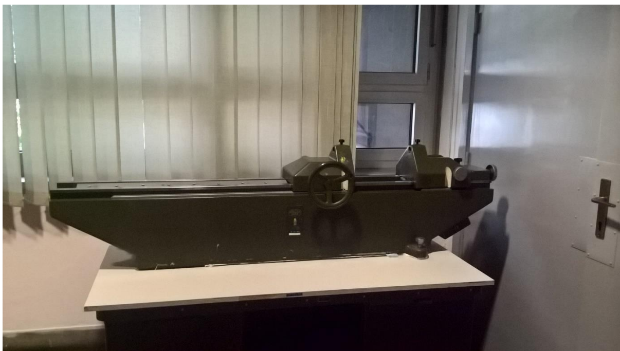
Slika 20. Postojeći jednoosni mjerni uređaj „Carl Zeiss“
