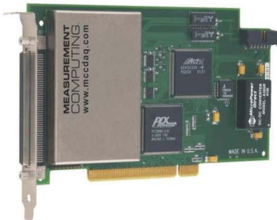
Slika 26. PCI-DAS6034 akvizicijska kartica
