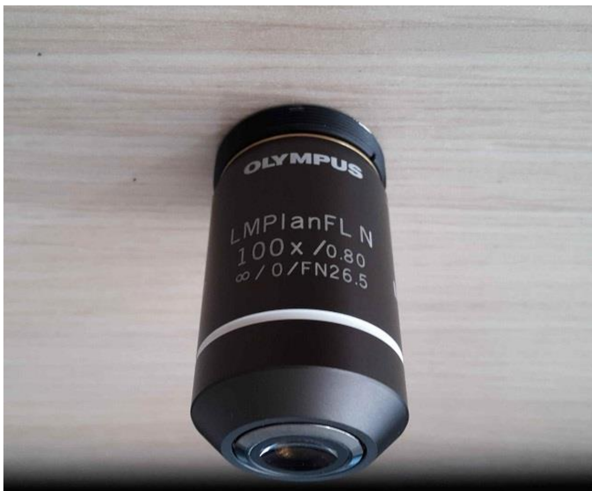
Slika 23. Olympus LMPlanFL N mikroskopski objektiv sa 100x povećanjem
