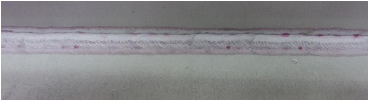
Slika 28. Razvijlač nakon 10 minuta-Uzorak 8
