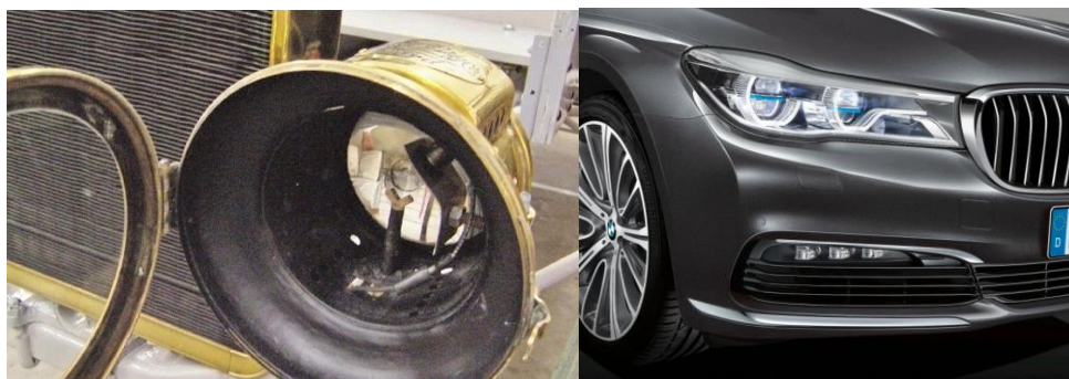
Slika 22: Prikaz acetilenskog i laserskog svjetlosnog sklopa [21]
