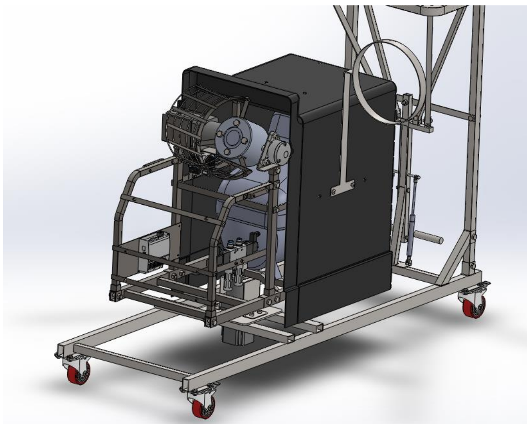
Slika 31. Stroj za automatsko dobacivanje košarkaške lopte – pogled 3
