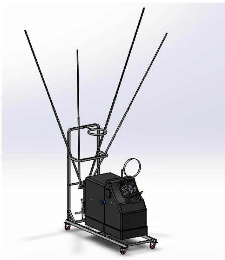
Slika 29. Stroj za automatsko dobacivanje košarkaške lopte – pogled 1
