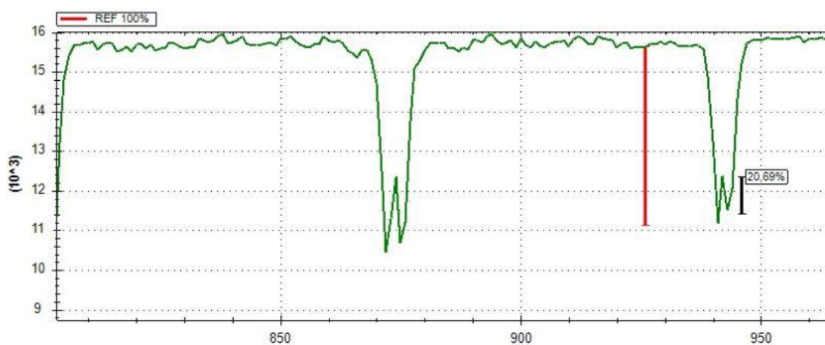
Slika 21. Analiza vrijednosti sivih tonova mjerenih na „duplex“ indikatoru softverskim paketom "Starrview"
