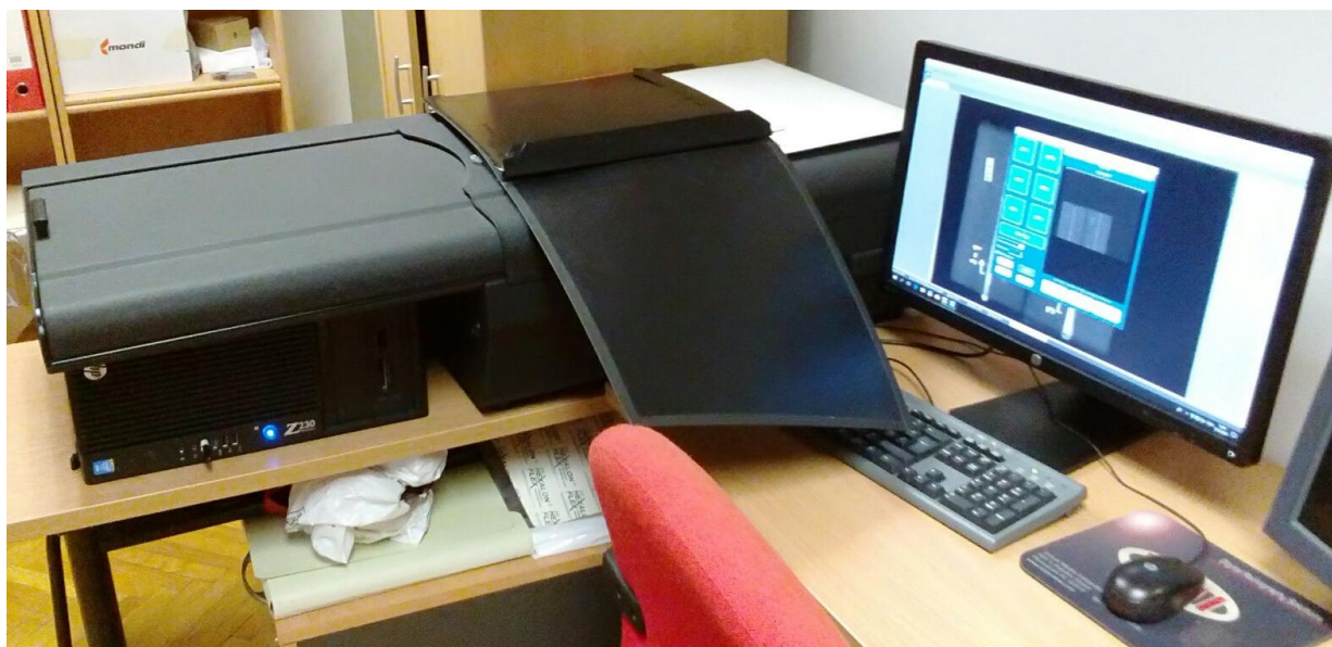
Slika 15. Oprema za skeniranje slikovnih ploča i analizu slikovnih zapisa
