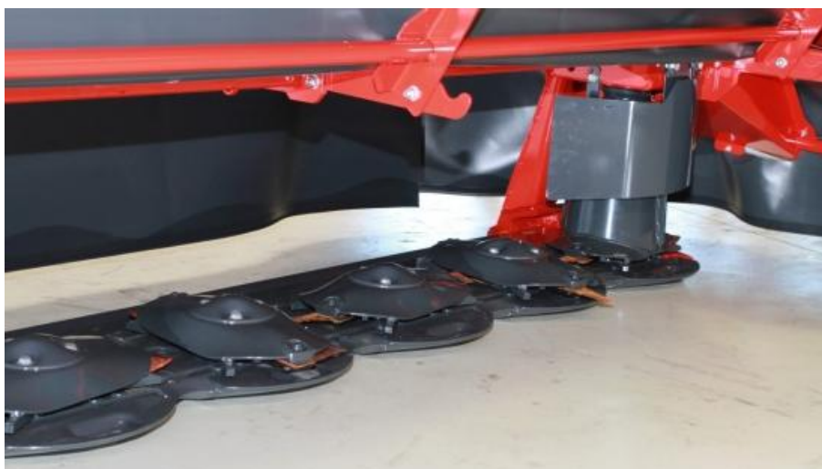
Slika 8 Pogon direktno na prvi disk [8]
