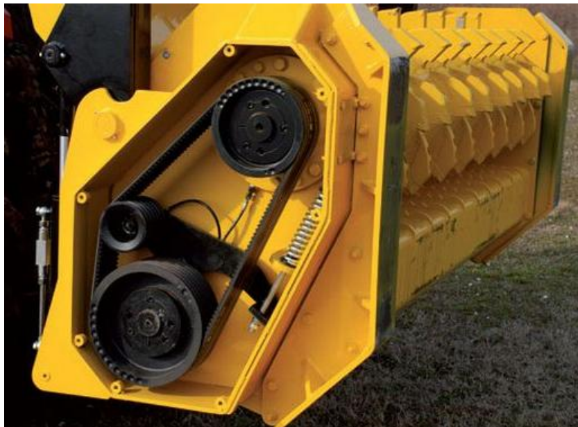
Slika 31 Dvostruki prijenos remenima i automatsko zatezanje remena [9]
