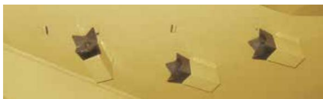
Slika 66 Zubi na unutrašnjosti kućista [12]
