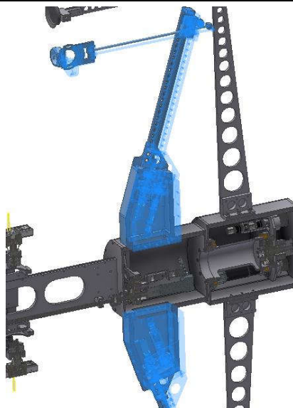
Slika 6.17 Moduli za ispitivanje zavora cijevi i reaktorske posude spojeni na modul translacije 6.2.5. Modul rotacije
