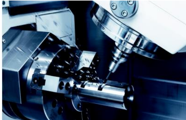
Slika 10. Primjer "4+1" petoosne obrade [9]
