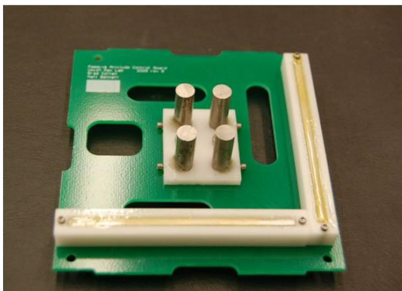
Slika 6: Komponente za pasivnu magnetsku stabilizaciju nanosatelita RAX-1 [13]
