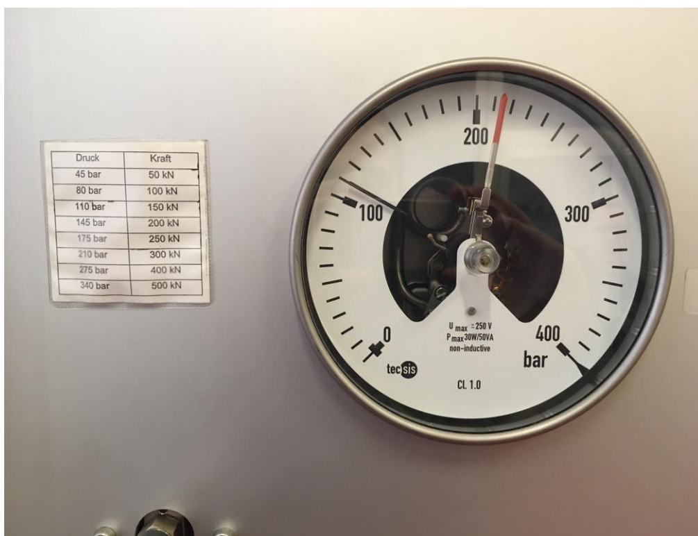
Slika 23 Mjerna skala za ograničenje opterećenja
