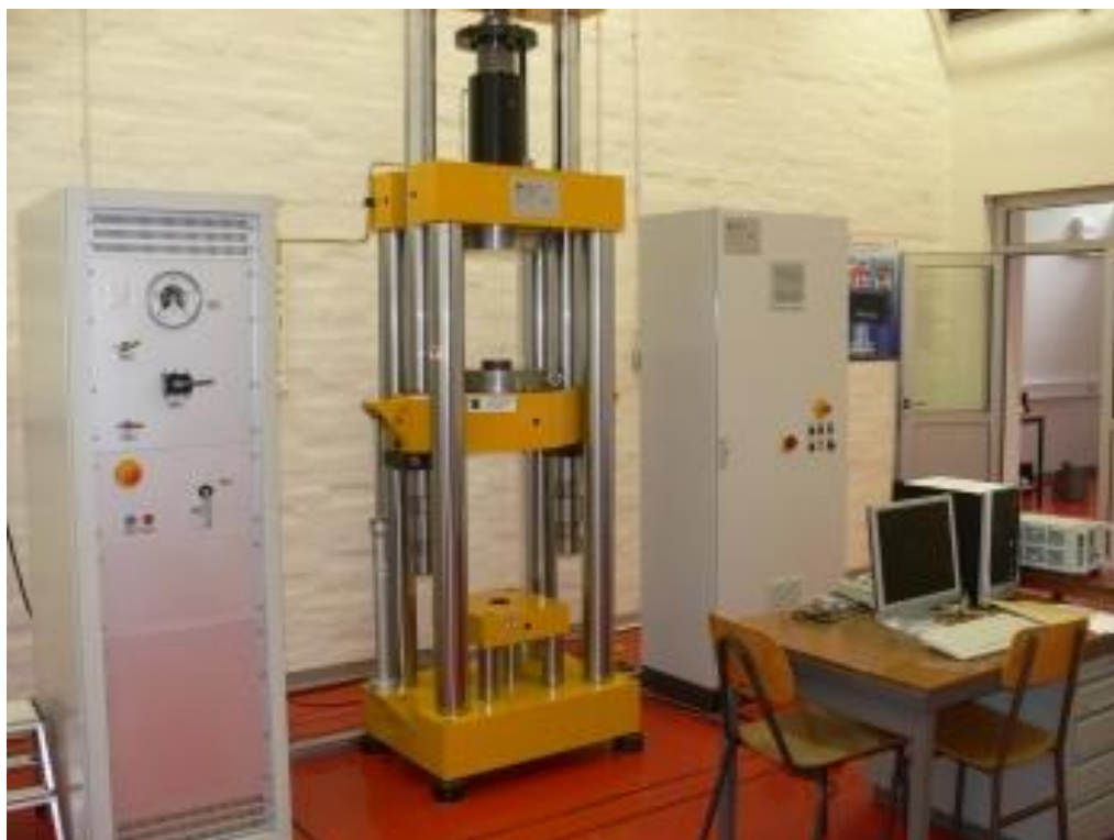
Slika 14 Referentni etalon sile LIMS-a [16]
