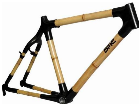
Slika 17. Okvir bicikla od bambusa [37]
