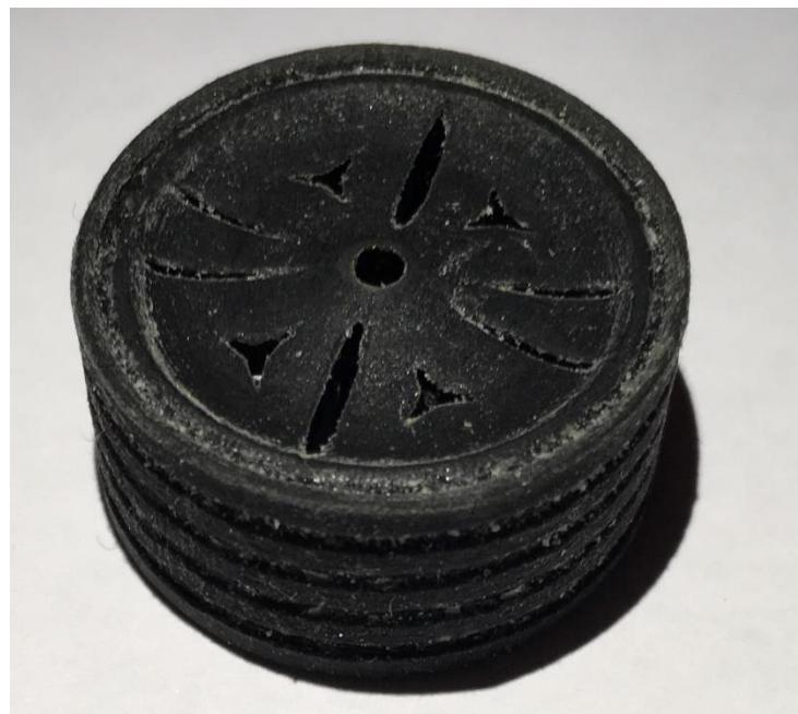
Slika 4.20. Pogrešna orijentacija na radnoj podlozi stroja
