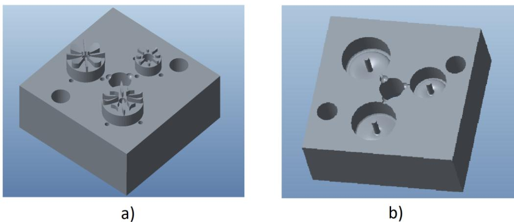
Slika 4.21. Modeli dijelova kalupa za injekcijsko prešanje: a) pomicni dio, b) nepomicni dio
