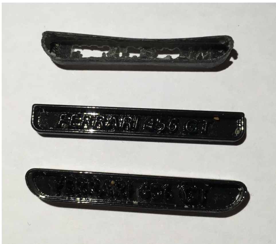
Slika 4.18. Pogrešan oblik i dimenzije prednje maske – kronološki slijed konstruiranja
