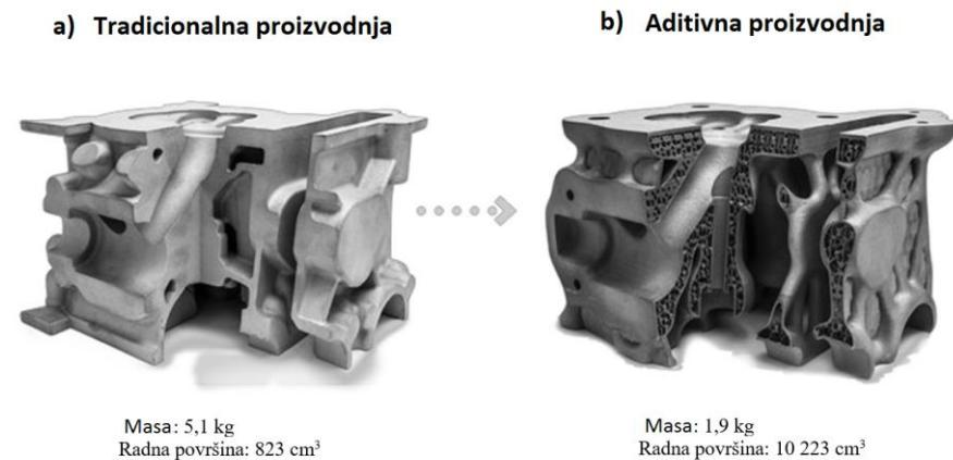
Slika 2.20. Usporedba: a) tradicionalne proizvodnje i b) aditivne proizvodnje [34]
