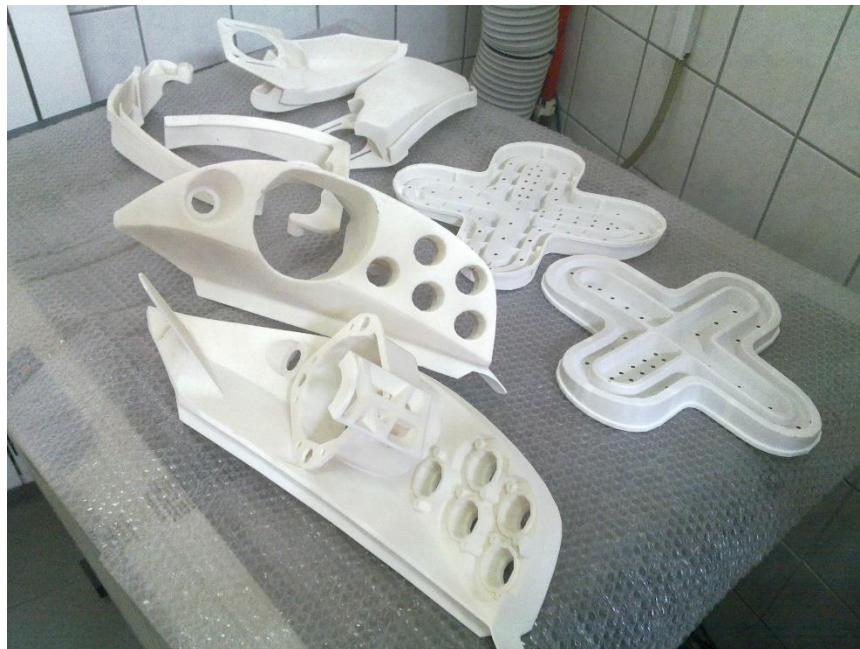
Slika 3.4. Prednji i zadnji nosači za svjetla (neobrađeni)
