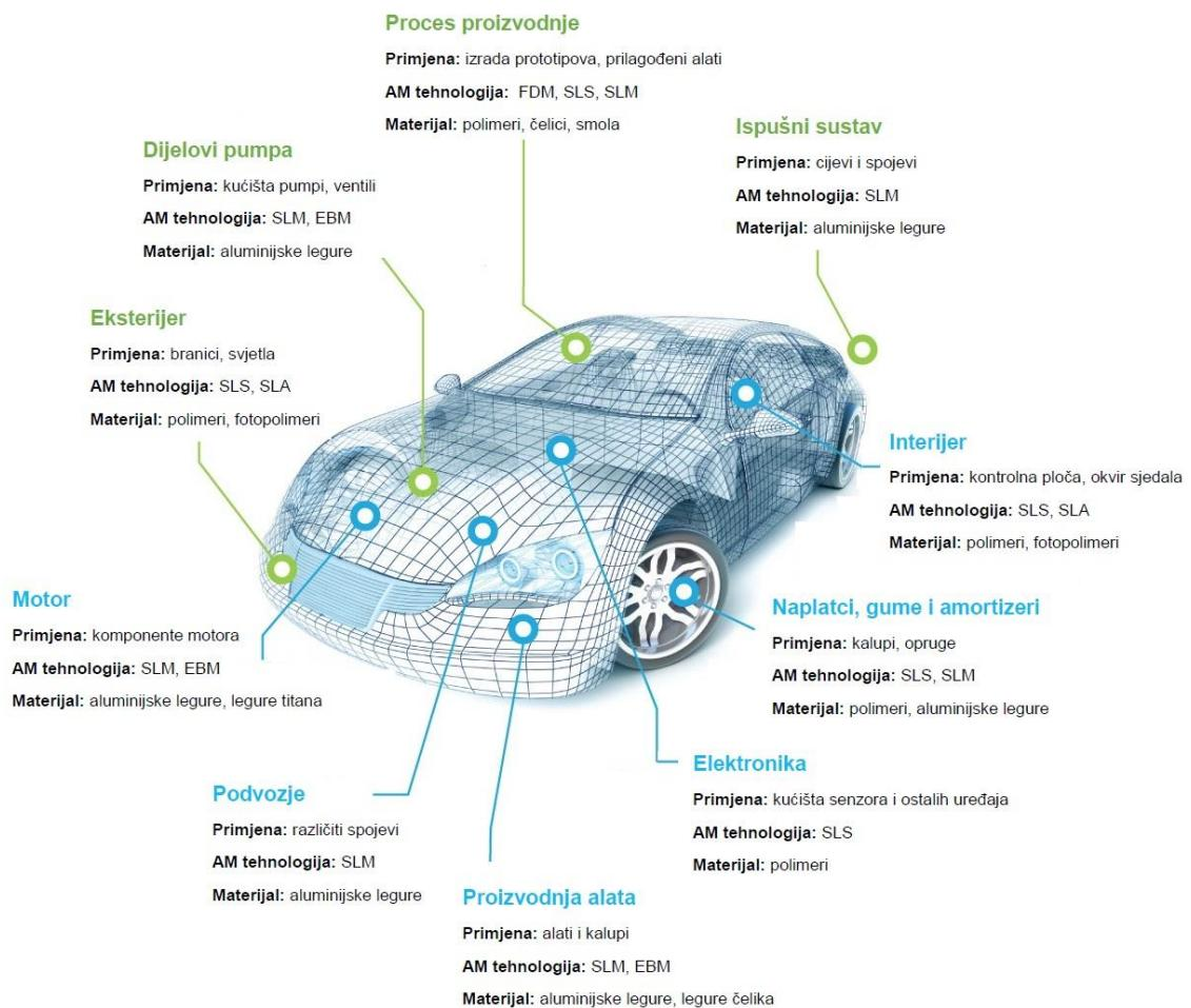
Slika 2.6. Prikaz primjene AM postupaka kod proizvodnje automobila [25]
