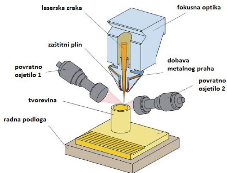
Slika 1.19. Postupak izravnog taloženja metalnog praha (DMD) [7]
