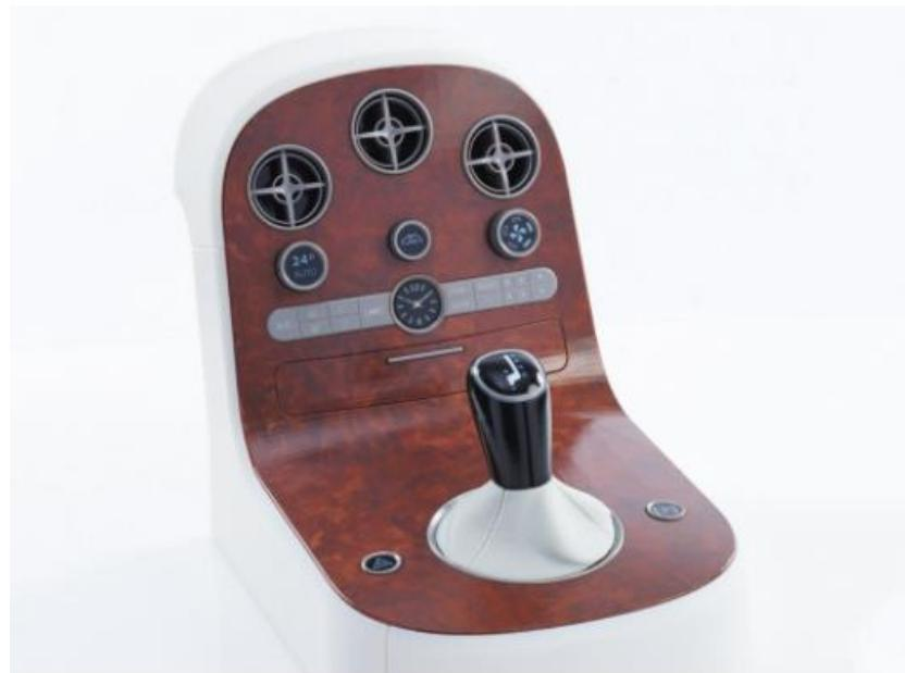
Slika 2.27. Okvir upravljačke ploče (postupak PolyJet) [20]
