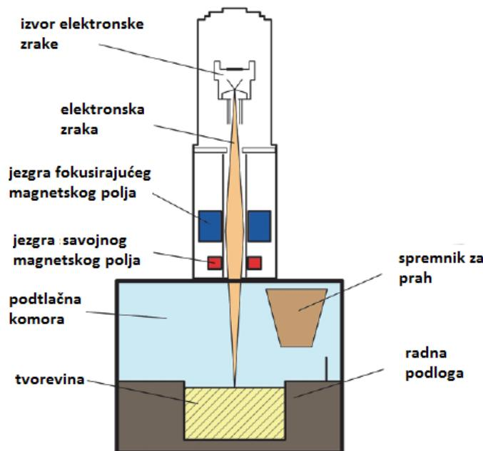
Slika 1.18. Postupak taljenja s pomoću snopa elektrona (EBM) [7]
