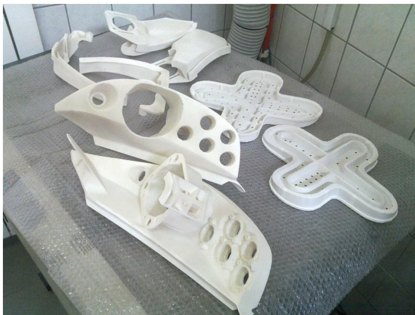
Slika 3.4. Prednji i zadnji nosači za svjetla (neobrađeni)
