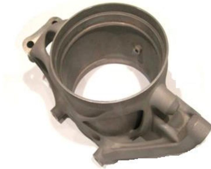
Slika 2.26. Ovjes kotača (postupak DMLS) [38]
