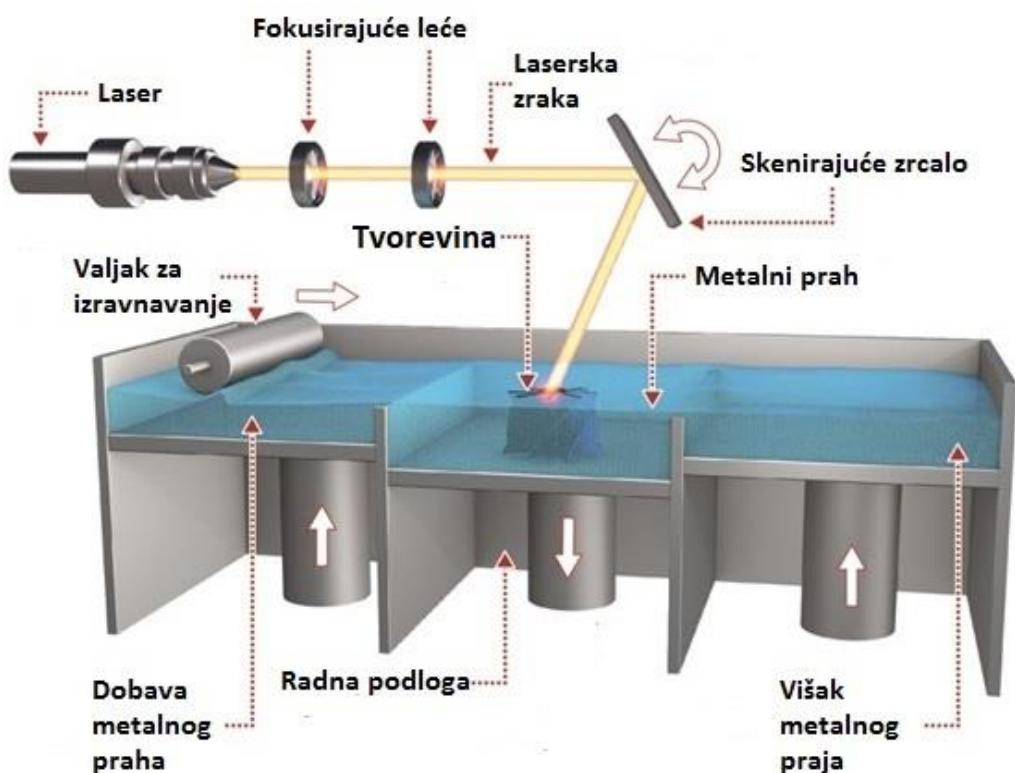
Slika 1.15. Postupak selektivnog laserskog taljenja (SLM) [8]
