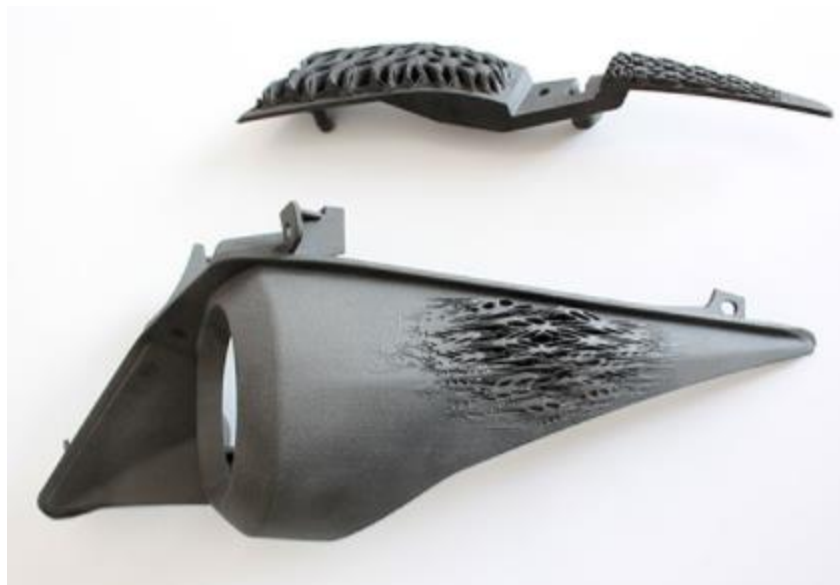
Slika 2.28. Posebno dizajnirano prednje svjetlo motocikla (postupak SLS) [39]
