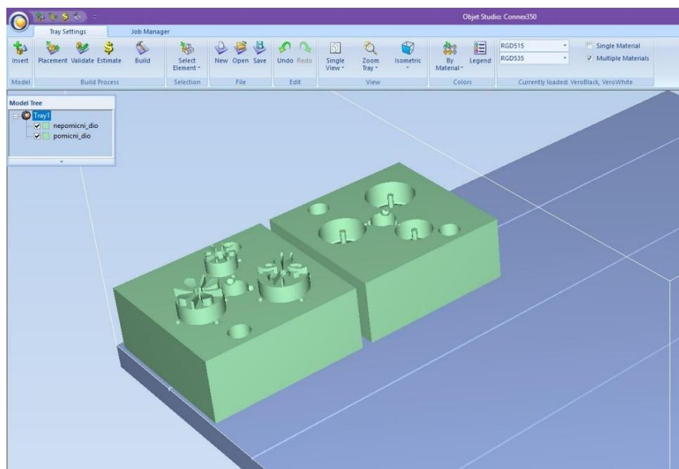
Slika 4.22. Modeli dijelova kalupa na radnoj podlozi stroja
