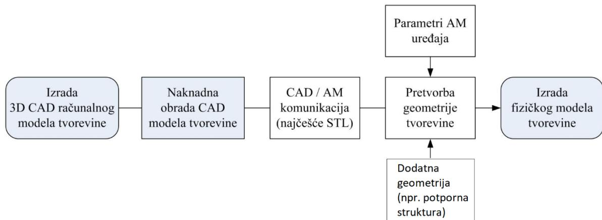
Slika 1.8. Tok podataka u aditivnoj proizvodnji [4]
