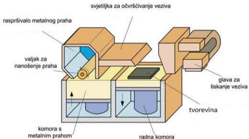
Slika 1.16. Postupak 3D tiskanja metala (postupak ProMetal) [3]
