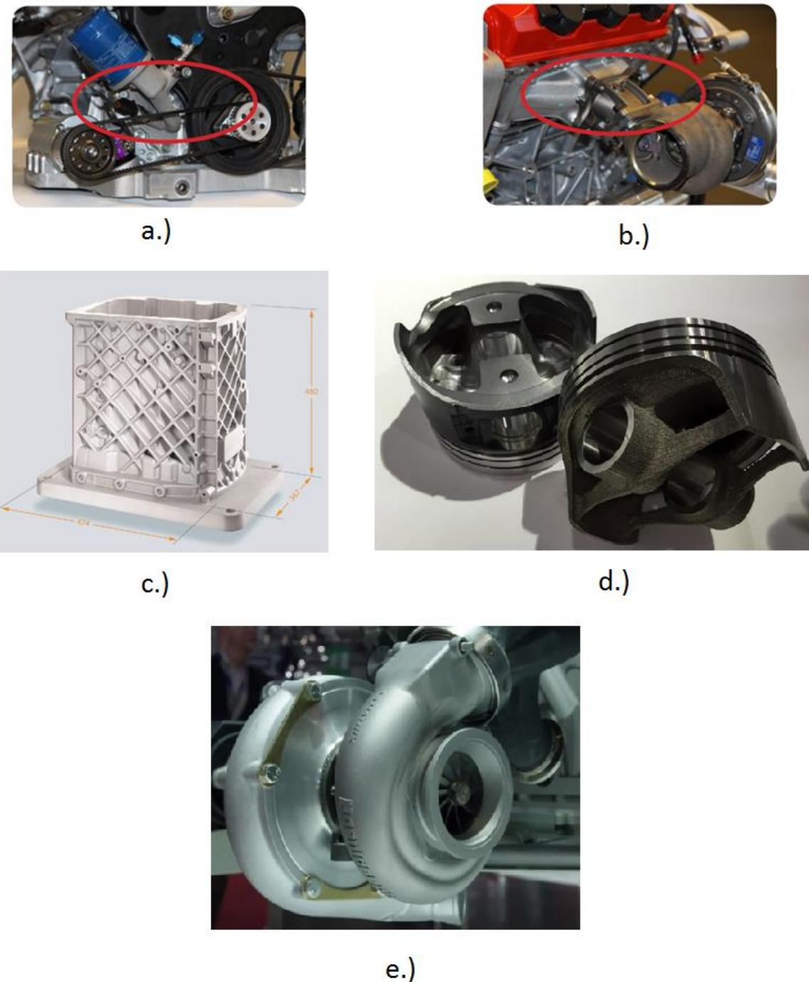
Slika 2.41. Dijelovi motora: a.) kućište uljnog filtera [68], b.) ispušni razvodnik [68], c.) kućište mjenjača [46], d.) klip motora [69], e.) turbo punjač motora [70]
