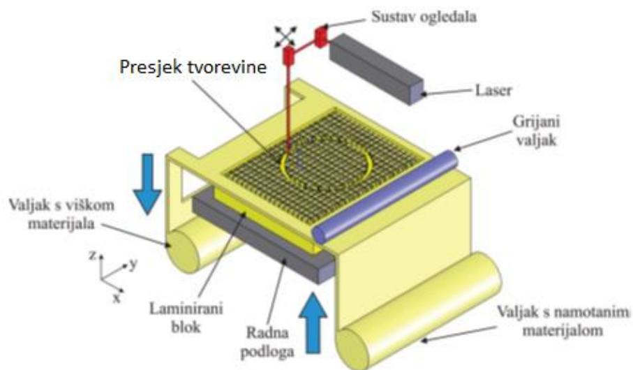
Slika 1.13. Postupak proizvodnje laminiranih objekata (LOM) [2]
