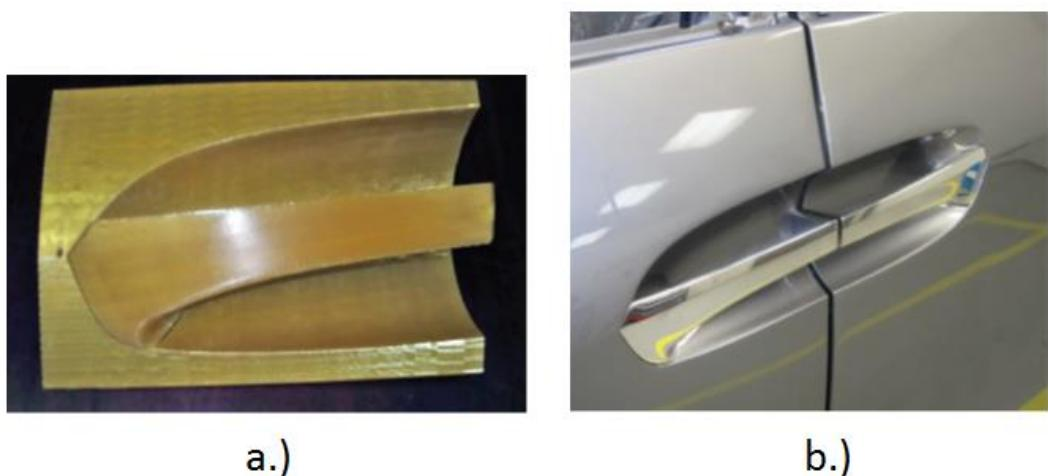
Slika 2.40. Prototip kvake automobila : a.) prototip (FDM), b.) konačan proizvod [44]
