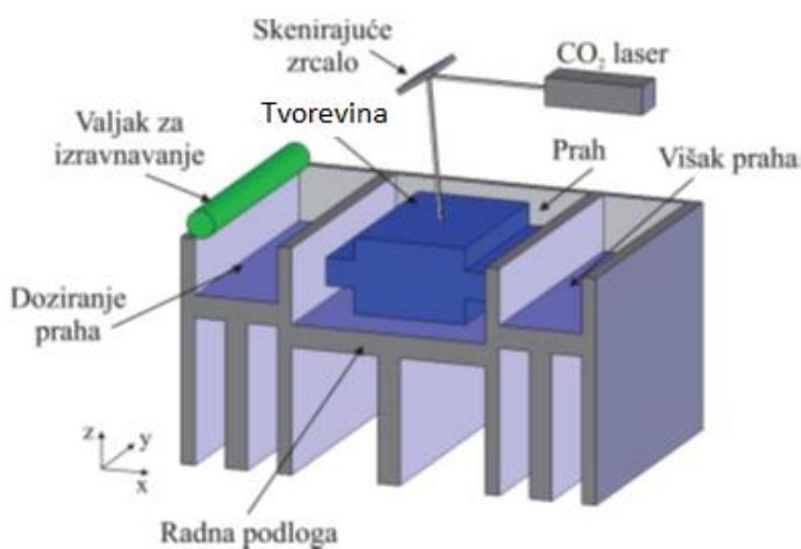
Slika 1.14. Postupak selektivnog laserskog srašćivanja (SLS) [2]
