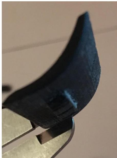
Slika 4.19. Nedovoljna duljina nosača zadnjeg spojlera
