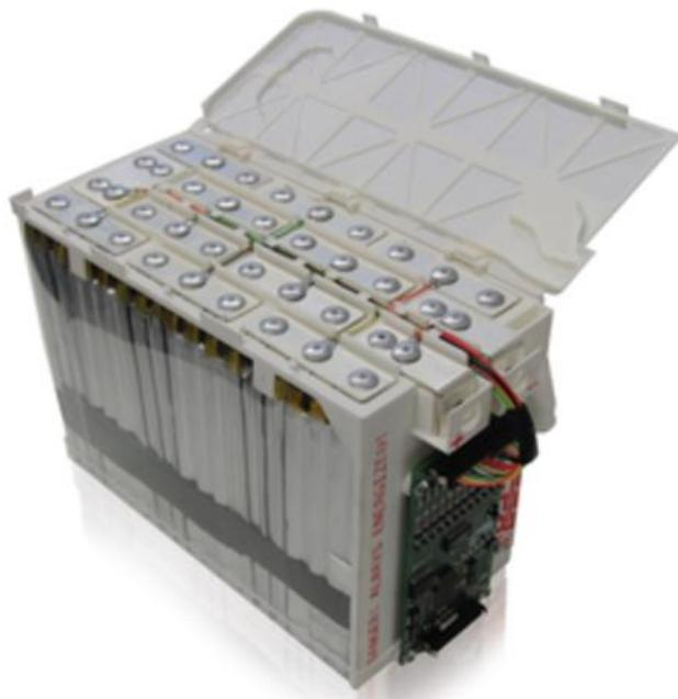
Slika 2.21. Zaštitno kućište baterije električne formule iz PA12 materijala (postupak SLS) [35]
