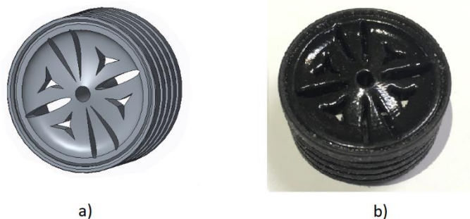
Slika 4.7. Treći model naplatka i gume za oba tipa automobila: a) 3D CAD model, b) 3D tiskani model
