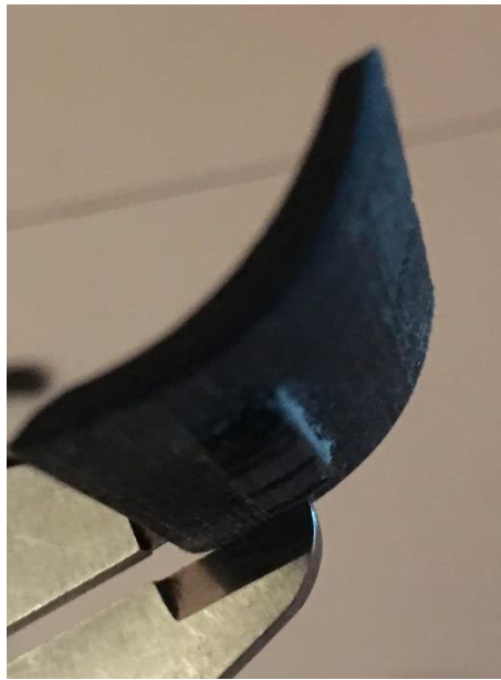
Slika 4.19. Nedovoljna duljina nosača zadnjeg spojlera
