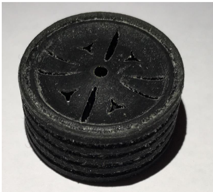
Slika 4.20. Pogrešna orijentacija na radnoj podlozi stroja
