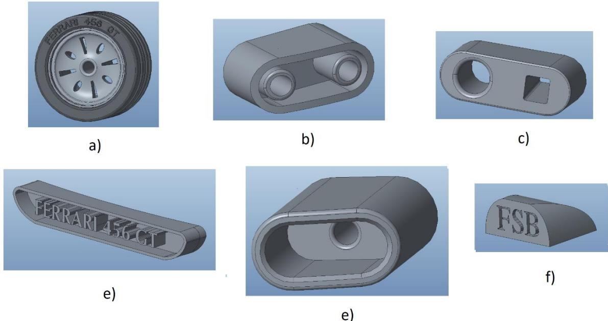
Slika 4.6. Modeli dijelova za *Ferrari 456 GT* : a) naplatak s gumom, b) zadnje svjetlo, c) prednje maglenke, d) prednja maska, e) auspuh, f) krovni spojler
