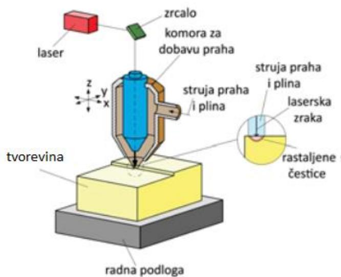
Slika 1.17. Postupak izravnog taloženja metala (LENS) [7]
