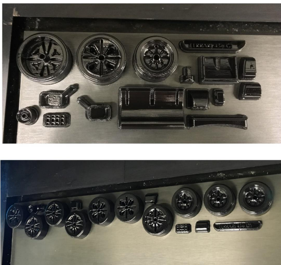
Slika 4.10. Dijelovi tijekom izrade na radnoj podlozi stroja
