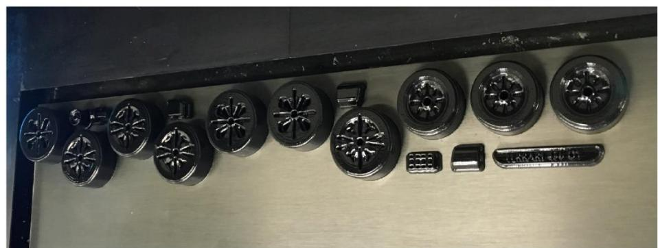
Slika 4.10. Dijelovi tijekom izrade na radnoj podlozi stroja
