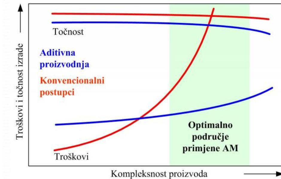
Slika 1.2. Usporedba konvencionalnih postupaka s aditivnim postupcima [3]
