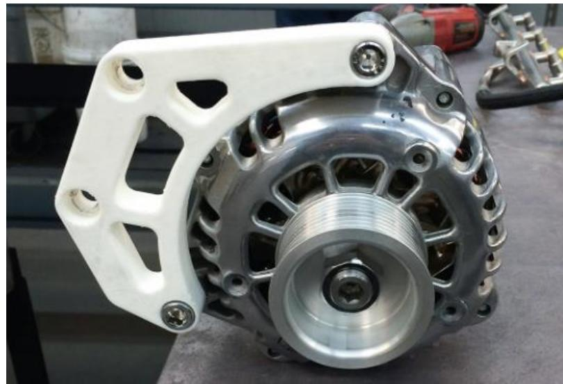
Slika 2.25. Nosač alternatora (postupak SLS) [20]
