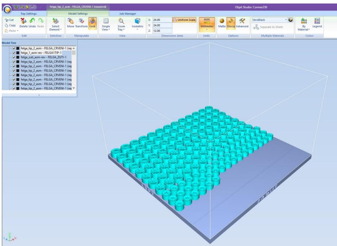
Slika 4.24. 50 kompleta različitih naplatka na radnoj podlozi
