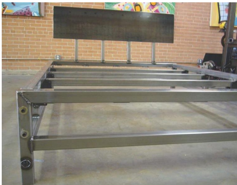
Slika 23. Zavareni nosivi okvir kreveta
