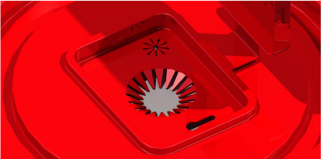
Slika 6.8. Otvor za odlaganje medicinskih oštrica
