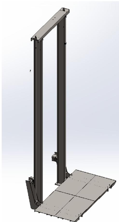
**Slika 8-5 Nosači sa pozicioniranom kabinom bez zaštitnih ograda te pozicioniranim vretenima**
