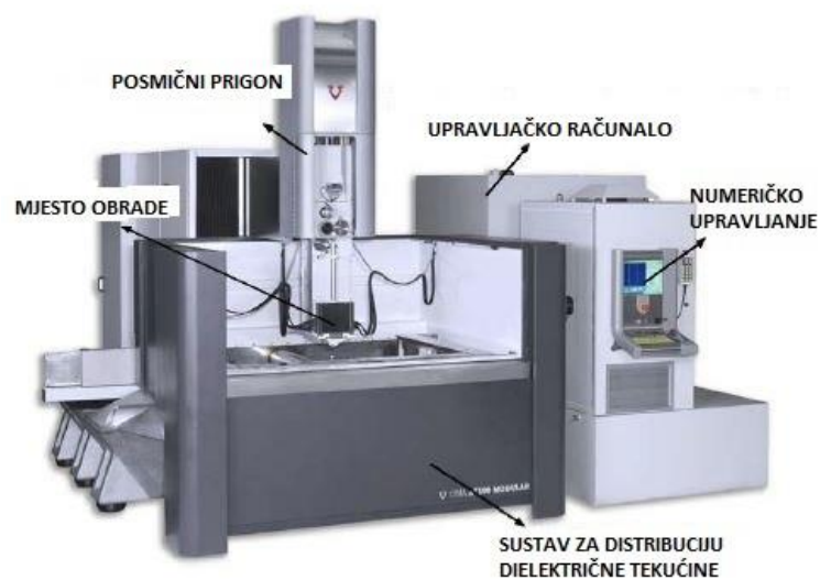
Slika 26. Elementi elektroerozijskog uređaja [2]
