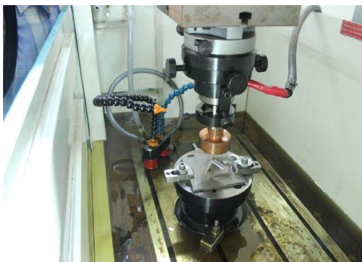
Slika 19 Primjer radnog stola uređaja za elektroerozijsku obradu žigom [9]
