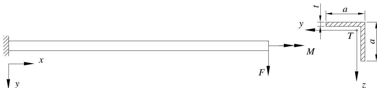
Slika 4.8. Uklještenu greda opterećena na savijanje i uvijanje
