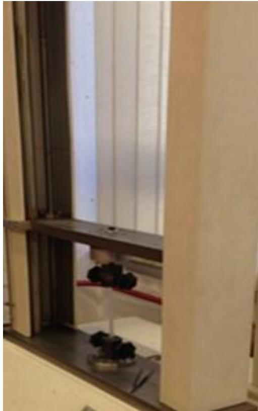
Slika 28. Uređaj za ispitivanje vlačne čvrstoće i istezljivosti
