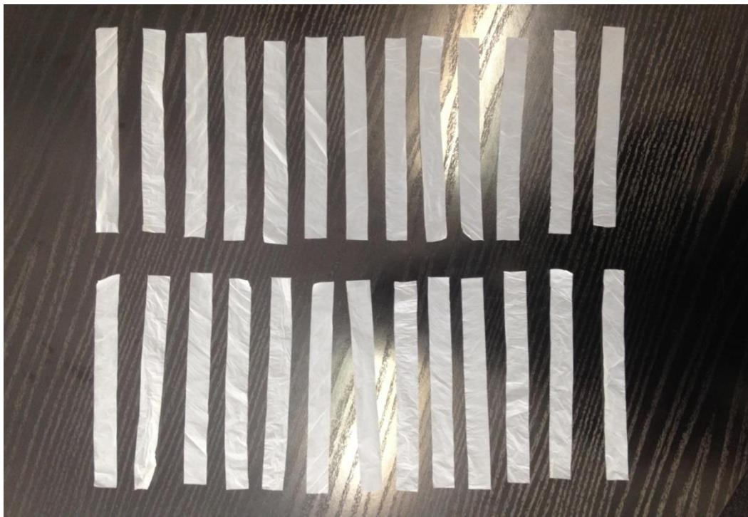
Slika 27. Izrezane epruvete za ispitivanje vlačne čvrstoće i istezljivosti sukladne normi
