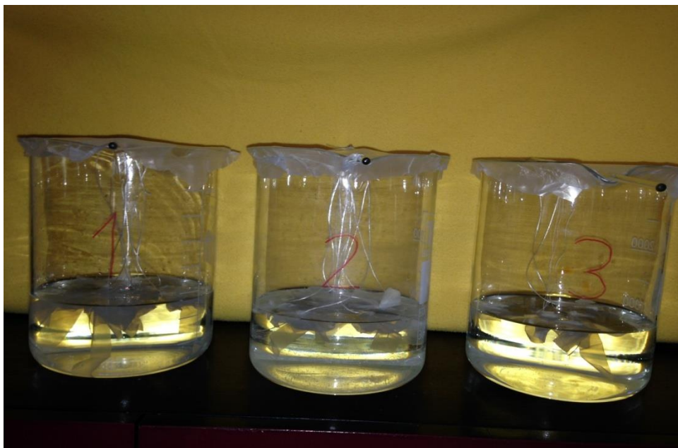
Slika 21. Uzorci uronjeni u pripremljenu morsku otopinu
