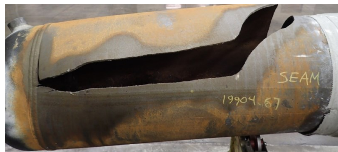
Slika 4. Krhki lom posude pod tlakom [3]
