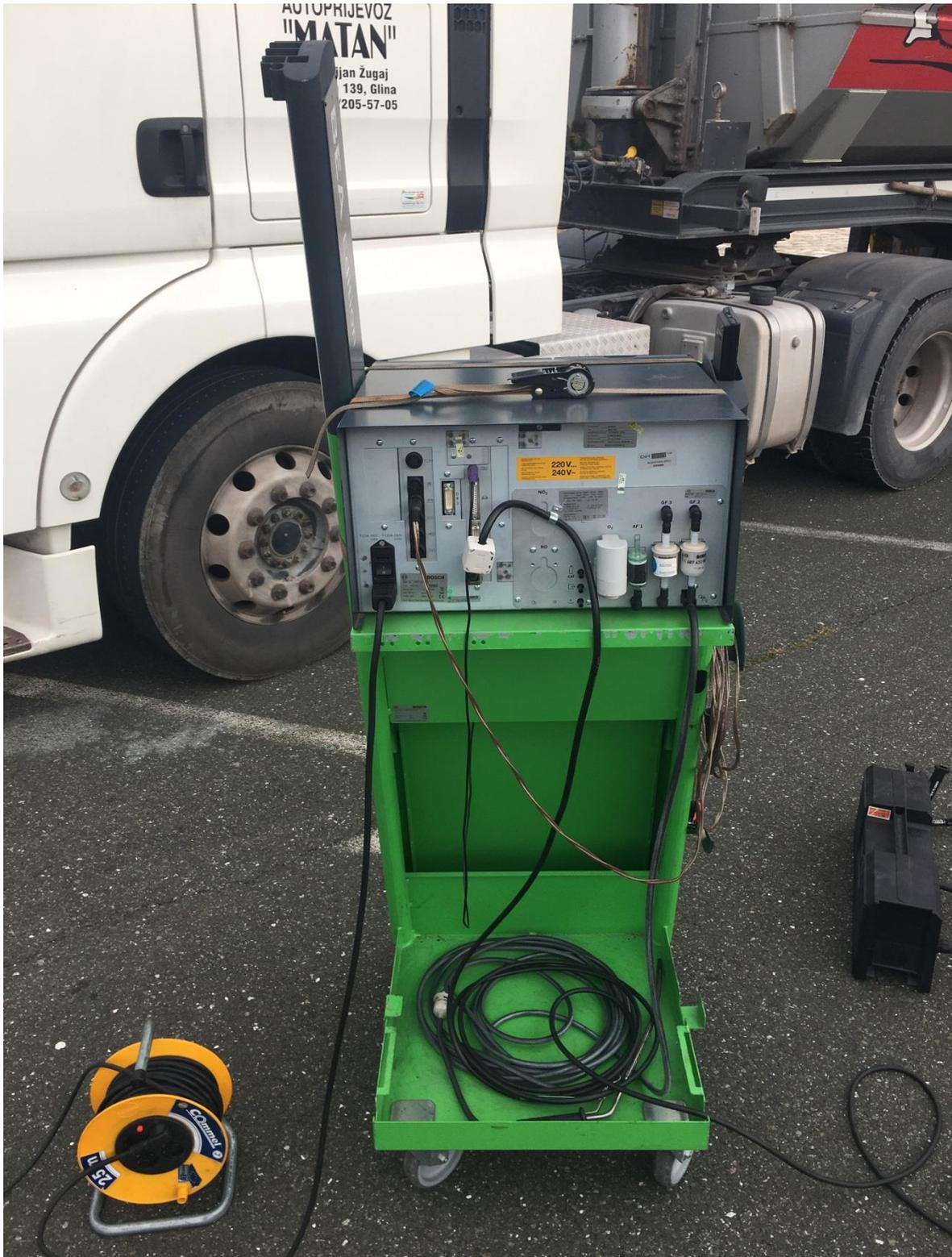
*Slika 4.4. Analizator ispušnih plinova*
