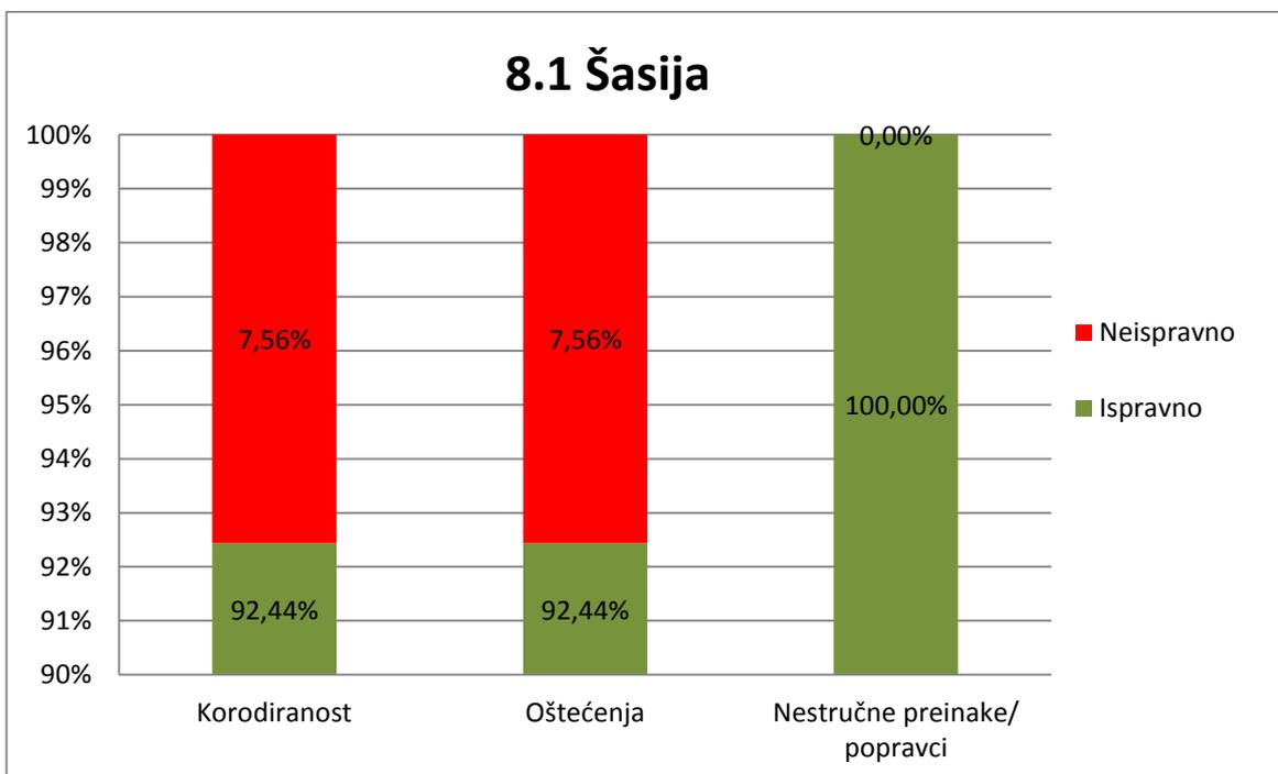
Slika 5.3. Dijagram neispravnosti pojedinih podsklopora za šasiju
