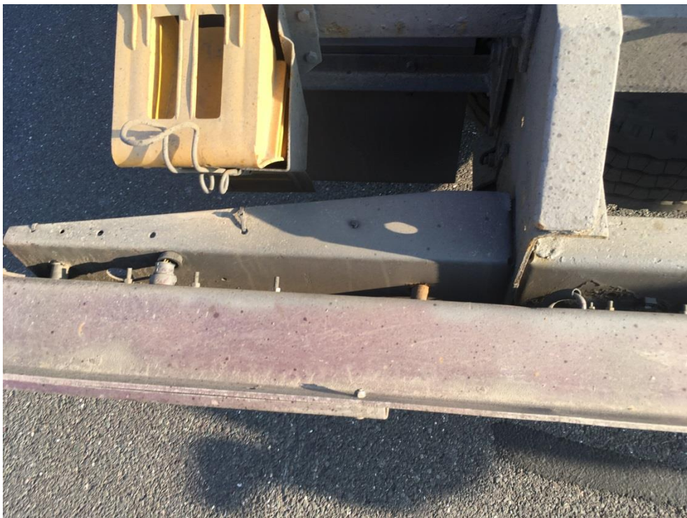
Slika 4.9. Prikaz savijenog zadnjeg odbojnika i popucanih vijaka
