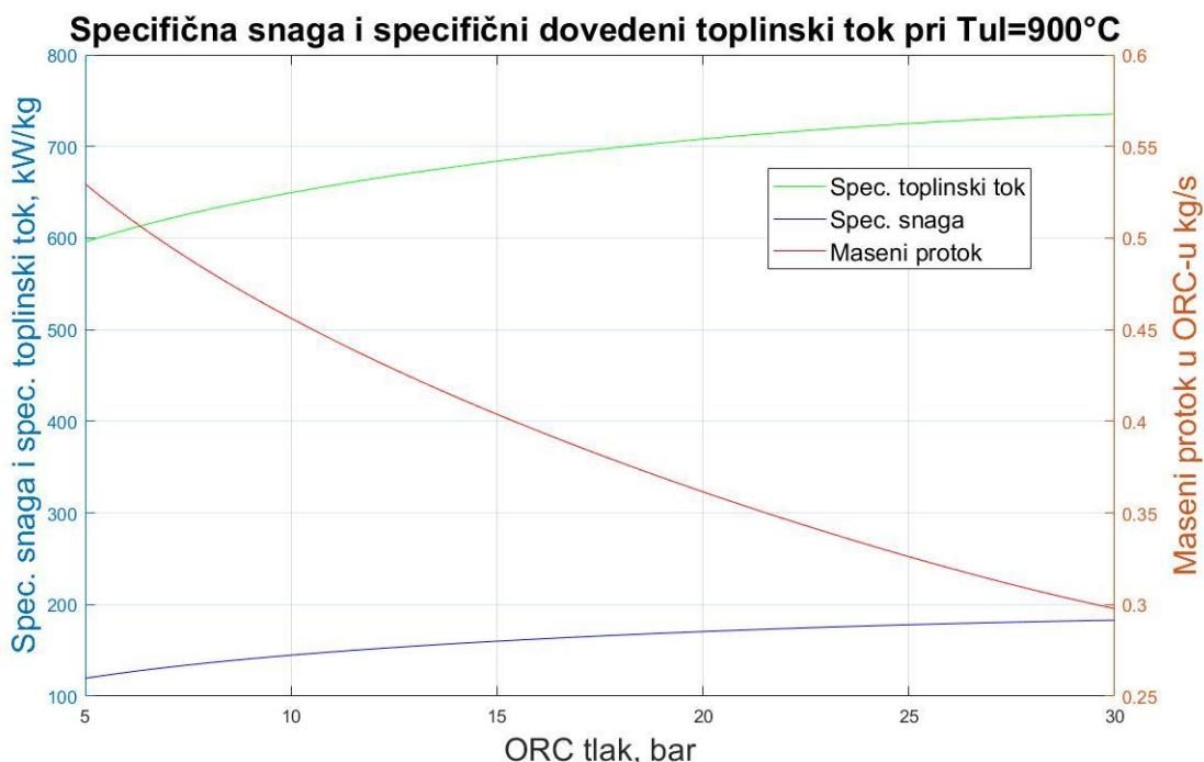
Slika 14. Ovisnost specifične snage, specifičnog toplinskog toka i masenog protoka o radnom tlaku u ORC-u (toluen)
