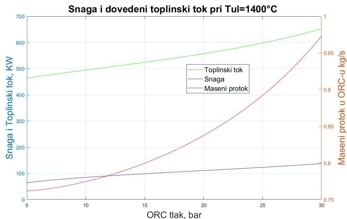
**Slika 28.** Ovisnost snage, toplinskog toka i masenog protoka o radnom tlaku u ORC-u (aceton)
