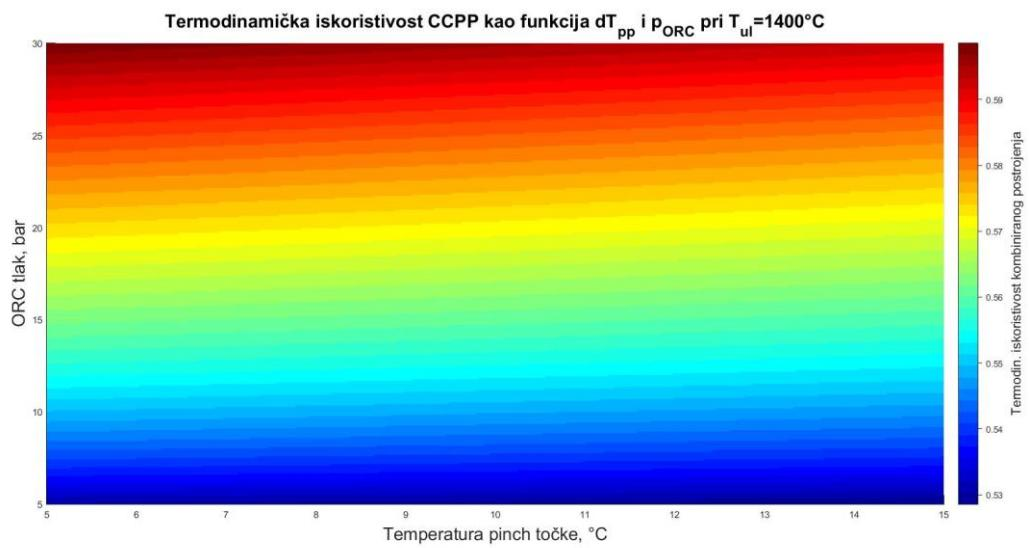
**Slika 33. Termodinamička iskoristivost kombiniranog postrojenja u ovisnosti o radnom tlaku ORC-a i temperaturi pinch točke u isparivaču (aceton)**
