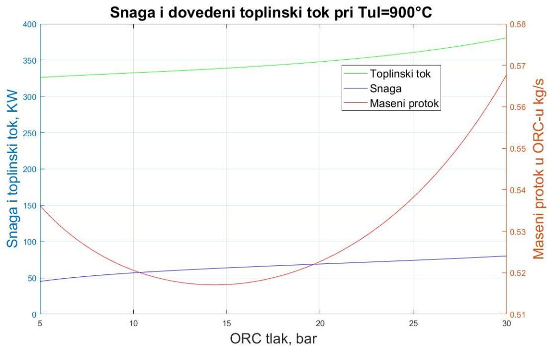
Slika 24. Ovisnost snage, toplinskog toka i masenog protoka o radnom tlaku u ORC-u (aceton)
