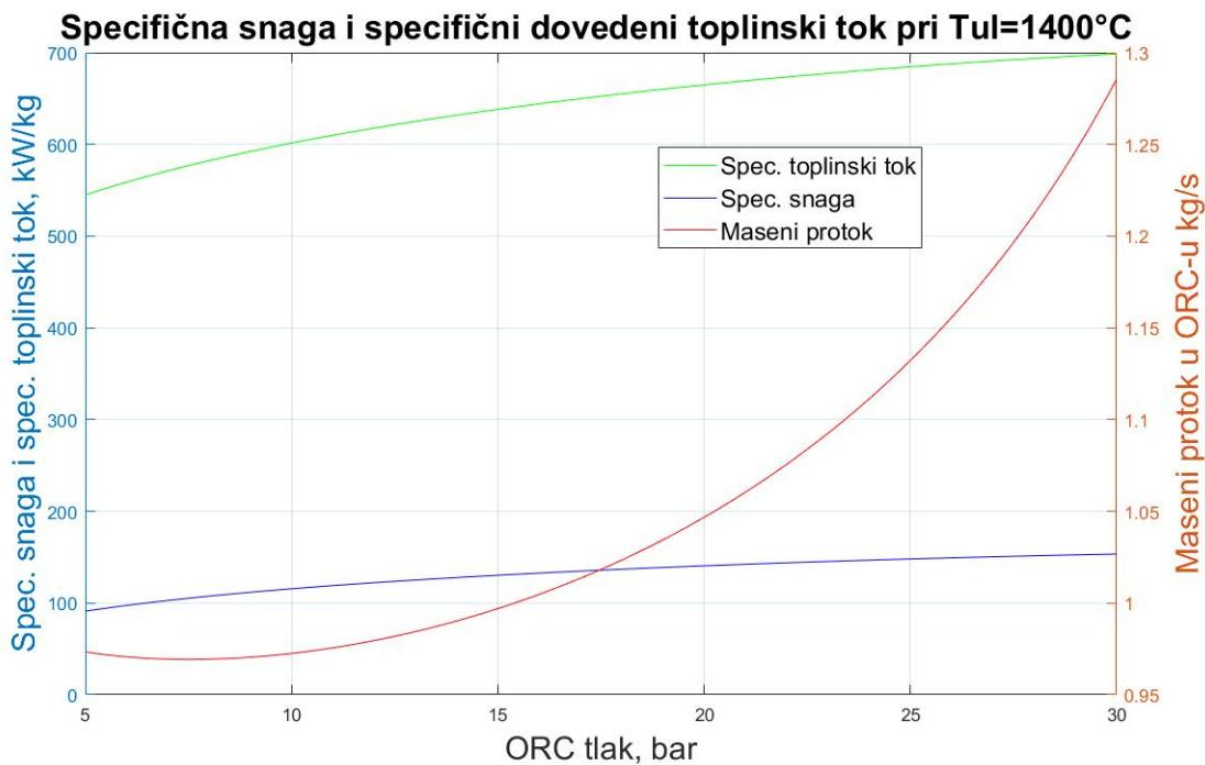
Slika 40. Ovisnost spec. snage, spec. toplinskog toka i masenog protoka o radnom tlaku u ORC-u (cikloheksan)
