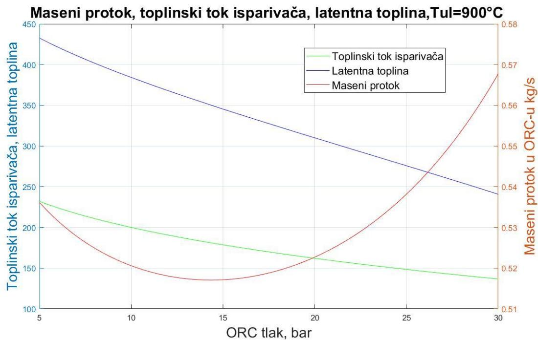
**Slika 26. Ovisnost masenog protoka, toplinskog toka isparivača i latentne topline o radnom tlaku ORC-a (aceton)**
