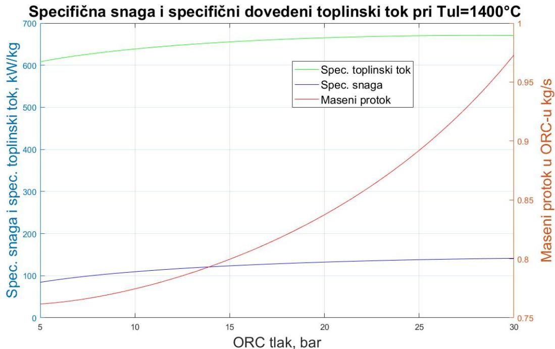
**Slika 29. Ovisnost spec. snage, spec. toplinskog toka i masenog protoka o radnom tlaku u ORC-u (aceton)**
