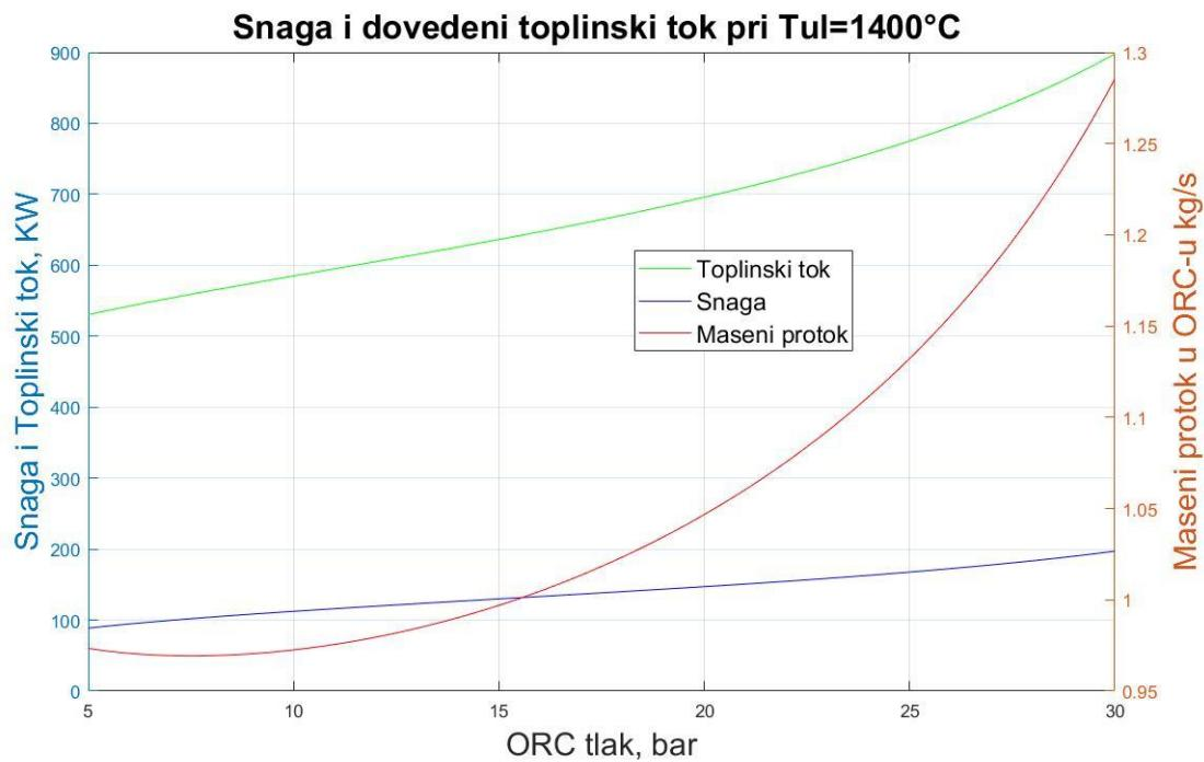
**Slika 39. Ovisnost snage, toplinskog toka i masenog protoka o radnom tlaku u ORC-u (cikloheksan)**
