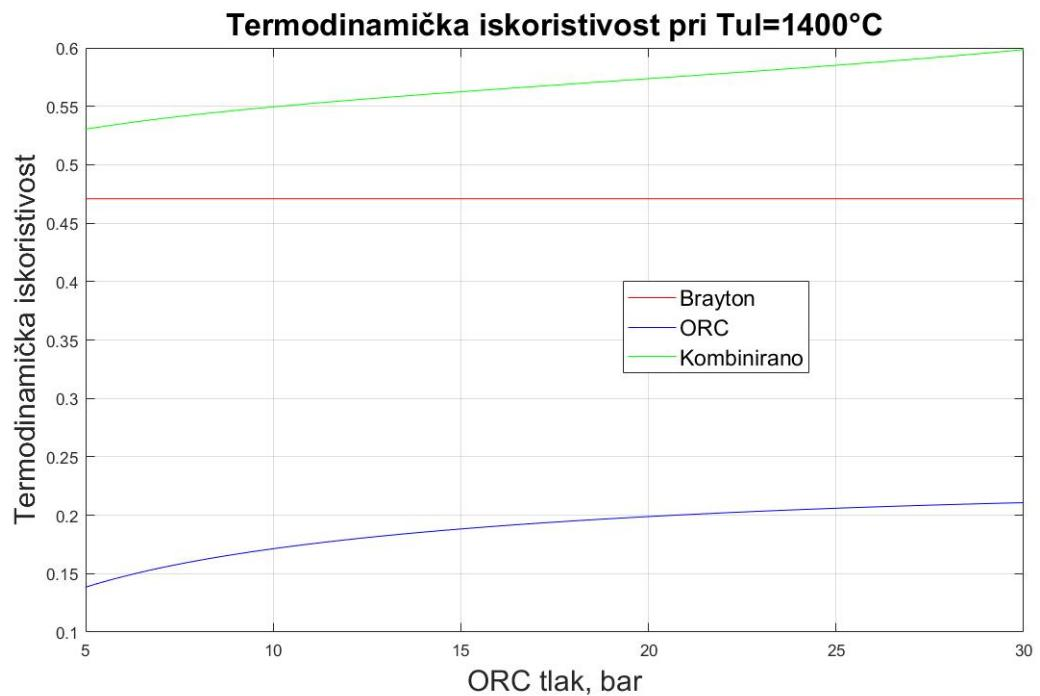
**Slika 27.** Ovisnost termodinamičkih iskoristivosti o radnom tlaku u ORC-u (aceton)
