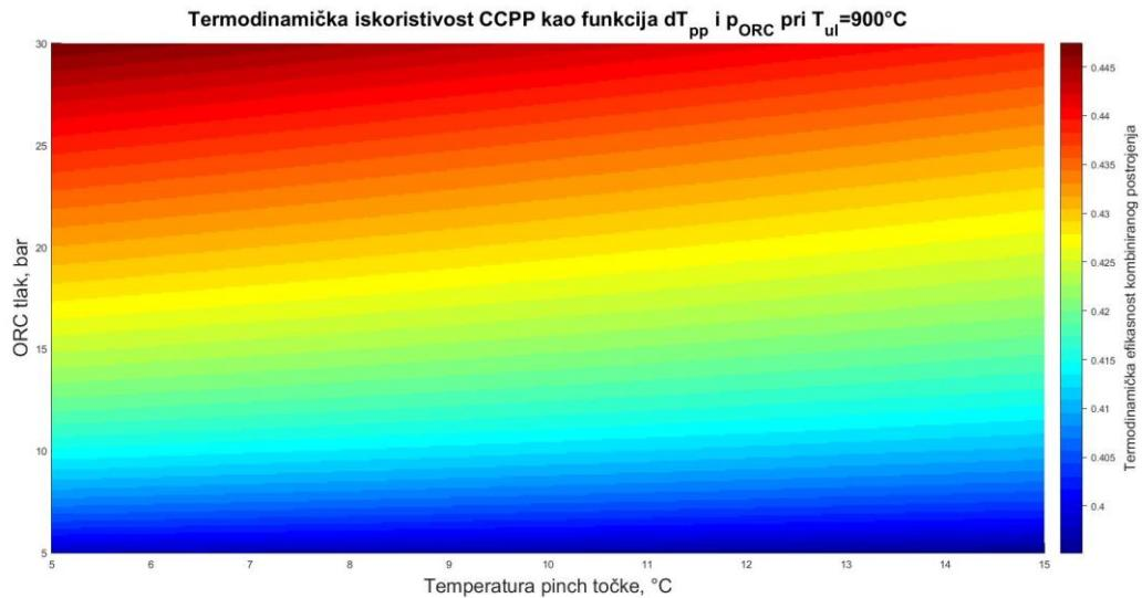
**Slika 32. Termodinamička iskoristivost kombiniranog postrojenja u ovisnosti o radnom tlaku ORC-a i temperaturi pinch točke u isparivaču (aceton)**
