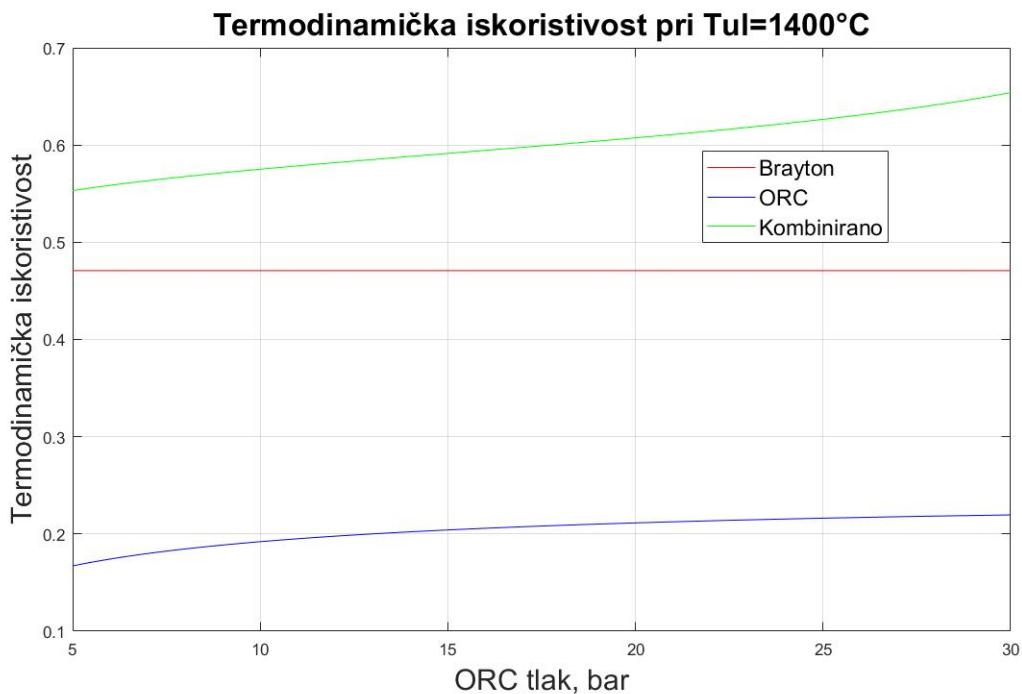
Slika 38. Ovisnost termodinamičkih iskoristivosti o radnom tlaku u ORC-u (cikloheksan)
