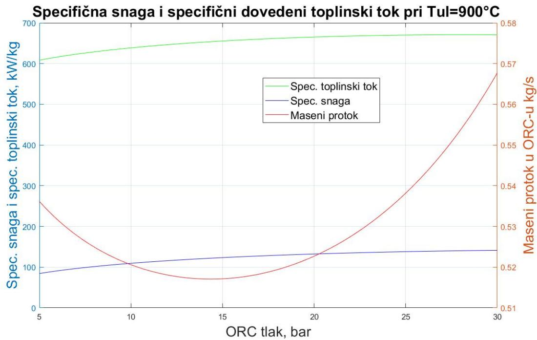
Slika 25. Ovisnost spec. snage, spec. toplinskog toka i masenog protoka o radnom tlaku u ORC-u (aceton)
