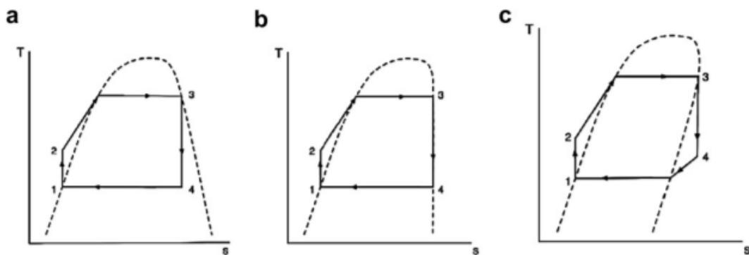
Slika 8. T-s dijagrami za mokre, izentropske i suhe tekućine [9]
