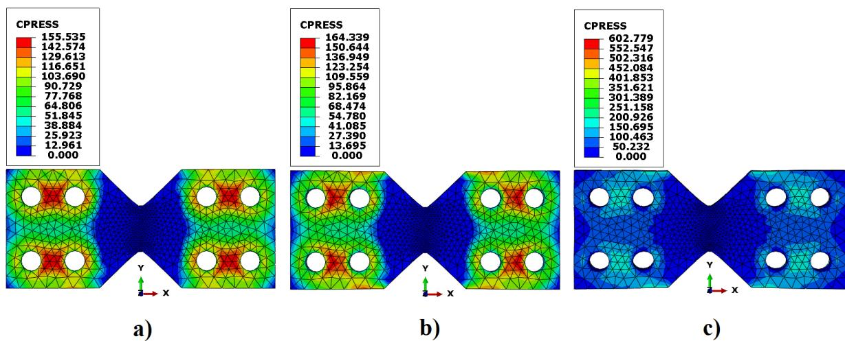
**Slika 7.9. Kontaktni pritisak pri deformaciji uzorka  $\approx 20 \%$ :**
