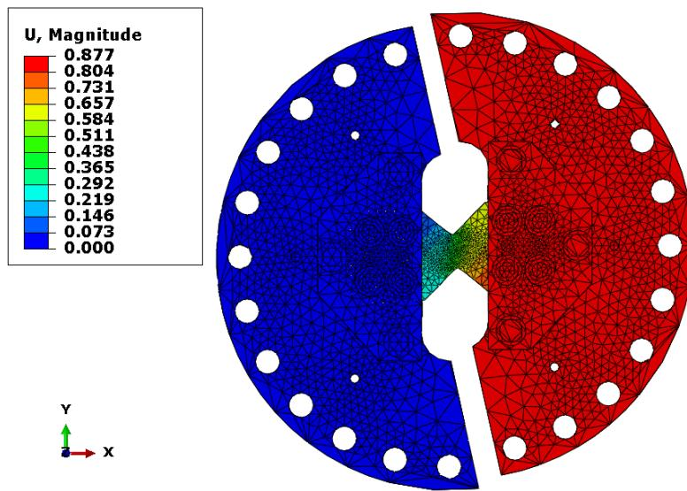
Slika 7.26. Prikaz pomaka prilikom kombiniranog opterećenja ( $45^\circ$ )
