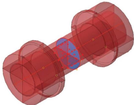
**Slika 7.3. Predzatezanje vijka s *bolt load* metodom [15]**
