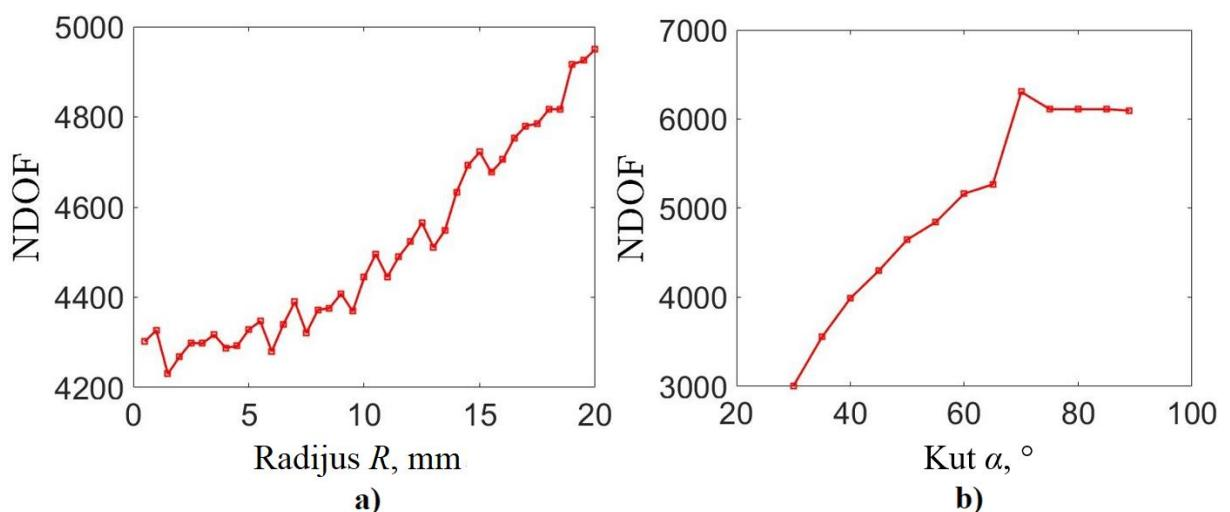
Slika 6. Prikaz promjene broja čvorova tijekom optimizacijskog procesa ovisno o promjeni:
