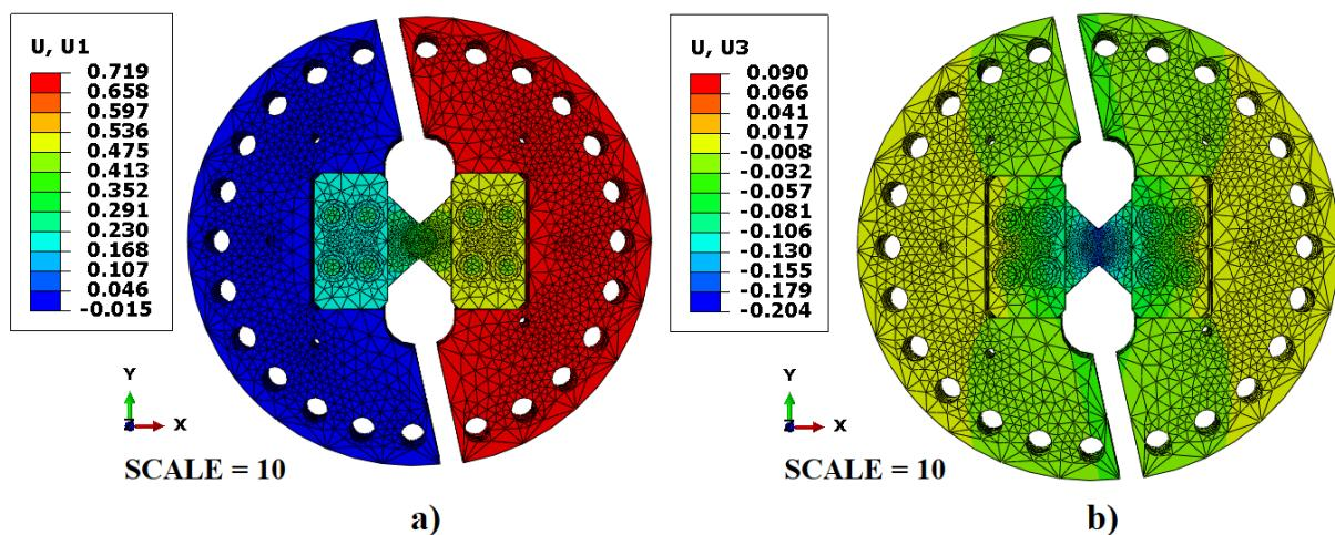
Slika 7.14. Prikaz raspodjele pomaka pri vlačnom ispitivanju sa zaticima do  $\approx 20\%$  deformacije uzorka: a) pomak u smjeru osi x ( $U_x$ ), b) pomak u smjeru osi z ( $U_z$ )
