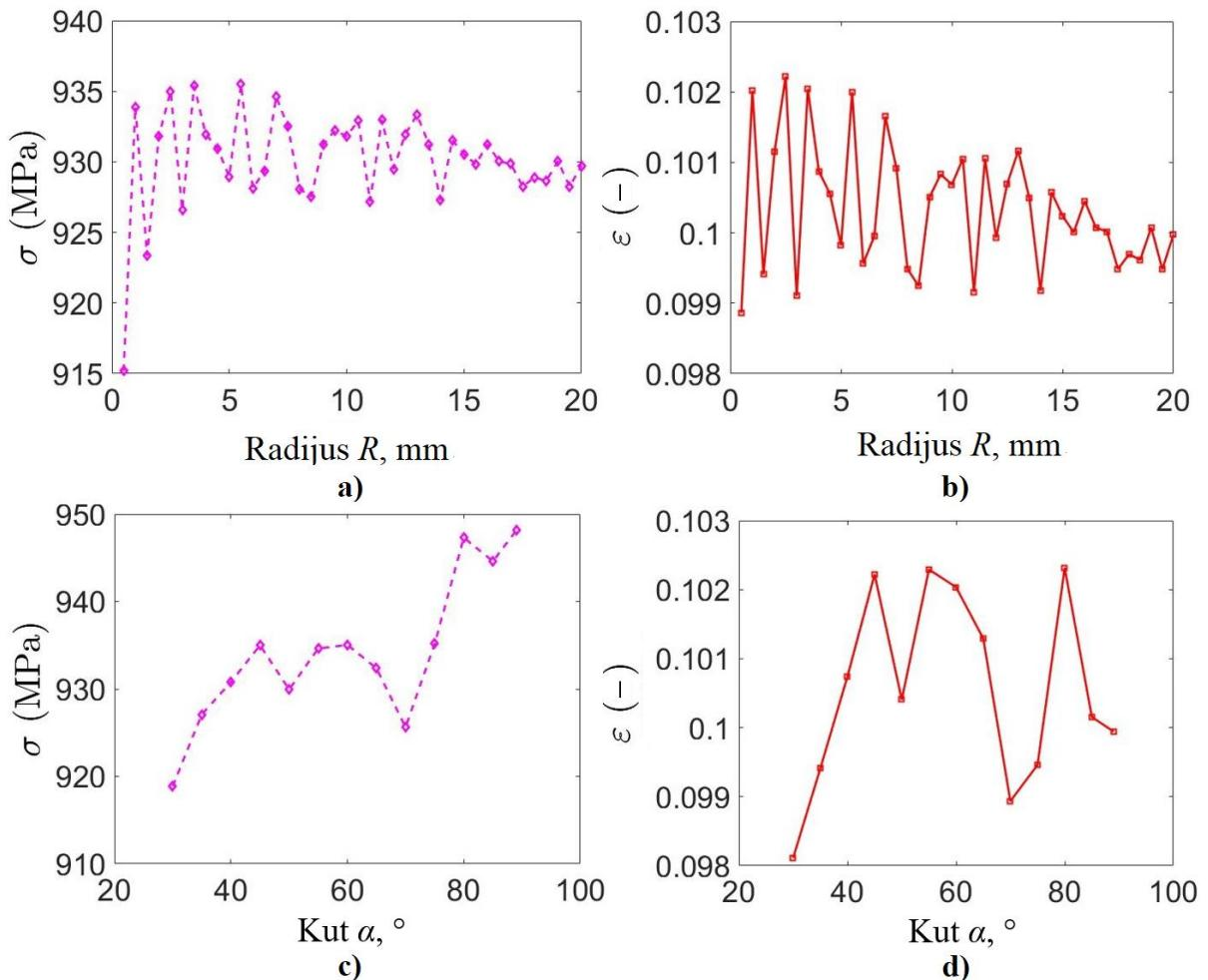
Slika 5. Prikaz maksimalnog naprezanja (a, c) i deformacije (b, d) kod kombiniranog opterećenja ( $45^\circ$ ) prilikom optimizacije ovisno o promjeni: radijusa  $R$  (a, b) ili kuta  $\alpha$  (c, d)
