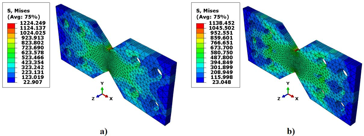
Slika 7.12. Prikaz raspodjele naprezanja prema von Mieseu pri deformaciji uzorka  $\approx 20\%$  i vlačnom ispitivanju: a) bez zatika, b) sa zaticima
