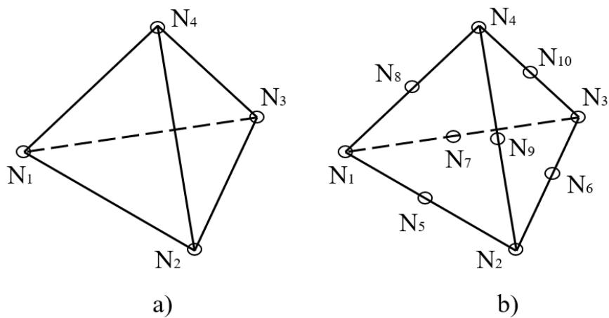
Slika 3.1. Tetraedarski konačni element: a) osnovni, b) parabolični
