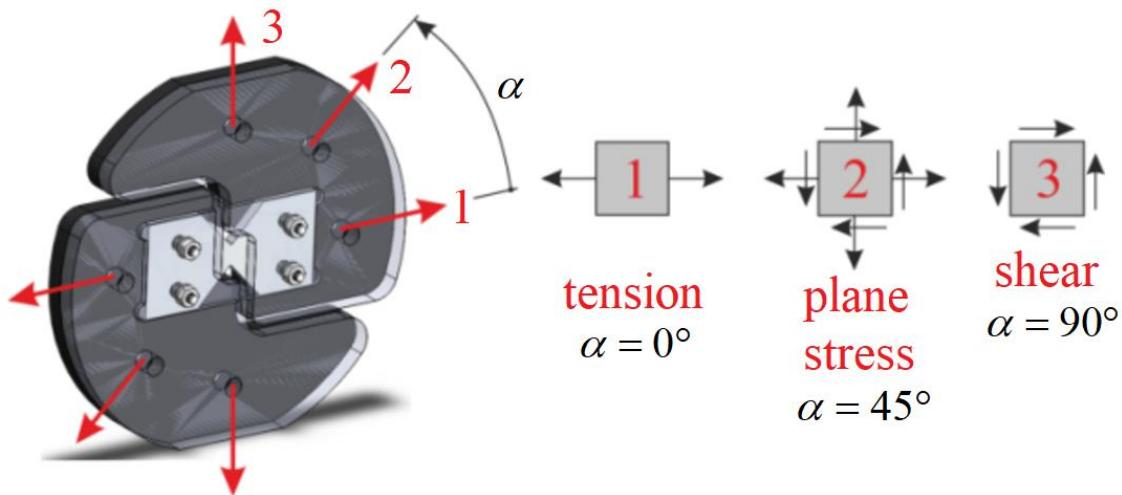
**Slika 1.3. Stanja naprezanja uslijed opterećenja u različitim smjerovima [14]**
