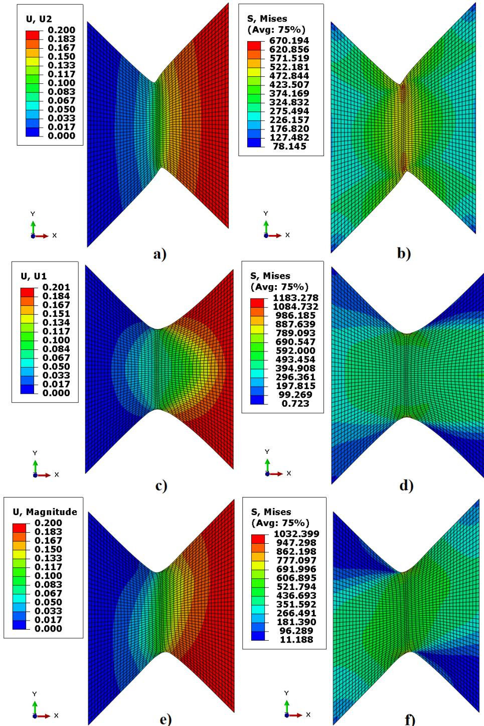
Slika 6.4. Prikaz karakterističnog pomaka i raspodjele naprezanja prema von Misesu za:
