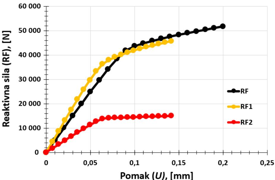
Slika 6.6. Dijagram sila-pomaka za kombinirano opterećenje ( $45^\circ$ )
