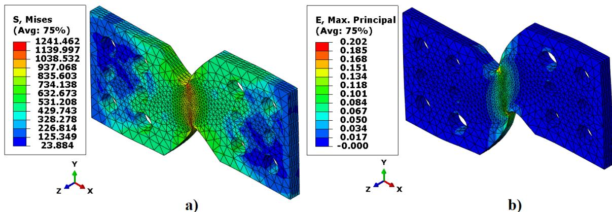
Slika 7.17. Prikaz: a) naprezanje prema von Misesu, b) deformacija
