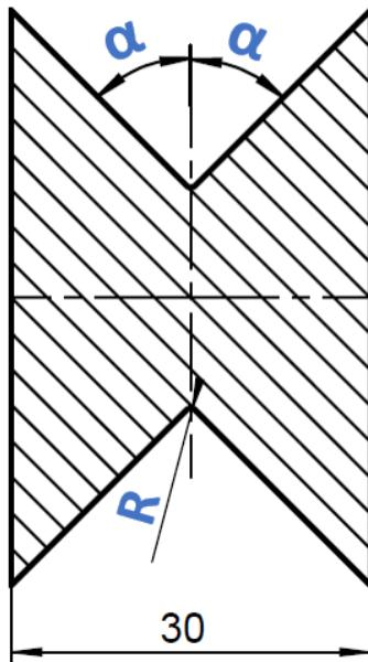
**Slika 2.3. Prikaz dimenzija ispitnog uzorka za optimizaciju**
