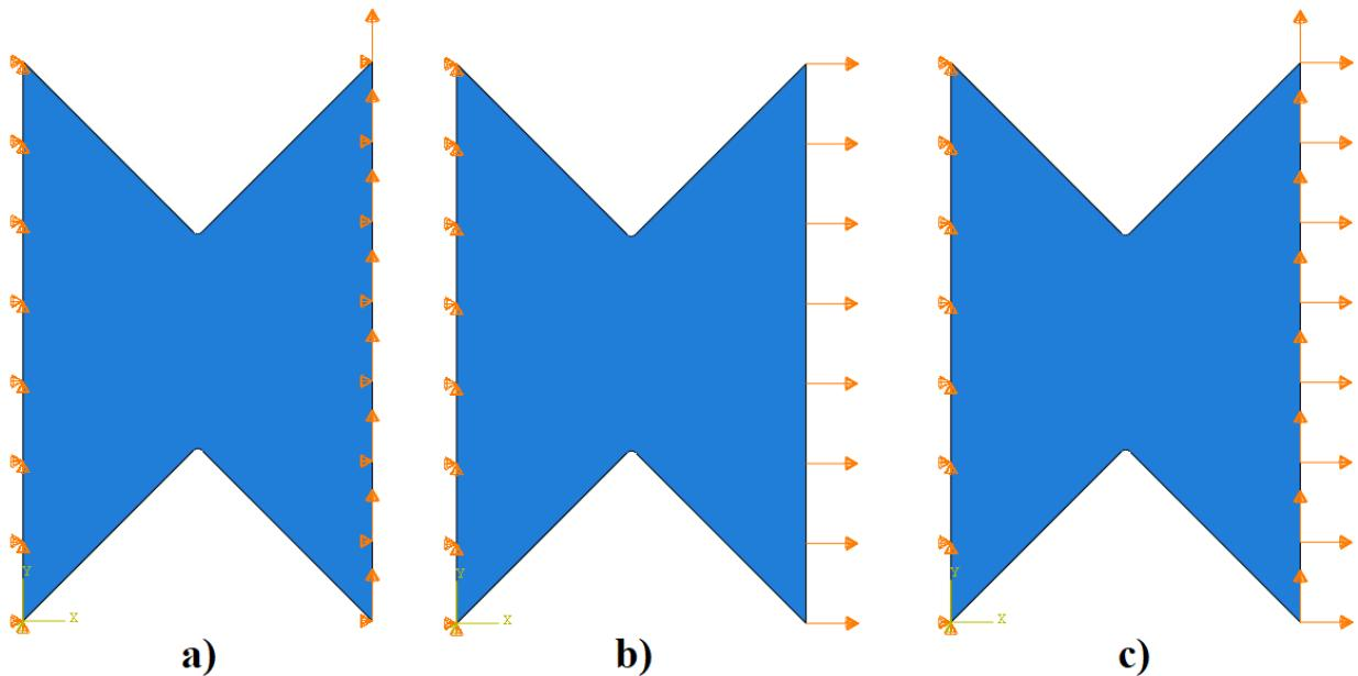
Slika 6.3. Rubni uvjeti i opterećenje idealiziranog modela leptirastog uzorka za: a) smično opterećenje, b) vlačno opterećenje, c) kombinacija smičnog i vlačnog opterećenja ( $45^\circ$ )
