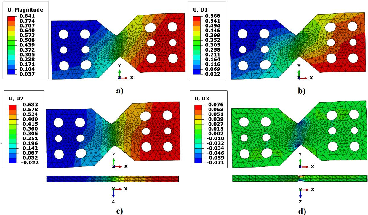
Slika 7.29. Raspodjela pomaka: a) ukupni pomak, b) pomak u smjeru osi x, c) pomak u smjeru osi y, d) pomak u smjeru osi z
