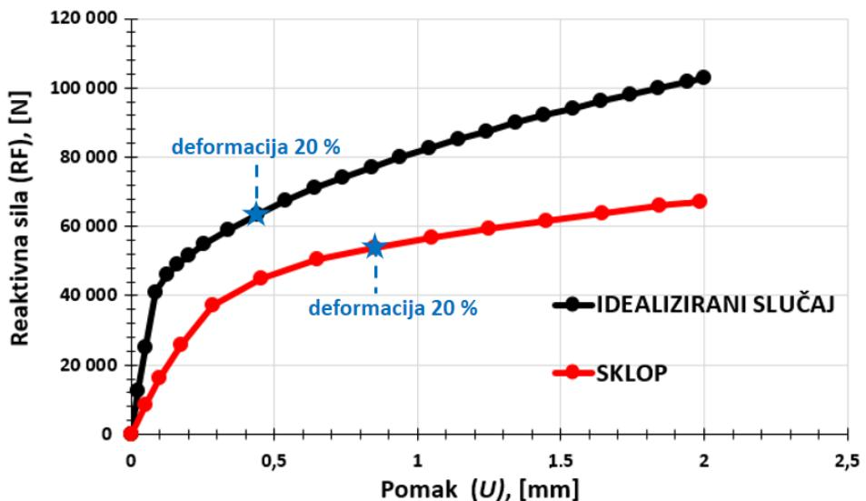
Slika 7.30. Dijagram sila-pomak za kombinirano opterećenje ( $45^\circ$ )
