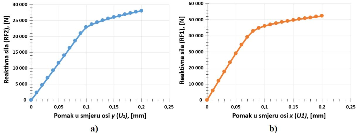
Slika 6.5. Dijagram sila-pomak za: a) smično opterećenje, b) vlačno opterećenje
