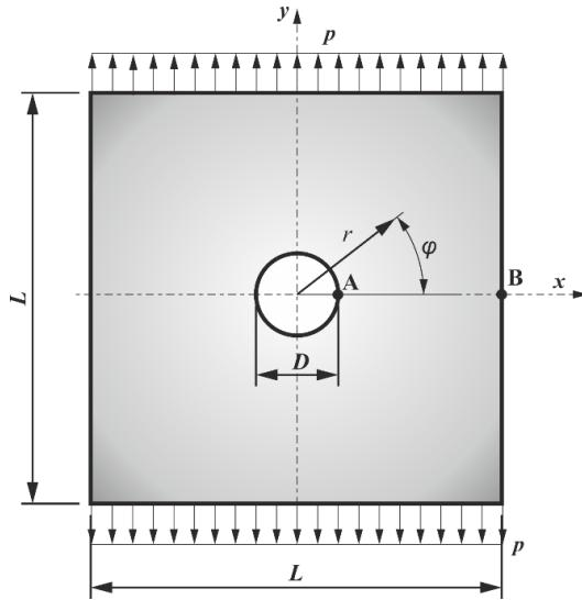
Slika 5.6. Membrana s otvorom opterećena na vjak
