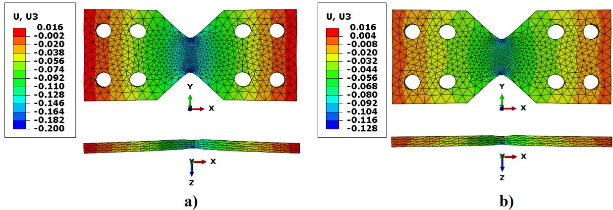
Slika 7.7. Savijanje leptirastog uzorka pri deformaciji  $\approx 20 \%$  ovisno o debljini prirubnice:
