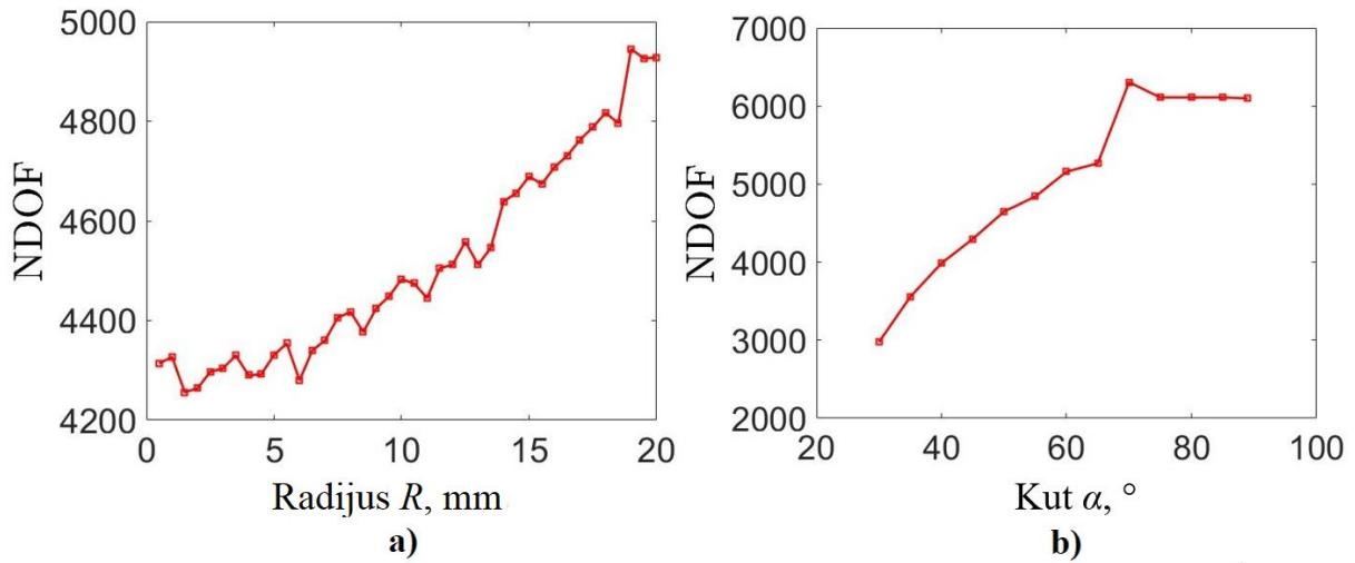
Slika 3. Prikaz promjene broja čvorova tijekom optimizacijskog procesa ovisno o promjeni:
