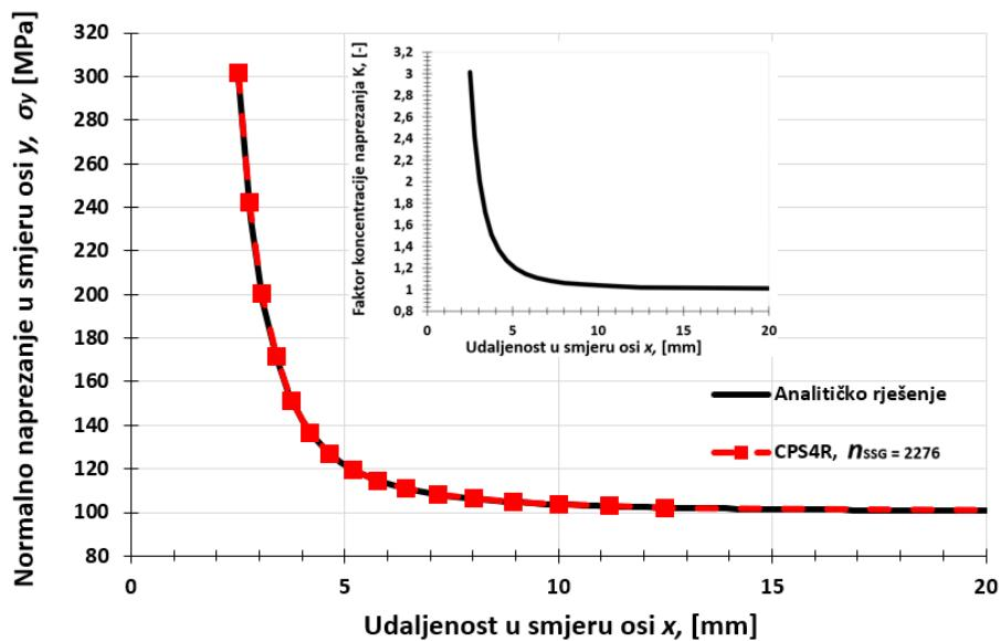
**Slika 5.8. Raspodjela normalnog naprezanja u smjeru osi y**
