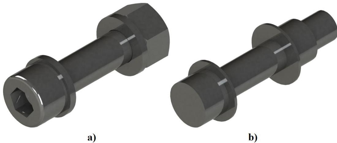
**Slika 7.1. Prikaz sklopa vijka: a) realni b) pojednostavljeni**
