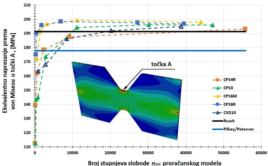
Slika 5.14. Konvergencija maksimalnog naprezanja uzorka (točka A)
